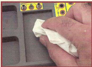
**1** O lugar onde se deve instalar a placa de inserção deve estar limpo. Pode ser limpo com um trapo seco; não se devem utilizar dissolventes que possam estragar o plástico, nem produtos de limpeza, pois alguns contêm silicones que impedem a colagem.
