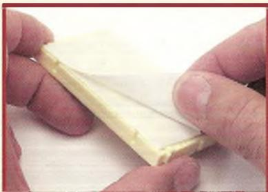
**2** A placa tem uma almofada auto-adesiva que facilita sua instalação no painel frontal do sistema de testes. A lâmina de proteção não deve ser retirada até o momento em que a tenhamos colocado; não devemos deixar a placa sem esta lâmina protetora por muito tempo, nem devemos apoiá-la sobre nenhuma superfície, embora seja brilhante.
