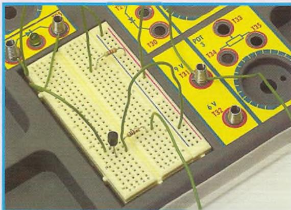
O transistor amplifica a corrente de base e o LED se ilumina.
