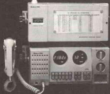
Il ricetrasmittitore LABES 200 a banda laterale unica è il risultato di studi durati alcuni anni per dare alla nautica da diporto e a tutte le imbarcazioni di medio tonnellaggio un apparato completo ed efficiente.
