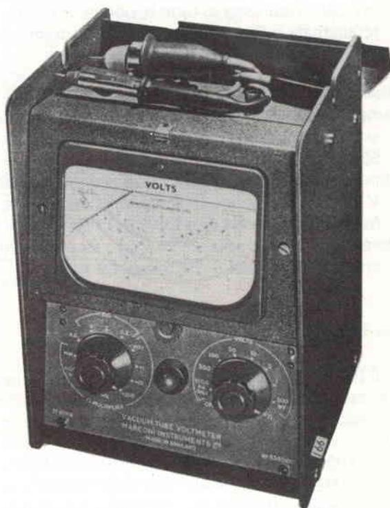
A causa della caratteristica offerta dallo speciale diodo contenuto nella sonda tuttavia, lo scarto fra i risultati offerti dai vari equipaggiamenti può variare attorno alla curva dei valori sopra citati di circa  $\pm 0,7$  dB a 500 MHz e di  $\pm 1$  dB a 1000 MHz.
