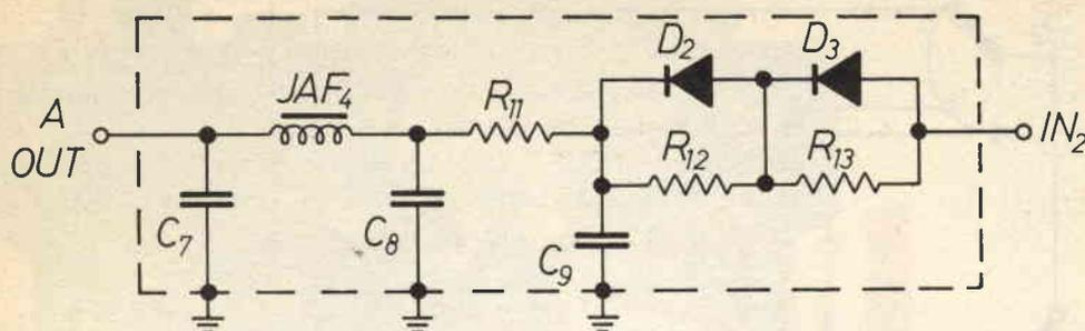
figura 2 - Schema elettrico della sonda 200 W.
