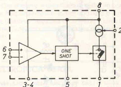
figura 1 - Composizione interna del  $\mu A4151$ .
