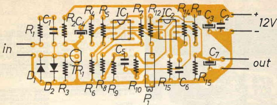
figura 3 - Schema pratico di montaggio del convertitore f/v.
