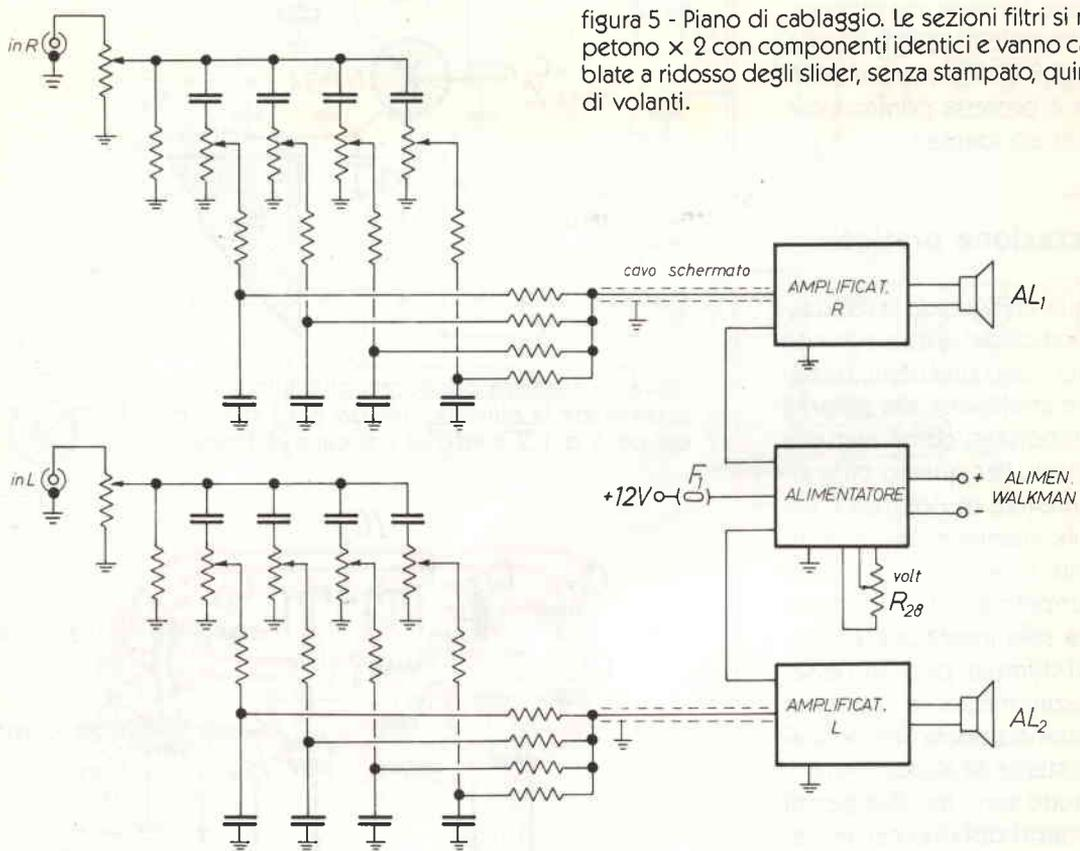
figura 5 - Piano di cablaggio. Le sezioni filtri si ripetono  $\times 2$  con componenti identici e vanno cablate a ridosso degli slider, senza stampato, quindi volanti.
