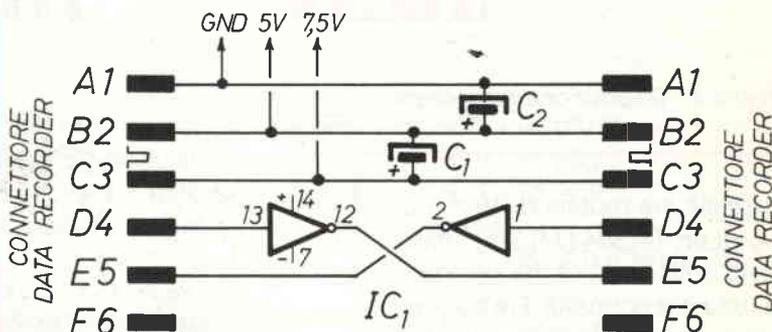
figura 1 - Schema elettrico.
