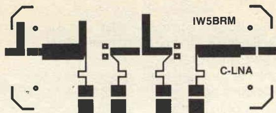
Ovviamente, alla frequenza di 4 GHz non è possibile utilizzare, come supporto per le microstrip, della comune vetronite, bensì occorre utilizzare appositi laminati a base di vetro e teflon a bassissima perdita e appositamente studiati per applicazioni a microonde.
