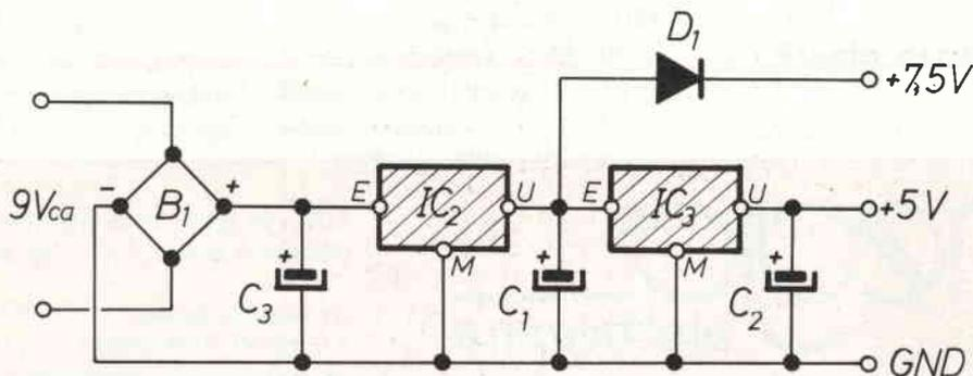
figura 2 - Schema alimentatore.
