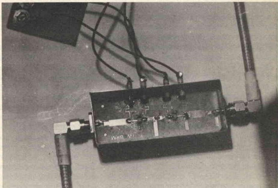
foto 1 - L'amplificatore montato nel contenitore e munito di connettori. Notare i due MESFET e i condensatori chip microminiatura.
