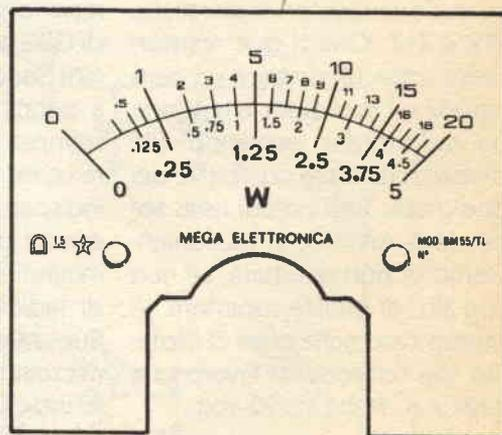
figura 4 - Scala tarata in W per M1 (dim. 60x70).
