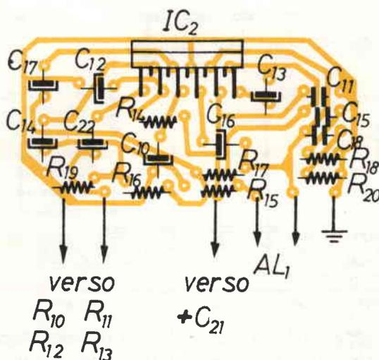
figura 3 - Disposizione componenti (1 solo canale).
