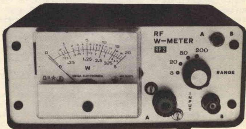
segnarne una su un microamperometro normale. Ovviamente è preferibile la prima soluzione, che è quella che garantisce la migliore precisione. Del resto, a parità di marca, qualità e classe di precisione, un microamperometro con la scala tarata in watt costa quanto uno con la normale scala lineare.
