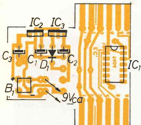
figura 3 - Disposizione componenti.
