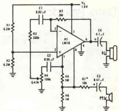
Amplificatore microfonico funzionante a 1,5V
