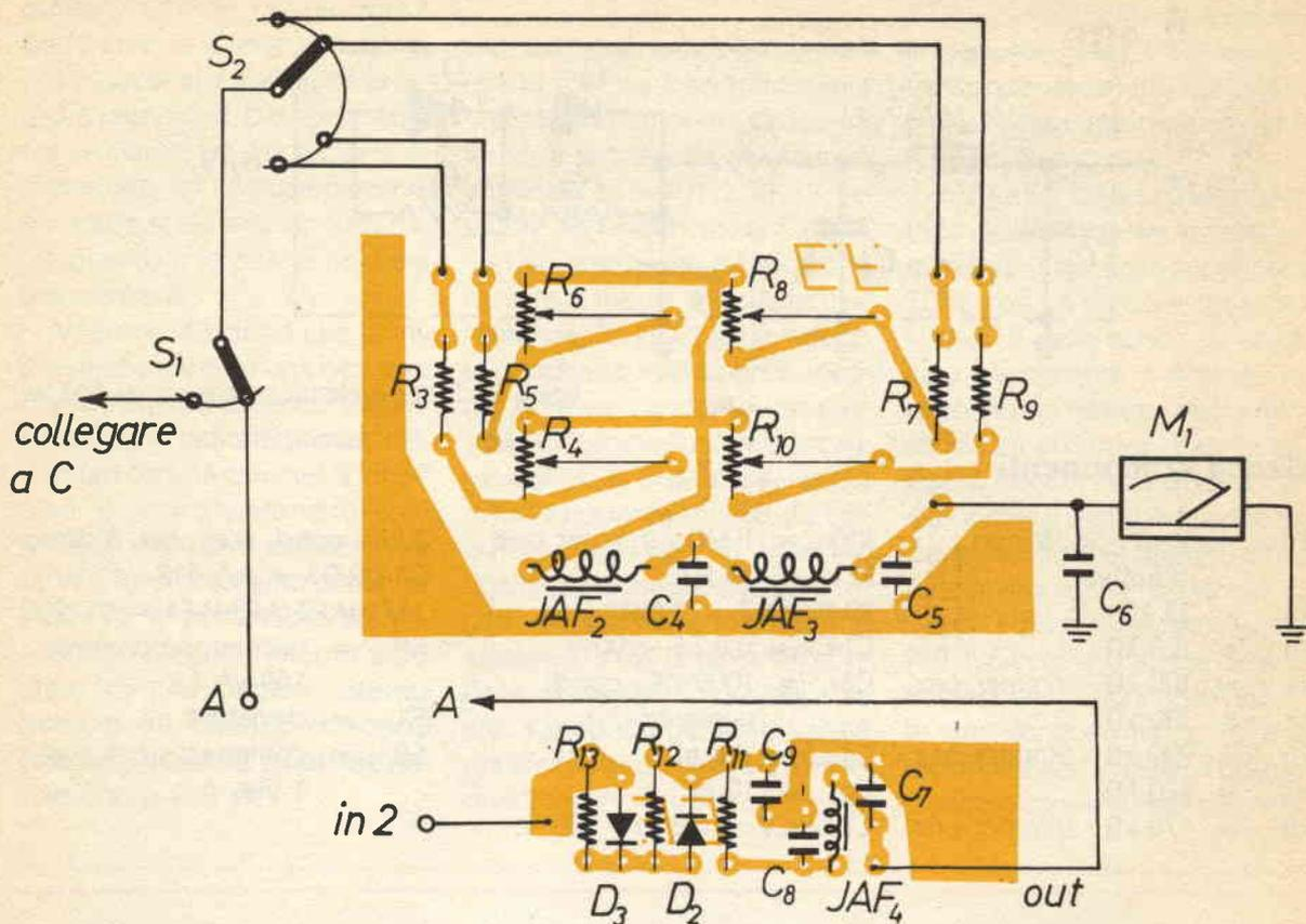
figura 3 - Disposizione componenti.
