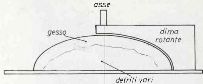
Preparazione di uno stampo in gesso. NB: Carreggiare e verniciare con smalto prima di stendere la cera e iniziare la stratificazione.
