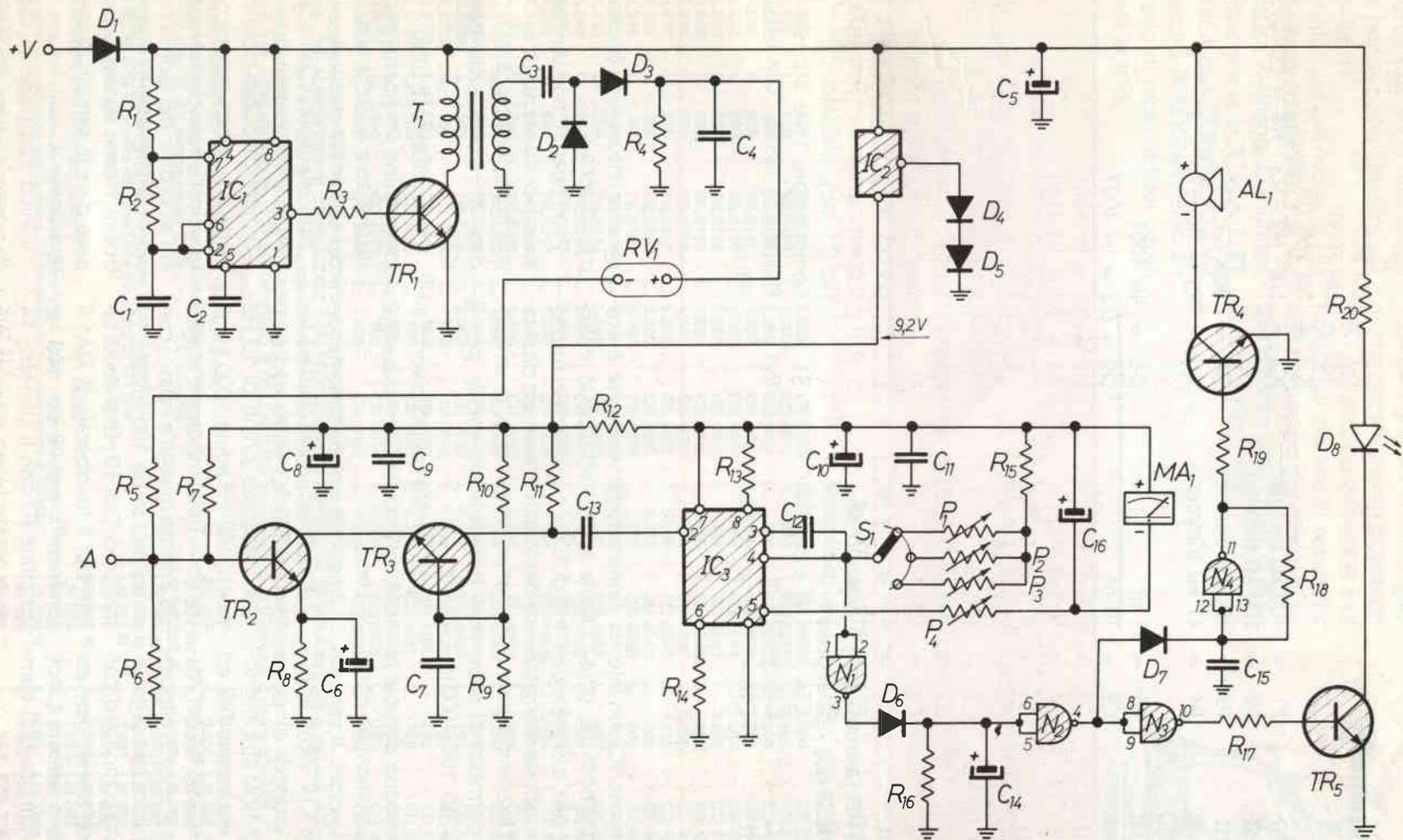
figura 1 - Schema elettrico del contatore di radioattività.
