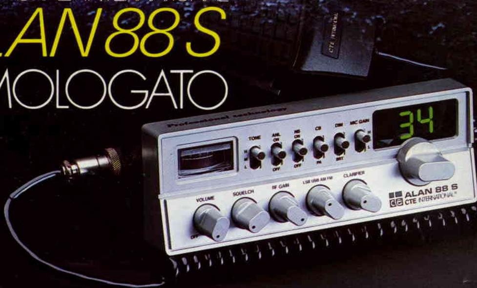
**CARATTERISTICHE TECNICHE:** Canali: 34 - Gamma di frequenza: 26,865 ÷ 27,265 MHz - Tensione d'alimentazione: 12,6 Vcc (11,3 ÷ 13,8 Vcc).
