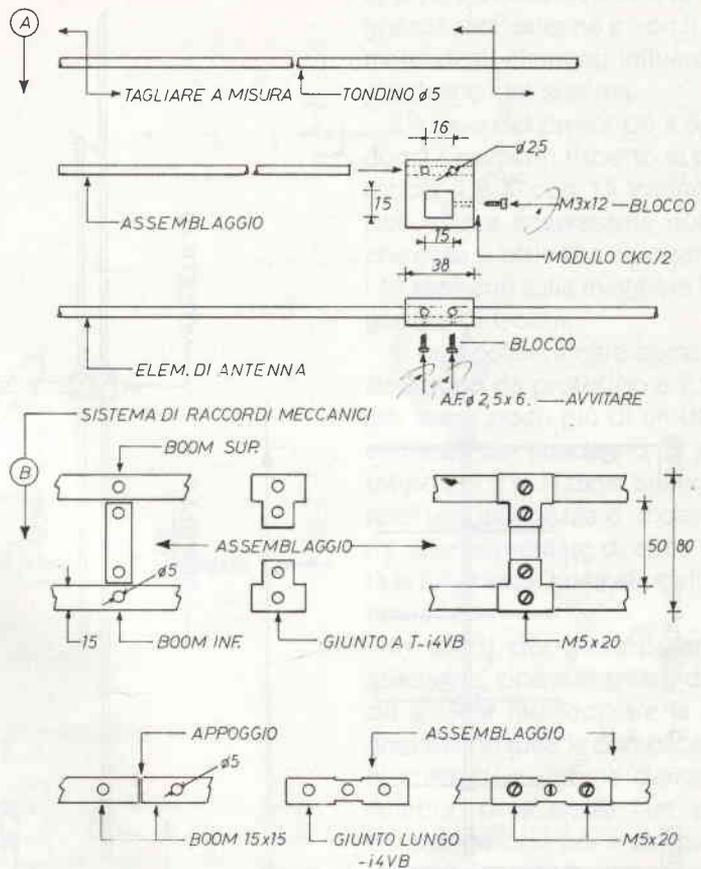
figura 5 - Assemblaggio BOOMS.
