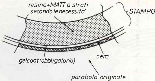
so si stia realizzando una parabola e non uno stampo fermo restando che se si dà uno strato di gelcoat sulla parabola prima di incominciare a stratificarvi la resina si ottiene un oggetto molto più professionale e bello esteticamente anche se di costo superiore.
