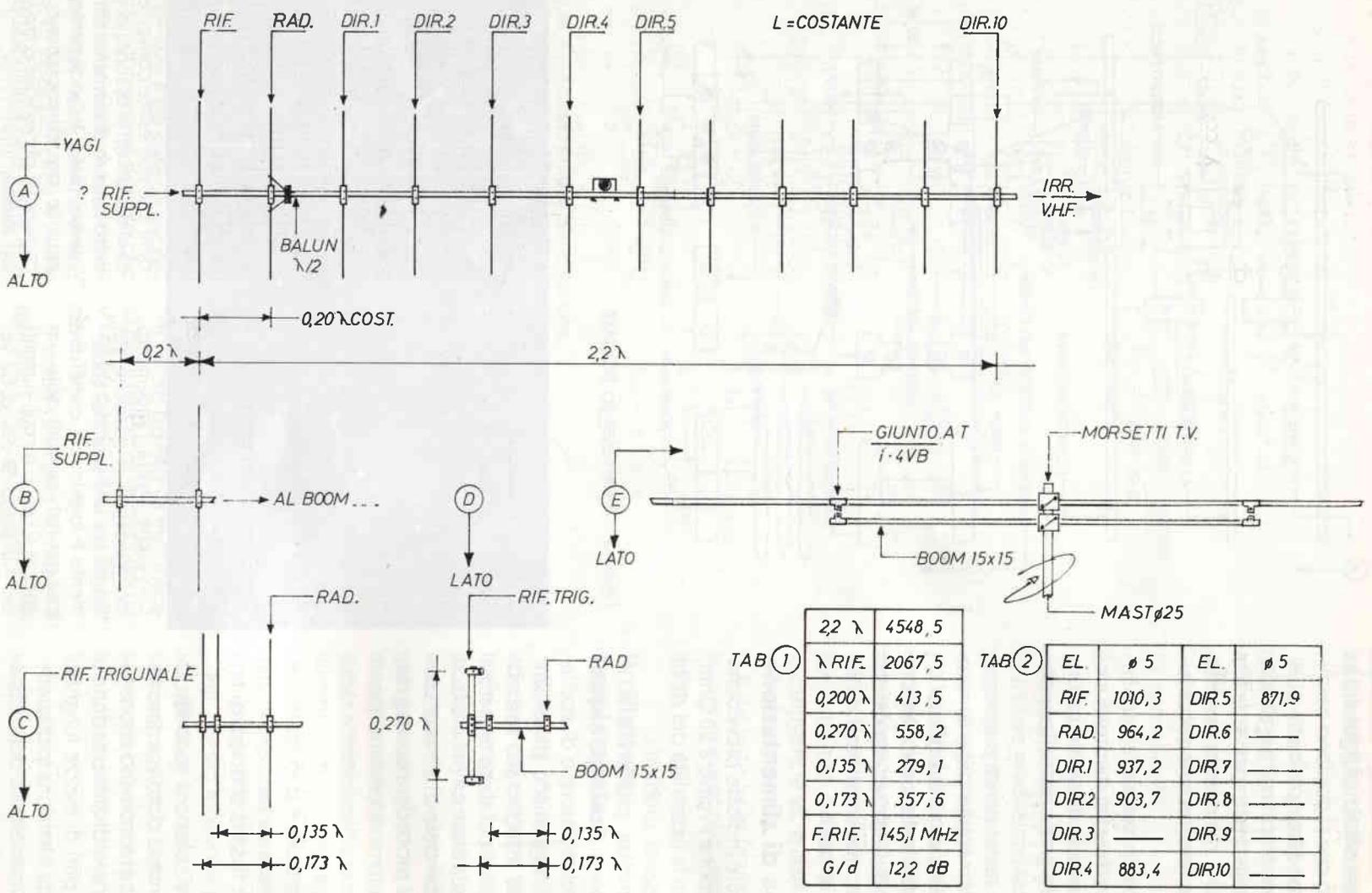
figura 6 - 12 elementi Yagi 144-146 MHz.
