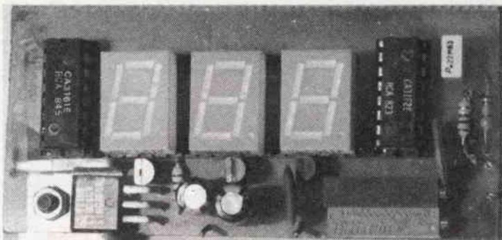
Per quanto riguarda il montaggio, le avvertenze sono le stesse consigliate per il voltmetro. Nell'amperometro resterà acceso il punto decimale del primo display e la lettura è in ampere, con la definizione di 10 milliampere.
