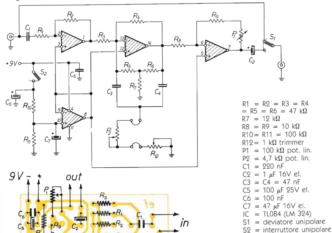
figura 4 - Disposizione componenti.
