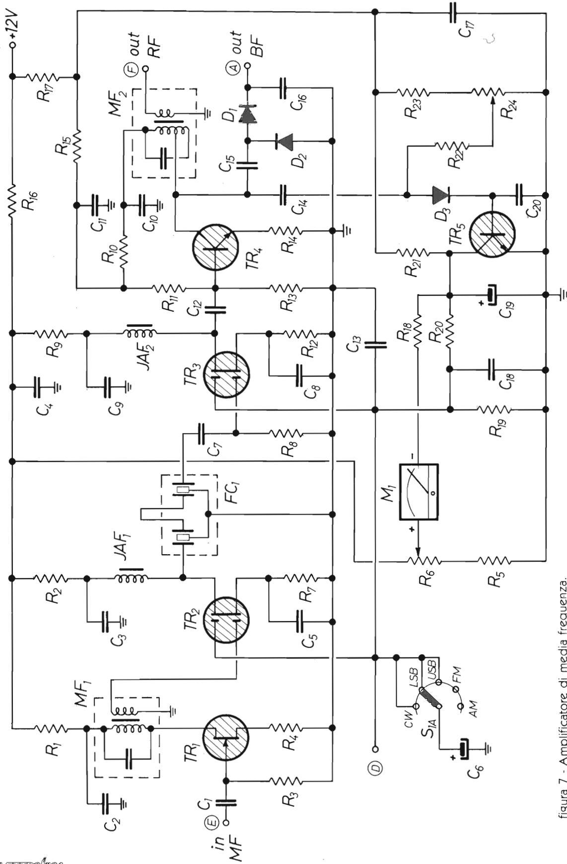
figura 7 - Amplificatore di media frequenza.
