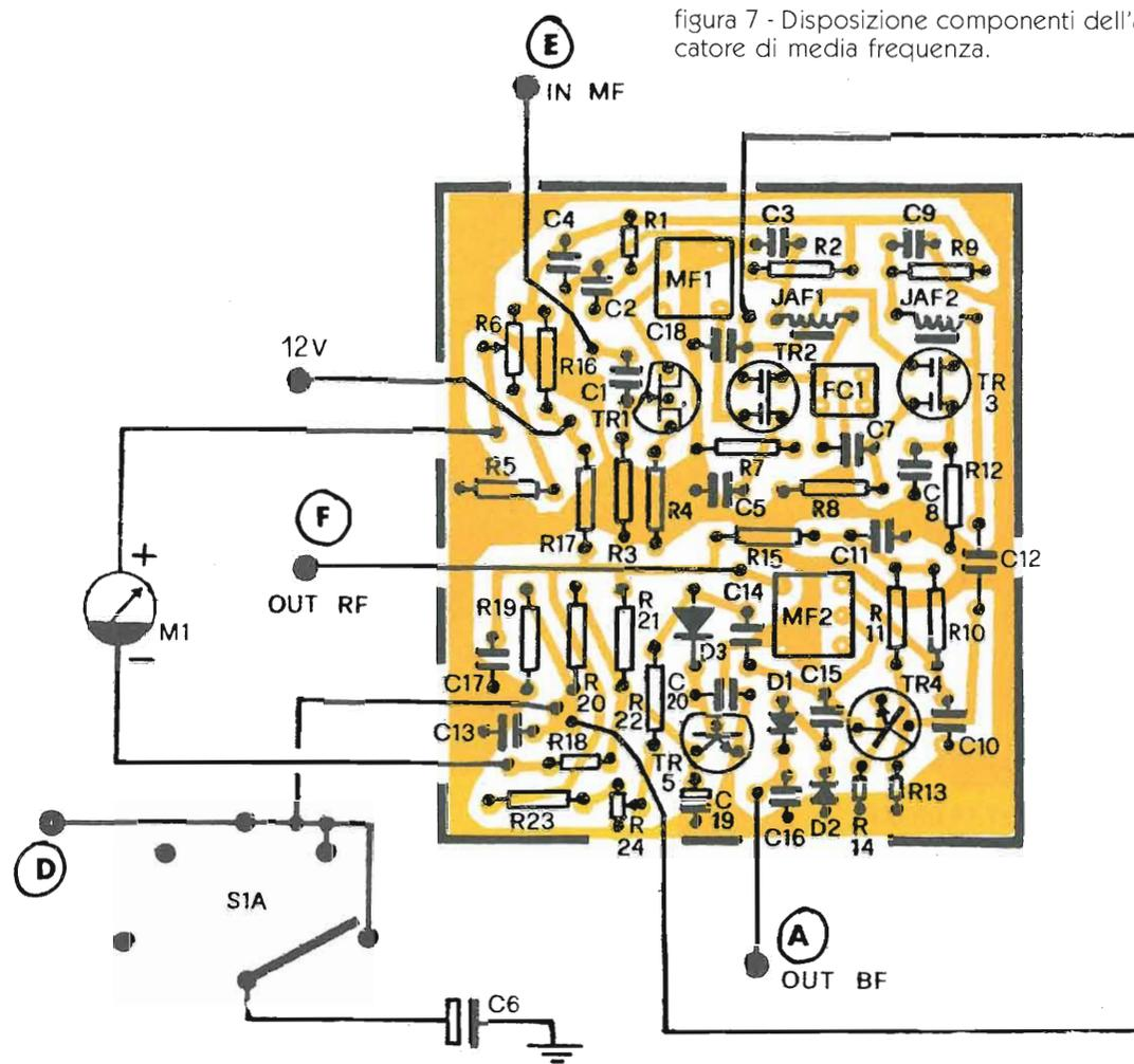
figura 7 - Disposizione componenti dell'amplificatore di media frequenza.
