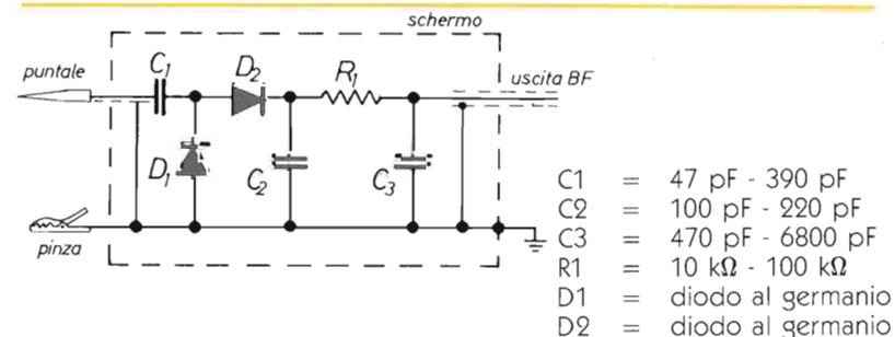
figura 1 - Schema elettrico della sonda «generica».
