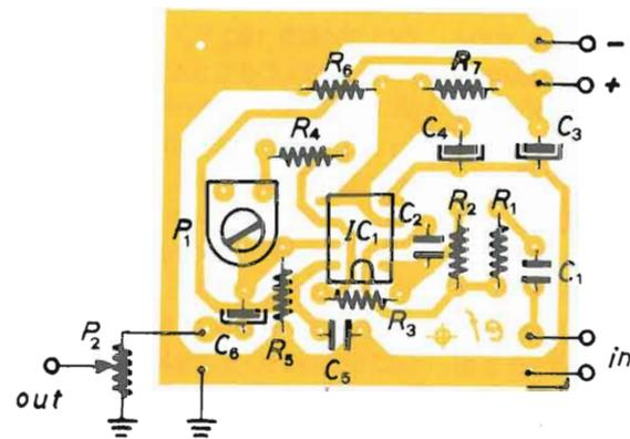
figura 6 - Disposizione componenti.
