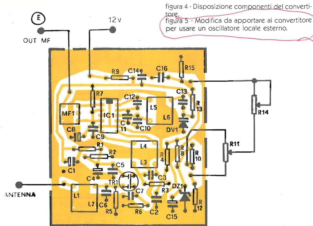
figura 4 - Disposizione componenti del convertitore.
