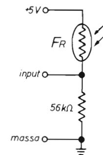
figura 1 - Schema elettrico.
