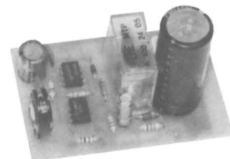
Circuito elettronico che, a seconda della sonda impiegata, e variando solo i valori di alcuni componenti, può fungere da innaffiatore automatico, termostato elettronico e interruttore crepuscolare.
