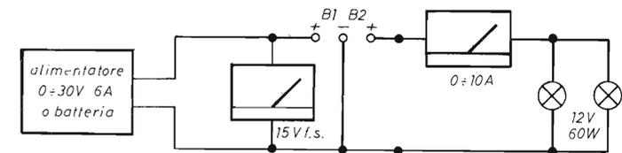
figura 4 - Circuito di taratura.
