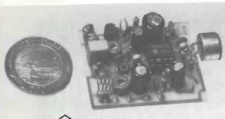
**MK 590 MICROSCOPIA PROFESSIONALE QUARZATA AM 150 MHz** Il primo vero microtrasmettitore con caratteristiche professionali. Può essere usato in tutte le situazioni senza pericolo di sbandamento in frequenza, tipico di tutti i microtrasmettitori ad oscillatore libero.
