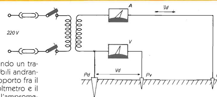
figura 5 - Esempio di misura utilizzando un trasformatore da 50÷100W circa. I fusibili andranno rapportati a detta potenza. Il rapporto fra il valore, espresso in volt, letto sul voltmetro e il valore, espresso in Amper, letto sull'amperometro, indica il valore della resistenza di terra presentata dal picchetto Pd.
