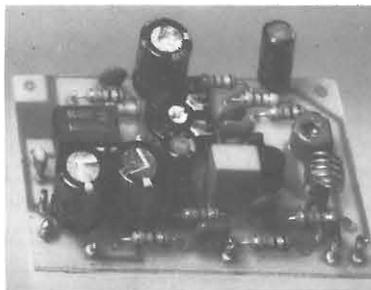
**MK 680 MICRORICEVITORE AM 150 MHz PER MK 590** Microricevitore dalle dimensioni estremamente ridotte con ottime caratteristiche (sens > 1,5 uV per 12 dB sinad) espressamente studiato per essere usato in coppia con l'MK 590 kit completo di contenitore ed auricolare. Tale ricevitore spazia tutta la banda compresa fra 100 e 180 MHz per cui è possibile l'ascolto delle conversazioni aeronautiche, pontiradio, ecc.
