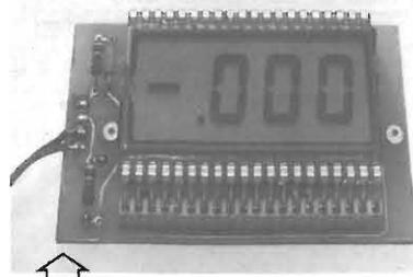
**MK 595 VOLTMETRO DIGITALE 31/2 LCD** da 200 mV a 200 V con autozero, indicazione del fuoriscalda e di tensione negativa in ingresso. Dimensioni 70 x 40 mm.
