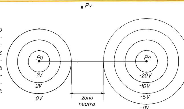
figura 4 - Linee equipotenziali relative al picchetto ausiliario e dispersore. Se questi vengono sistemati a sufficiente distanza, esiste un'area intermedia, non influenzata dai loro potenziali, cui fare riferimento con la sonda di tensione Pv. Comunque, per maggiore sicurezza, è bene sistemarla spostandosi dalla retta congiungente i due picchetti, cioè in configurazione a triangolo, aumentando così la disponibilità di area neutra come dimostrato dal disegno.
