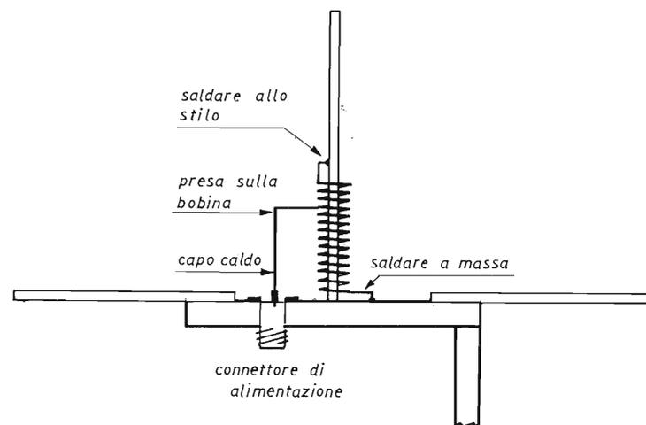
figura 4 - Montaggio bobina.
