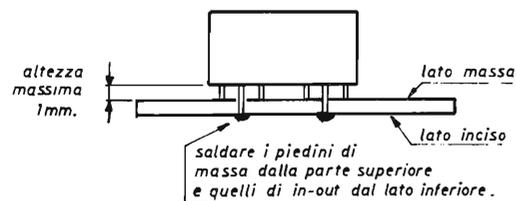
figura 5 - Assemblaggio del filtro.
