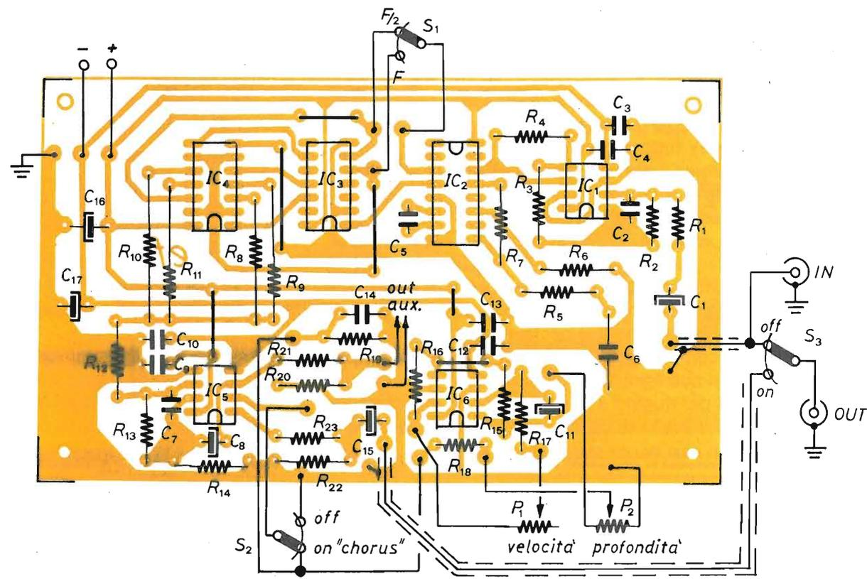
figura 3 - Disposizione componenti e collegamenti esterni del simulatore effetto «Chorus».
