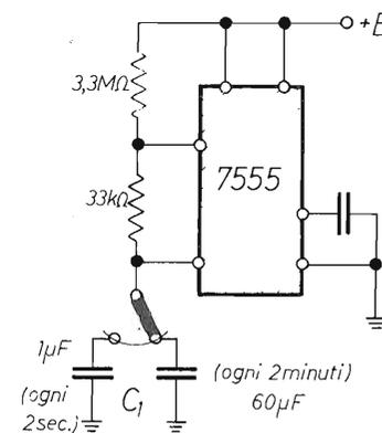
figura 3 - Particolare della commutazione del clock, che può sostituire quello proposto a schema (v. anche il testo per C1).
