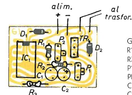
figura 2 - Disposizione componenti
