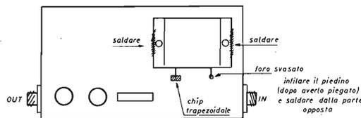
figura 6 - Assemblaggio dell'oscillatore.
