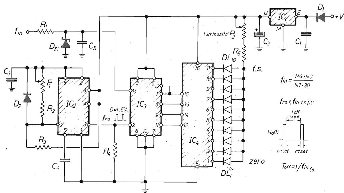
figura 1 - Schema elettrico contagiri auto multiplex.
