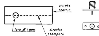
Regolare l'altezza del circuito stampato nella scatola in modo che il perno centrale del connettore si trovi centrato nel foro.
