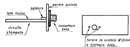
Forare la scatola  $\varnothing 1,5$ , filettare 2xMA e avvitare con viti in ottone 2x4 mm
