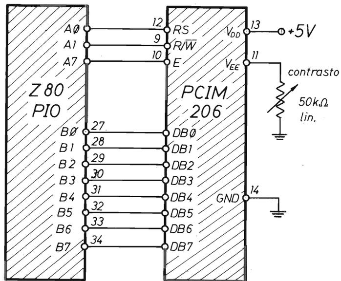
figura 3 - Schema di collegamento tramite PIO.
