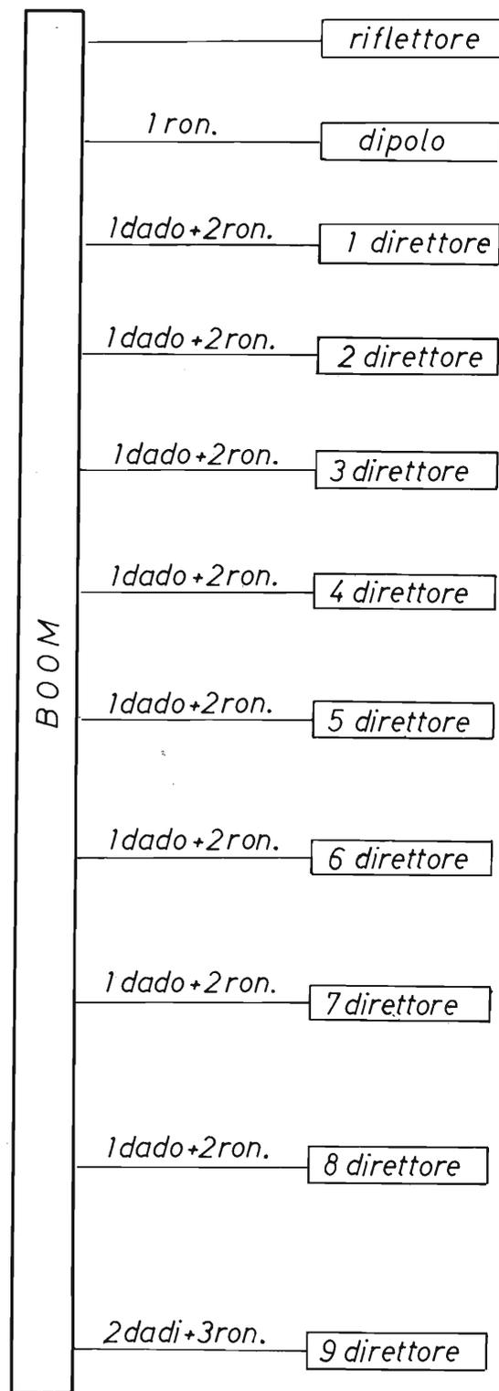
figura 3 - Sistemazione delle rondelle e dei dadi utilizzati come distanziatori.
