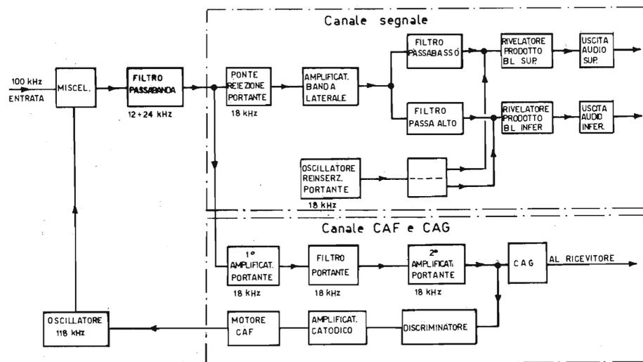
FIG. 1 - ADATTATORE RA 98 - Stenogramma
