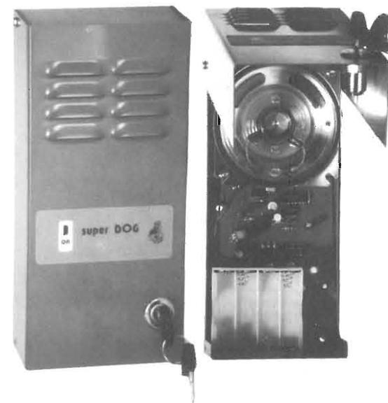
L'assorbimento di SUPER DOG durante il funzionamento è di circa  $1,5 \mu\text{A}$  dovuto ad una resistenza da  $8,2 \text{ M}\Omega$  (R11), peraltro non eliminabile.
