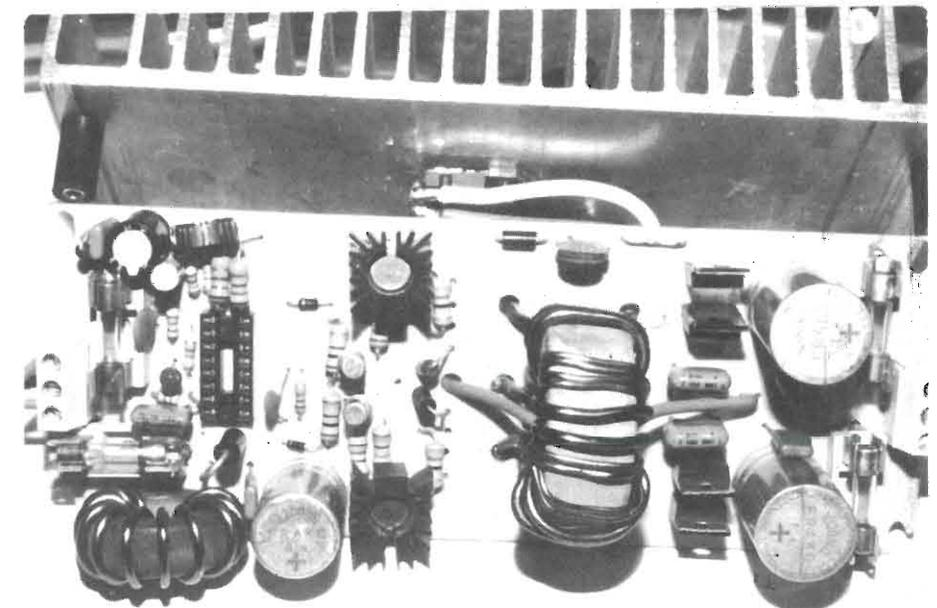
darlington avrebbe avuto problemi seri di spegnimento e velocità di commutazione. Sfruttando i collettori e gli emittori dei due transistor pilotati inseriti nell'IC (sfasati di 180°) si sono ottenute due doppie uscite sfasate tra loro.
