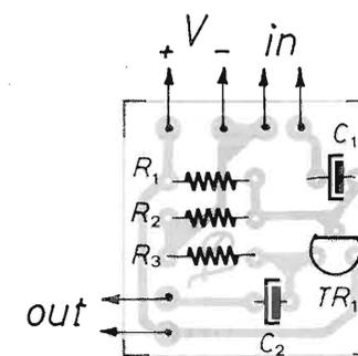
figura 7 - Disposizione componenti stadio inseguitore.
