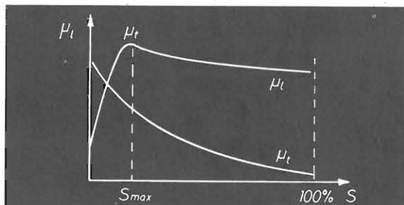
dove  $\mu_t$  e  $\mu_l$  sono rispettivamente il coefficiente di aderenza trasversale e longitudinale del pneumatico.
