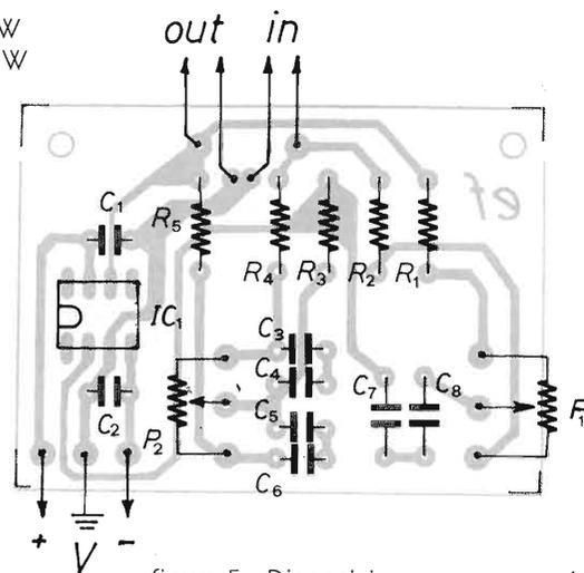
figura 5 - Disposizione componenti stadio controllo alti e bassi.
