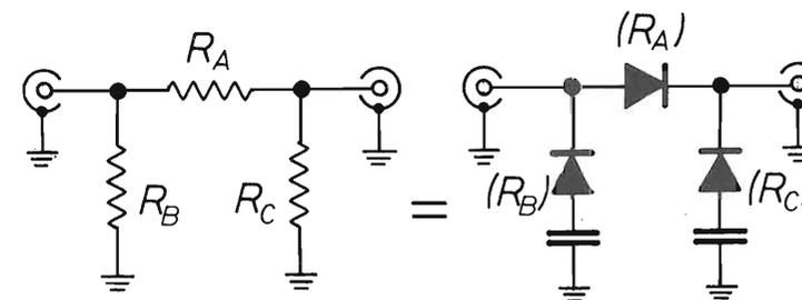
figura 3 - Schema di principio di attenuatore a π.
