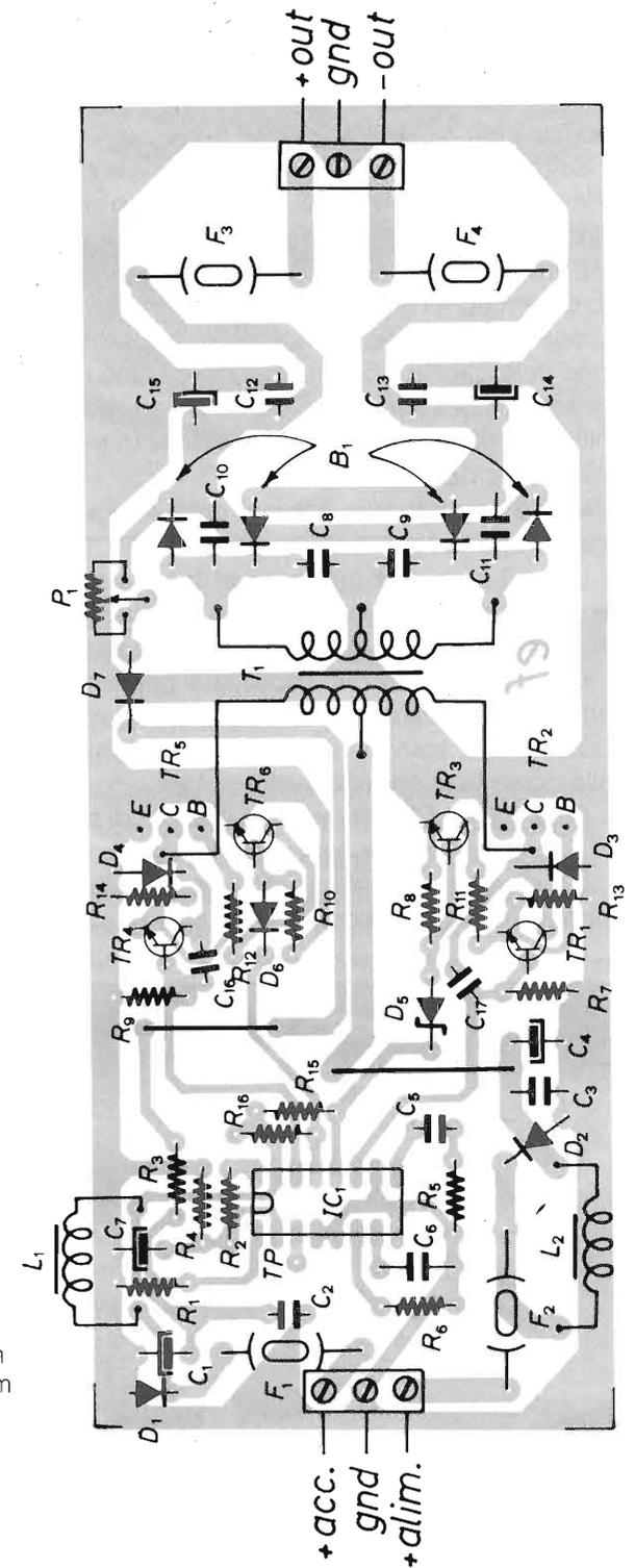
Sul secondario di T1 si avrà tensione maggiore, raddrizzata e filtrata dal ponte e condensatori. La rete di reazione D7, R3, P1, R1 manderà parte di tensione positiva in uscita al comparatore e, se si supererà il livello di tensione prefissato da P1 (V. out), si spegnerà l'oscillatore dell'integrato, stabilizzando in tal modo la V. out.
