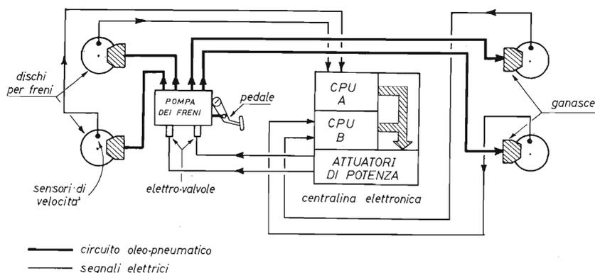
Nella centralina sono presenti due microprocessori che elaborano i segnali provenienti dalle ruote anteriori e posteriori rispettivamente. Vengono quindi calcolate le differenze di velocità tra ogni ruota e il veicolo stesso ricavando così l'indicazione di quanto la singola ruota sta scivolando.
