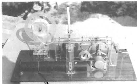
Nel retro della macchinetta notiamo subito in primo piano, il tubo portabatterie, a destra vediamo il motorino con due pulegge e cinghie per la riduzione del numero di giri, al centro in direzione della penna c'è l'elettromagnete anche lui autocostruito.
