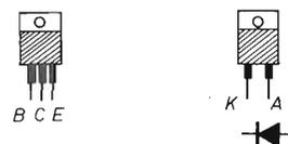
figura 3 - Piedinatura transistor BDX54 e diodo BYW29 (BYW80).
