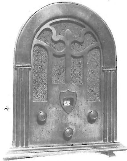
radio «a chiesetta» per la particolare forma del mobile, tipica degli anni '30. Esiste un modello precedente, l'M3, caratterizzato da un mobile più sobrio, dall'impiego di un altoparlante elettromagnetico a due poli, impropriamente detto «altoparlante a spillo», ma il suo schema elettrico non è reperibile.
