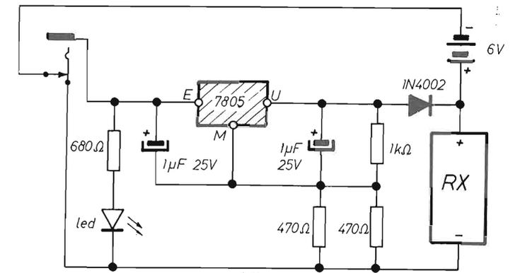
figura 8 - Schema elettrico adattatore da 12V a 6V.
