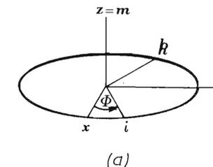
Il sistema di assi x, y, z, che abbiamo pensato «legato» al corpo, dopo la rotazione è diventato j, k, m, mentre un ipotetico osservatore rimasto fermo è ancora legato al sistema di coordinate della stanza, cioè ancora x, y, z.
