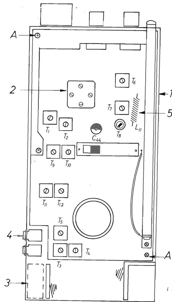
figura 2 - Piastra del ricevitore, mostrata ad apparato aperto.
