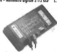
Cambio scale a cursore. Prova transistor e diodi. DCV: 0,2-1000V in 5 scale. ACV: 200-750V in 2 scale. DCA: 0,2-10A in 5 scale. Resist.: 2K-20 MOhm in 5 scale. Imped. ingr.: 10 MOhm/DC-5K/AC. Alimentaz.: batteria interna 9V. Dimens.: 69x145x32. (Altri multimetri pagg. 175-182 Catalogo Monacor)
