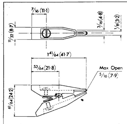
figura 6 - Coccodrilli (twin, independent contact, crocodile clip) speciali Bulgín CR 60 a due contatti indipendenti. (G.B.C. Viale Matteotti, 66 - 20092 Cinisello B. Milano. Syscom - Via Gran Sasso, 35 - 20092 Cinisello B. Milano).
