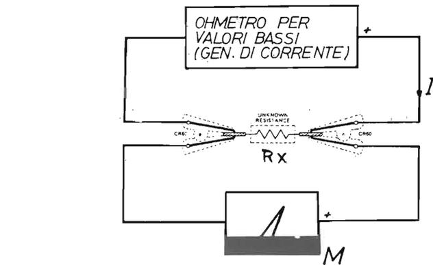
figura 5 - Misura di resistenze col metodo dei 4 terminali.
