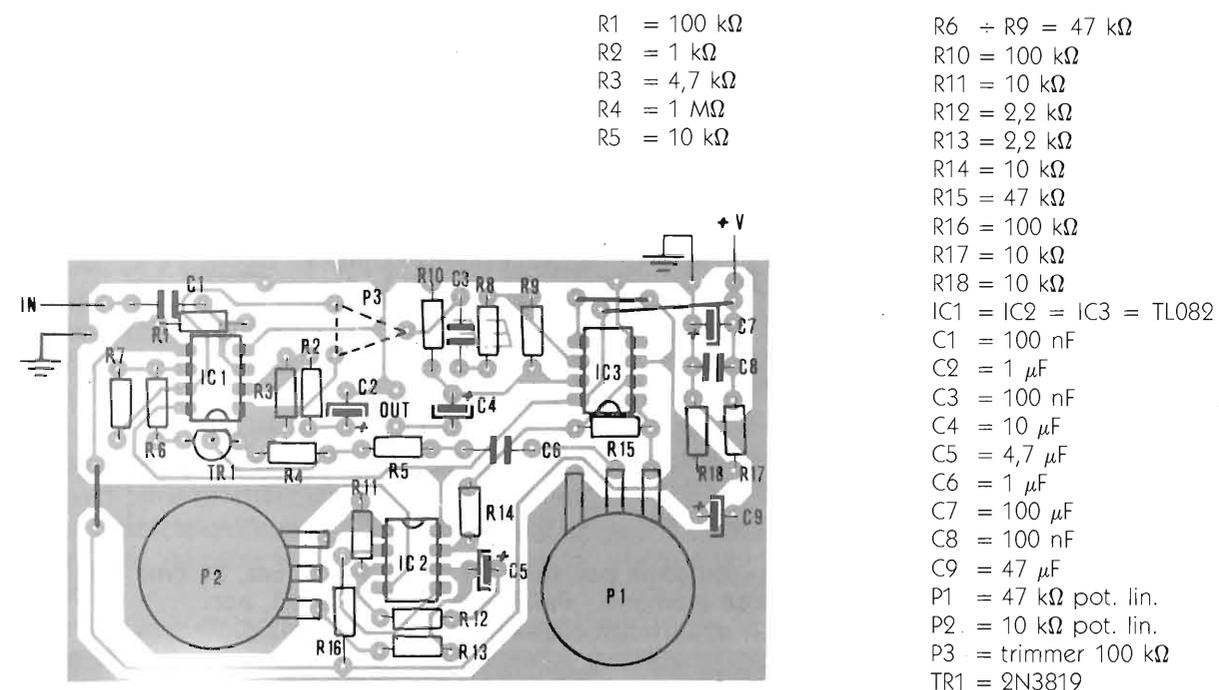
figura 4 - Disposizione componenti vista lato componenti.
