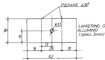
figura 4 - Dissipatore di calore per IC1 e IC2.
