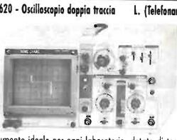
Strumento ideale per ogni laboratorio, dotato di tester componenti. Banda passante: DC-20 Mhz. Sensibil.: 5mV-20V/div. Altri dati a richiesta. Peso: 7 Kg. ca. Ottimo rapporto prezzo/prestazioni. Dimensioni: 294x352x162 mm. (Altri strumenti pagg. 163-189 Catalogo Monacor)
