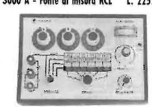
Per misurare con precisione resistenze, condensatori, bobine e rapporto primario-secondario di trasform. audio. 6 campi di misura. Peso avarico, per rilev. acustico dello zero. Induttanze: 1 mH-111 H. Capacità: 10 pF-110 nF. Resist.: 0,1 Ohm-11,1 MOhm. Aliment. batteria 9V. Dimens.: 200x100x160 mm. (Altri strumenti pagg. 163-185 Catalogo Monacor)
