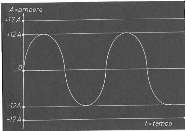
figura 5 - L'intervento della protezione sui 12 A impone una riduzione dell'escursione dell'onda sotto i 12 A di picco, si evita quindi la tosatura dell'onda fenomeno già evidenziato in figura 4. La potenza utile è uguale a:
