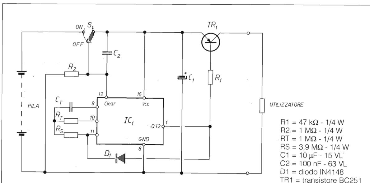
figura 1 - Temporizzatore per pile normali ed alcaline
