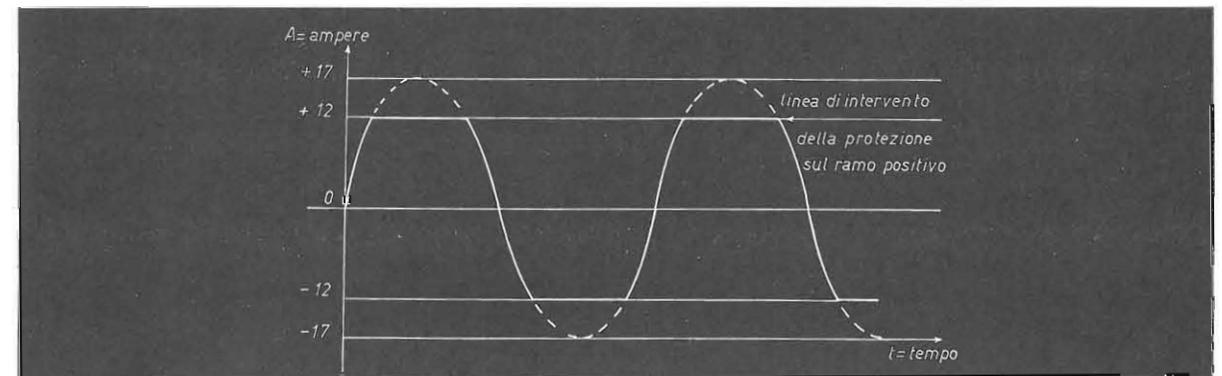
figura 4 - Tipica situazione con intervento delle protezioni su 12 A - Per evitarla dovremo necessariamente contenere l'onda sinusoidale entro il tetto dei 12 A di picco. La relativa potenza utile sarà quindi uguale a:
