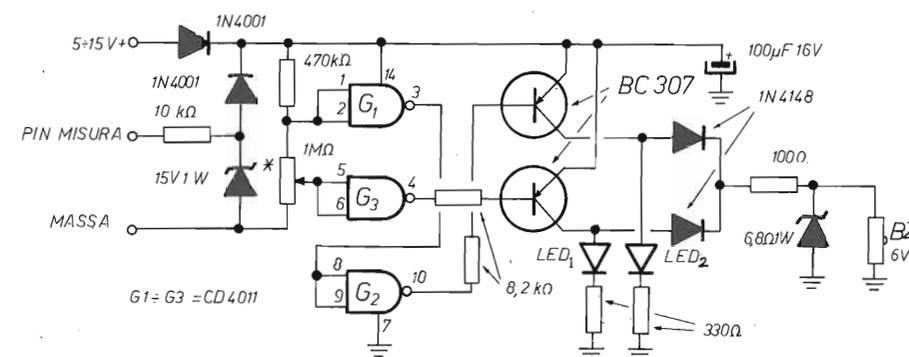
\* Regolare P1 per avere i led spenti anche ad alimentazione inserita, ma con puntale sonda sconnesso.
