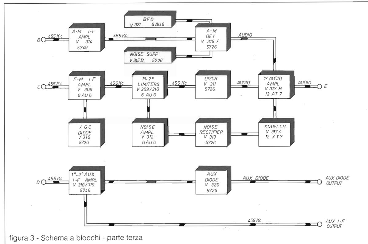
figura 3 - Schema a blocchi - parte terza
