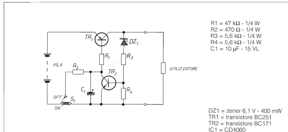
figura 2 - Limitatore di scarica per batterie al Nichel-Cadmio
