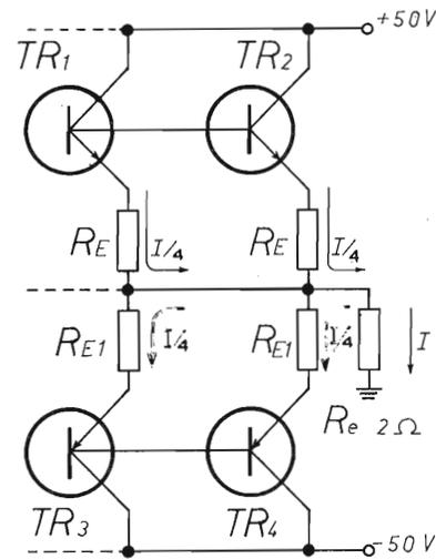
figura 1 - Schema semplificato della nostra sezione finale. I transistor  $TR_1$ - $TR_2$  sono in conduzione. Mentre  $TR_3$ - $TR_4$  sono interdetti. La potenza sul carico è data dalla formula 1. Con la formula 2 si ricava la relativa corrente.
