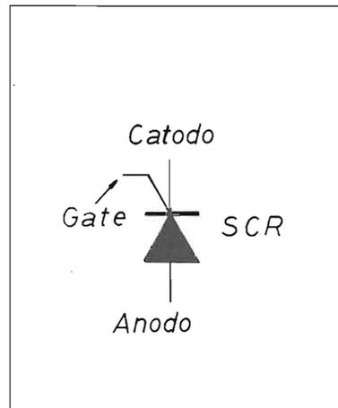
Un SCR, quando funziona in C.C., una volta attivato, può essere disattivato solamente andando ad interrompere elettricamente il circuito che l'SCR stesso pilota. Per questo ho previsto in serie alla bobina del relé un pulsante del tipo "normalmente chiuso" (n.c.).
