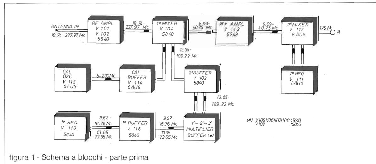
figura 1 - Schema a blocchi - parte prima
