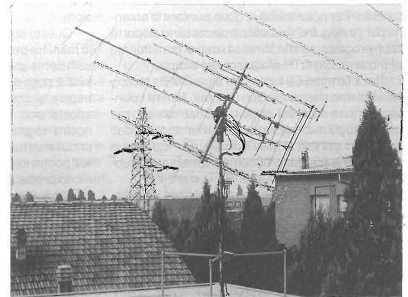
caso di eccedere in quanto possono sorgere problemi meccanici date le dimensioni delle antenne. In UHF, essendo le antenne più piccole si possono utilizzare delle 15-20 elementi, oppure antenne elicoidali che sono già costruite per funzionare in polarizzazione circolare senza l'utilizzo di accoppiatori particolari.
