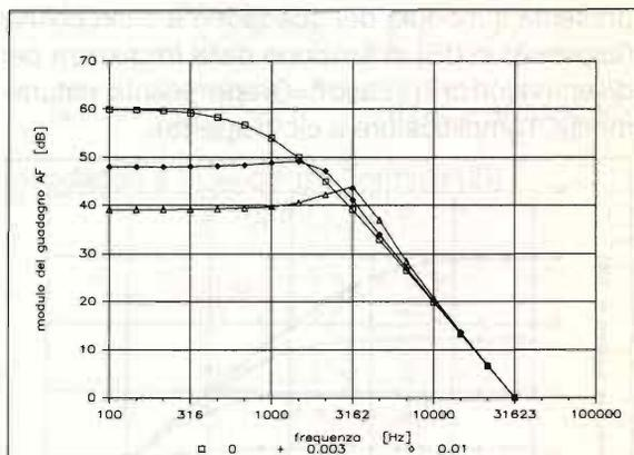
figura 3 - Risposta in frequenza di un amplificatore controreazionato, con due tagli ad alta frequenza (a 1000 Hz) e guadagno totale a ciclo aperto  $A_o = 1000$ . Le varie curve corrispondono a diversi valori di  $\beta$  (la più alta, corrispondente a  $\beta = 0$ , rappresenta la risposta in frequenza a ciclo aperto).
