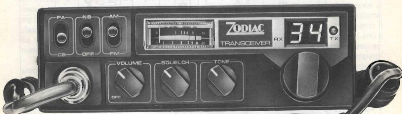
Apparato ricetrasmittente AM-FM per uso veicolare. Possibilità di impiego sia per uso amatoriale che per uso civile (industria, commercio, sanità, vigilanza, ecc.) Controllo di volume, squelch e tono; possibilità di diffusione di un messaggio in bassa frequenza (PA); riduttore di rumore incorporato, selettore AM/FM; indicatore a led di funzione RX e TX; indicatore di canale a display; strumento indicatore della potenza RF in uscita e dell'intensità del segnale in arrivo.
