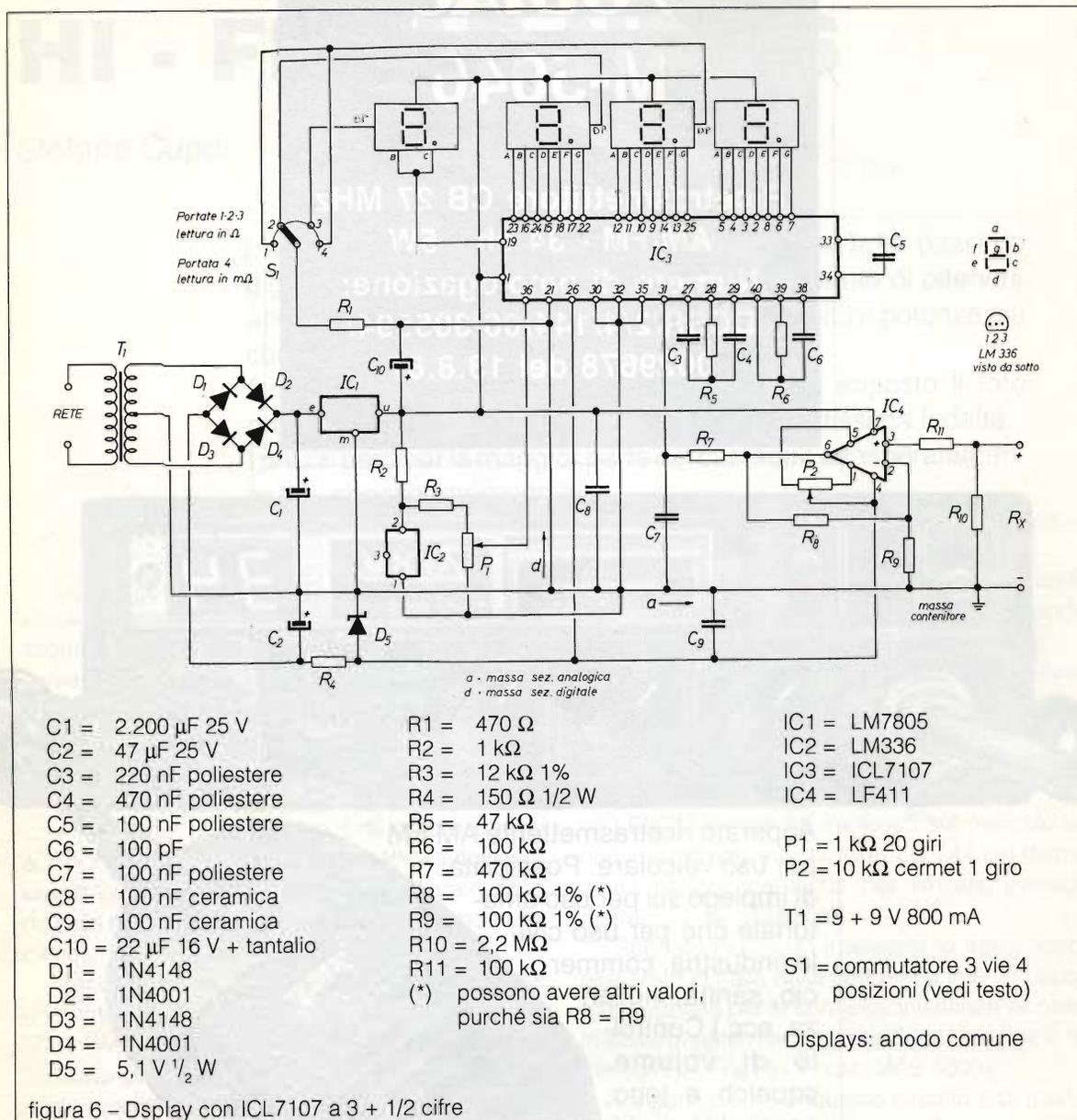
resistenza all'1 % da 100 + 180  $\Omega$ , commutare sulla portata 4, collegare il tutto e girare  $P_1$  (misuratore) sino a leggere sul display il valore nominale; si può per sicurezza ripetere la misura con vari resistori, per controllo. Ricordo che un resistore da 100  $\Omega$  misurato con il multimetro normale viene letto con un errore di circa + 0,3 %, quindi in questo caso si può fare un confronto.
