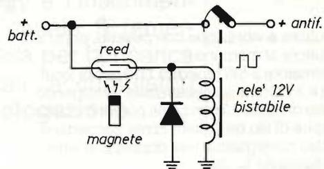
Figura 2 - Attivatore/disattivatore allarme.
