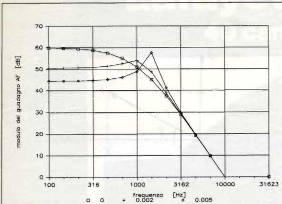
figura 4 - Risposta in frequenza di un amplificatore controeazionato, con tre tagli ad alta frequenza (tutti a 1000 Hz) e guadagno totale a ciclo aperto  $A_o=1000$ . Le varie curve corrispondono a diversi valori di  $\beta$  (la più alta, corrispondente a  $\beta=0$ , rappresenta la risposta in frequenza a ciclo aperto).
