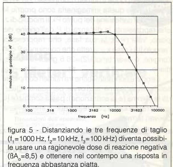
figura 5 - Distanziando le tre frequenze di taglio ( $f_1=1000$  Hz,  $f_2=10$  kHz,  $f_3=100$  kHz) diventa possibile usare una ragionevole dose di reazione negativa ( $\beta A_o=8,5$ ) e ottenere nel contempo una risposta in frequenza abbastanza piatta.
