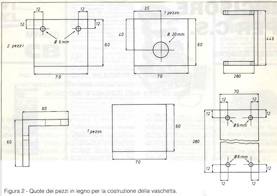
Figura 2 - Quote dei pezzi in legno per la costruzione della vaschetta.
