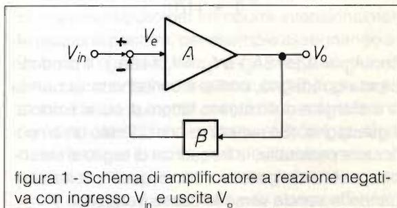
figura 1 - Schema di amplificatore a reazione negativa con ingresso  $V_{in}$  e uscita  $V_o$ .
