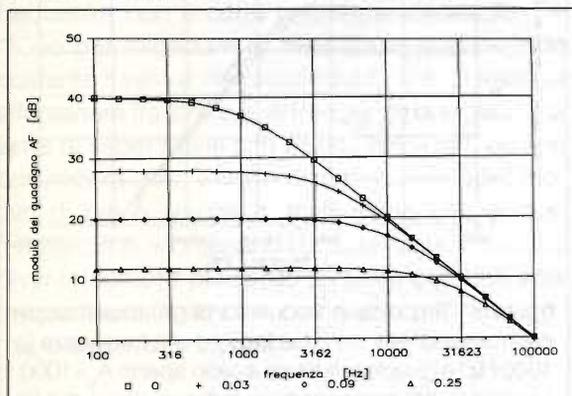
figura 2 - Risposta in frequenza di un amplificatore controeazionato, con una sola frequenza di taglio (1000 Hz) e guadagno a ciclo aperto  $A_o=10$ . Le varie curve corrispondono a diversi valori di  $\beta$  (la più alta, corrispondente a  $\beta=0$ , rappresenta la risposta in frequenza a ciclo aperto).
