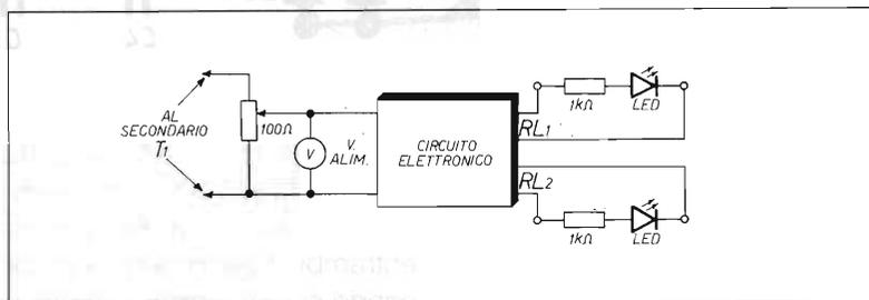
che i trasformatori siano messi in fase, bisognerà dare tensione al circuito e ruotare P1 e P2 sino a che i trasformatori stessi siano entrambi inseriti. All'uscita avremo quindi 260 V.
