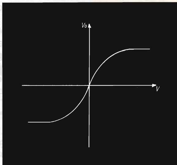
figura 2 - Tipica curva caratteristica ingresso-uscita di un amplificatore:  $V$  rappresenta l'ingresso,  $V_o$  l'uscita.
