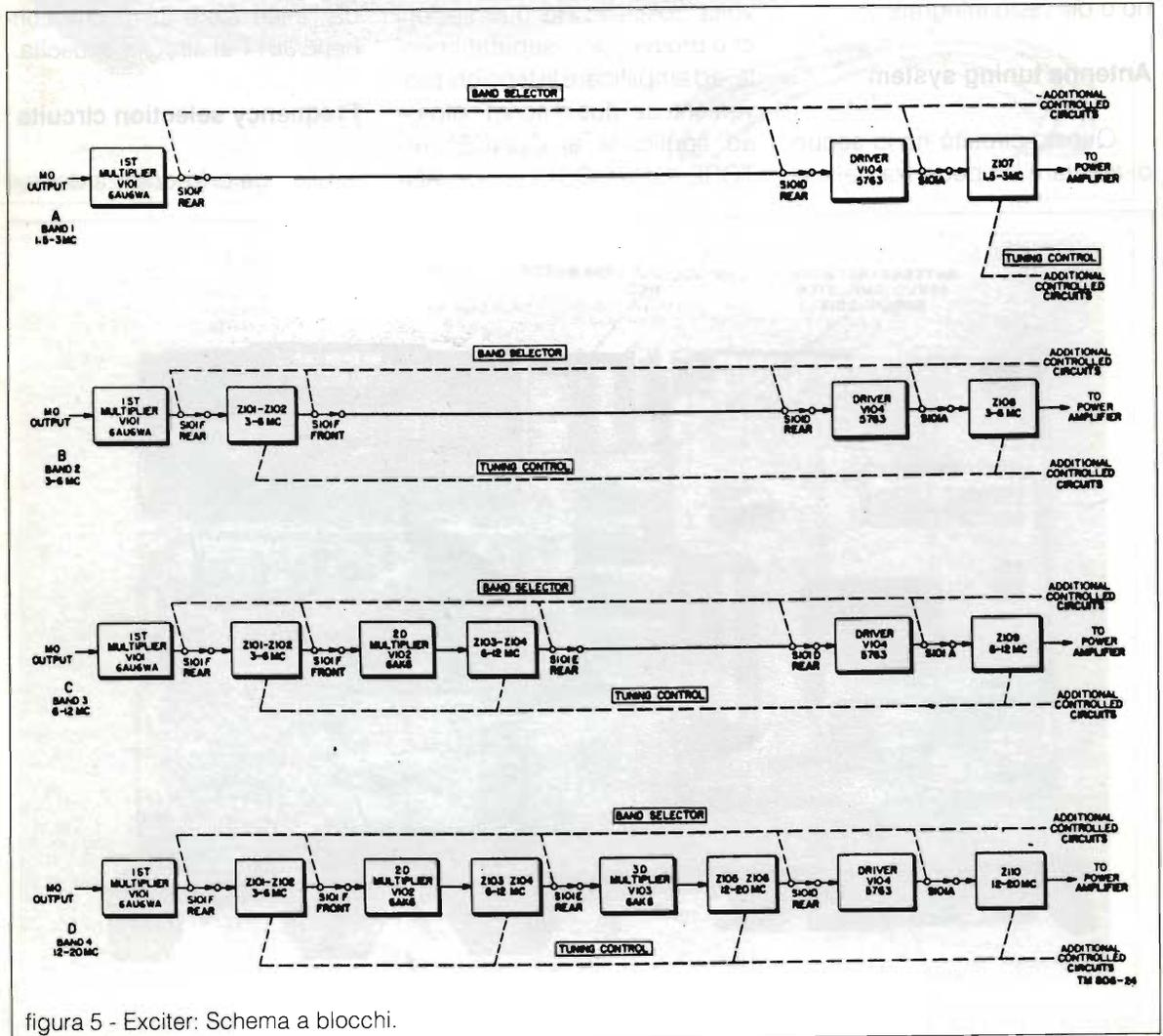
figura 5 - Exciter: Schema a blocchi.
