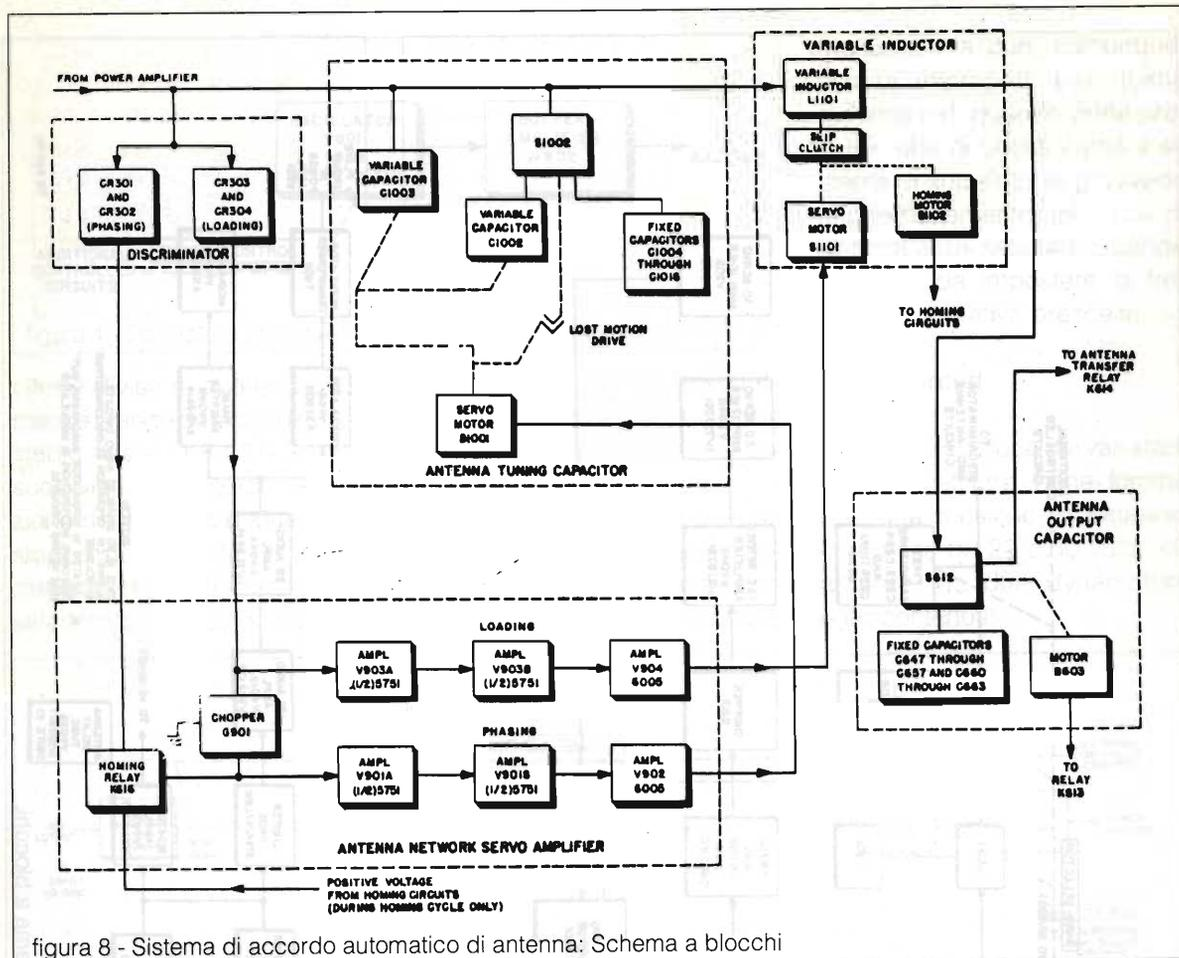
figura 8 - Sistema di accordo automatico di antenna: Schema a blocchi
