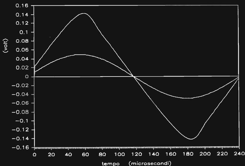
figura 6 - Il segnale d'errore  $V_e$  nei due casi della figura precedente. Per compensare la distorsione, questo segnale è fortemente distorto: in un caso esso viene ad assomigliare a un'onda triangolare.
