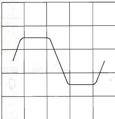
3) Se con ingresso alimentato dal segnale, con carico connesso si verifica una tale forma d'onda, si sta pilotando l'amplificatore oltre il "clipping", cioè il massimo erogabile del circuito.
