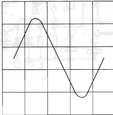
2) Se si verifica alla massima potenza una tale forma d'onda l'alimentatore è insufficiente.
