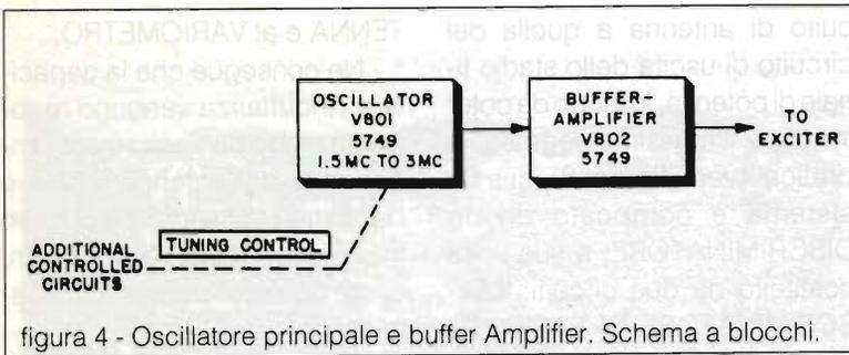
figura 4 - Oscillatore principale e buffer Amplifier. Schema a blocchi.
