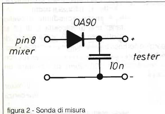
figura 2 - Sonda di misura
