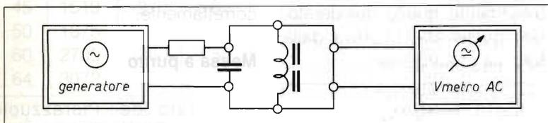
Si varia poi leggermente la frequenza sino a trovare il picco di risonanza, e si misura esattamente a quale frequenza avviene. L'induttanza effettiva è data ovviamente dalla formula precedente invertita.
