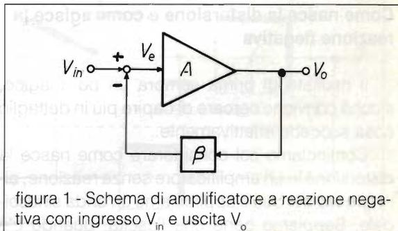
figura 1 - Schema di amplificatore a reazione negativa con ingresso  $V_{in}$  e uscita  $V_o$ .
