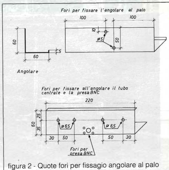
figura 2 - Quote fori per fissaggio angolare al palo
