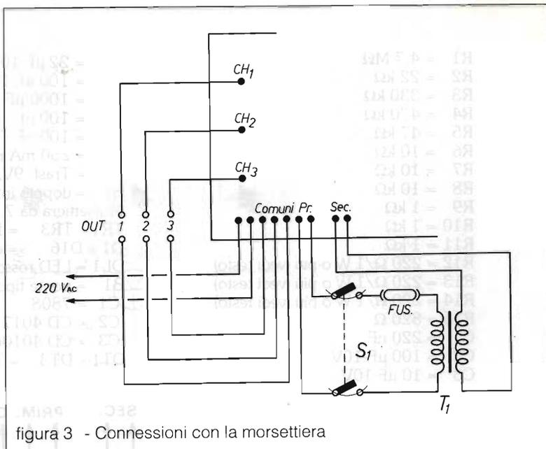
figura 3 - Connessioni con la morsettiere
