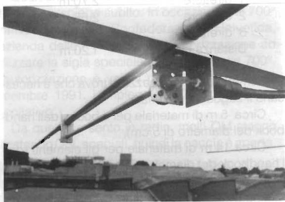
Il boom di sezione quadra è stato scelto per comodità di foratura in quanto un boom tondo, se non con particolari attrezzature, non dà la certezza di riuscire a forare sullo stesso asse tutti gli elementi; con un boom quadro è almeno più facile.
