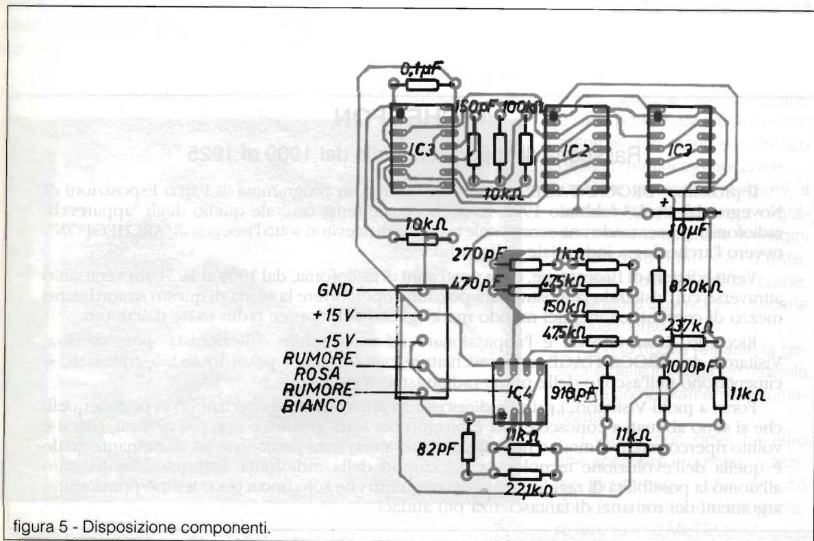
figura 5 - Disposizione componenti.
