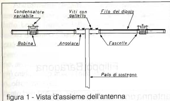
figura 1 - Vista d'assieme dell'antenna
