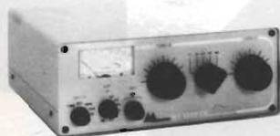
Accordatore d'antenna 25-30 MHz + 45/88/16/12 m.
