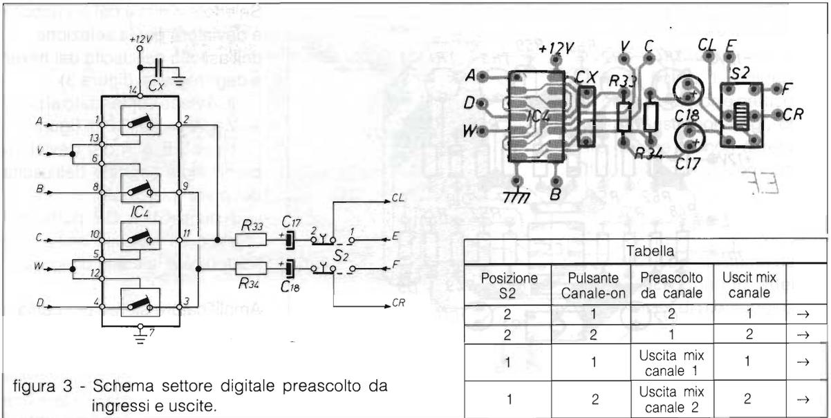
figura 3 - Schema settore digitale preascolto da ingressi e uscite.
