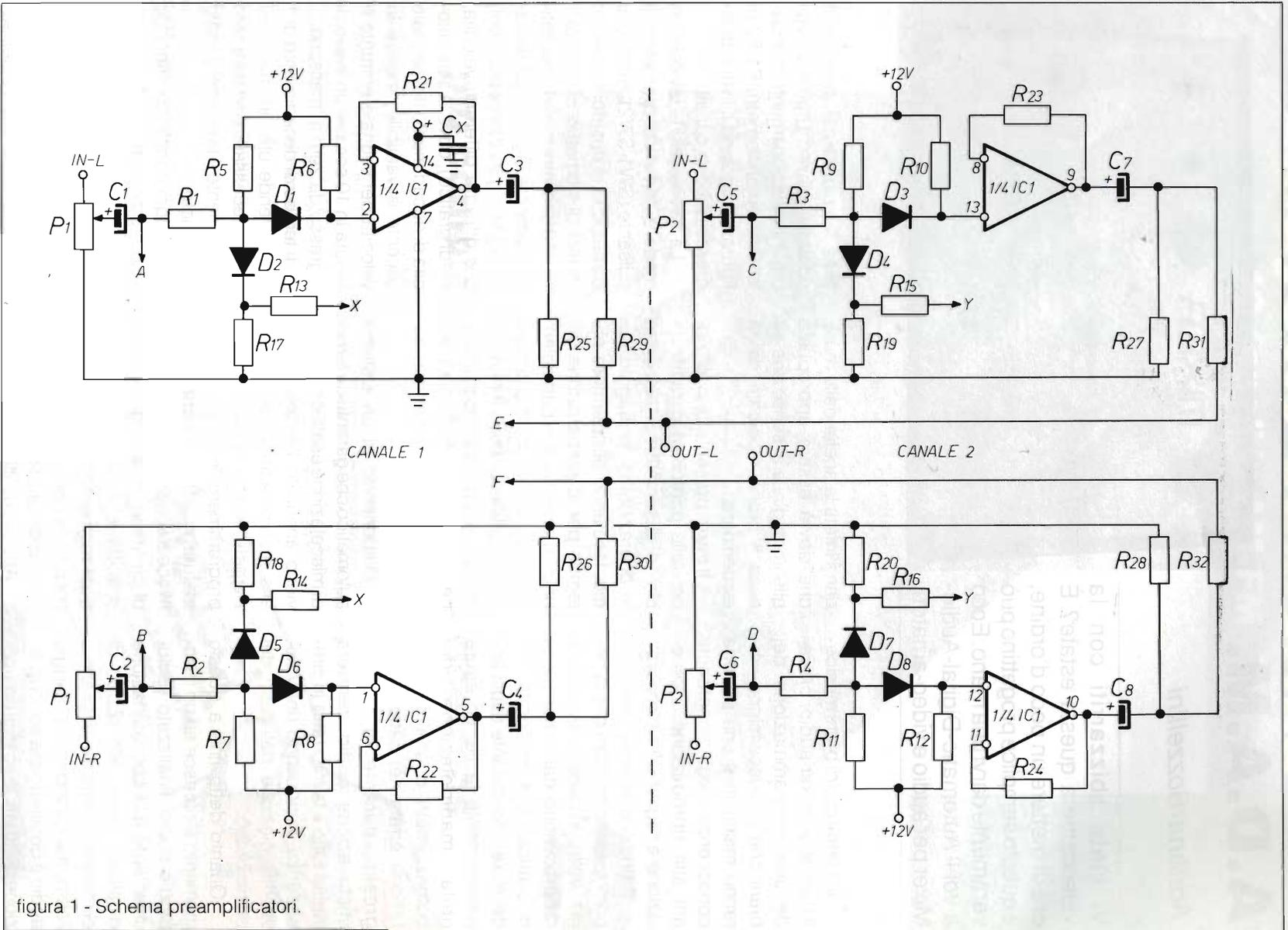
figura 1 - Schema preamplificatori.
