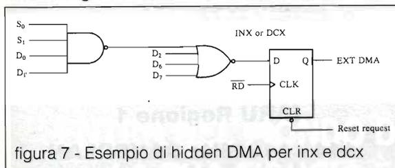
figura 7 - Esempio di hidden DMA per inx e dcx
