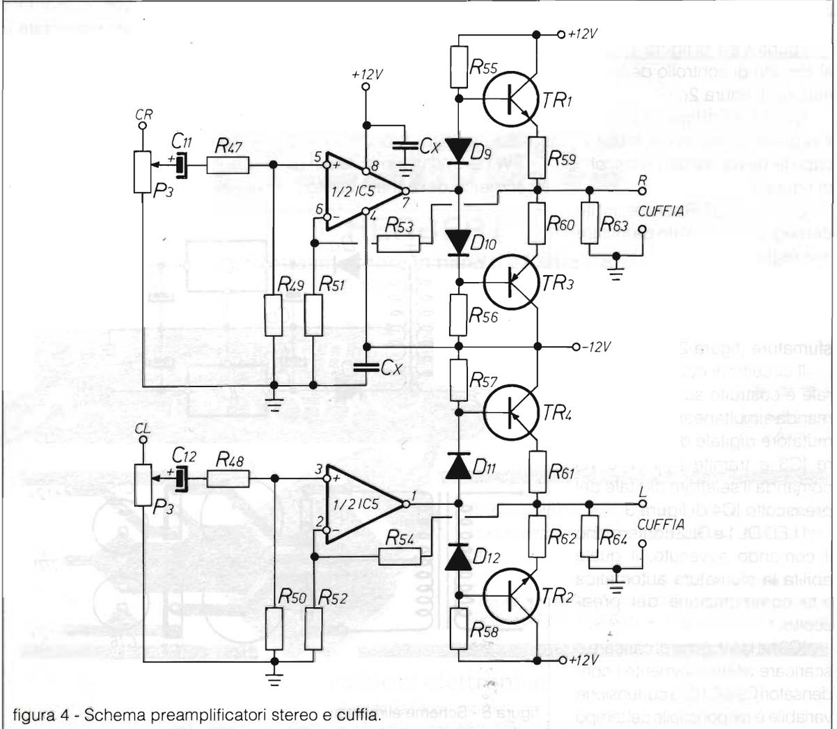
figura 4 - Schema preamplificatori stereo e cuffia.
