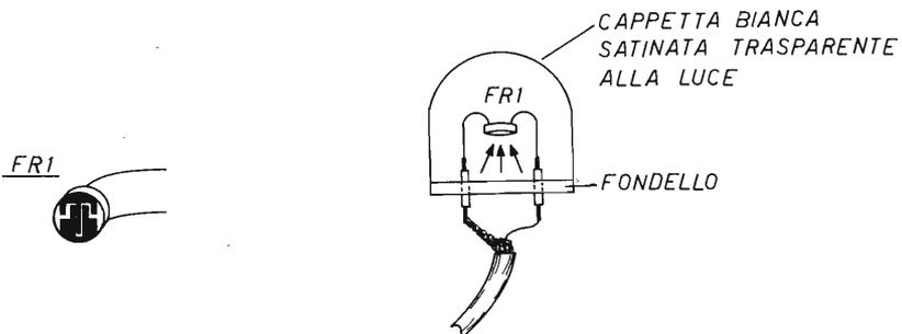
figura 3 - Realizzazione e isolamento del sensore di luce.
