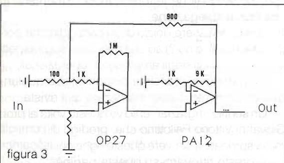
Abbiamo visto come due operazionali in cascata possono essere considerati alla stregua di un unico op-amp avente le seguenti caratteristiche: il guadagno totale è il **PRODOTTO DEI SINGOLI GUADAGNI** (o la somma se parliamo di dB), la fase totale è la **SOMMA DELLE SINGOLE FASI**.
