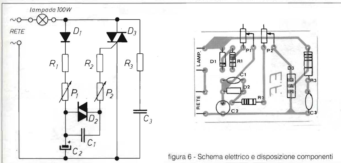
figura 6 - Schema elettrico e disposizione componenti
