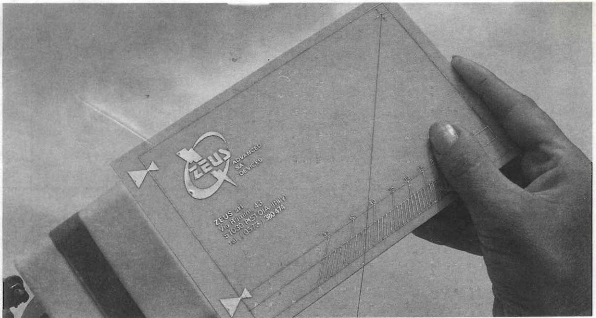
Foto 4 - Uso dell'inclinometro per ottimizzare il fissaggio del convertitore LNB al tripode della parabola.
