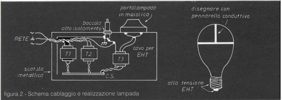
figura 2 - Schema cablaggio e realizzazione lampada
