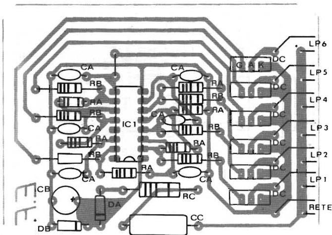
figura 5 - Disposizione componenti
