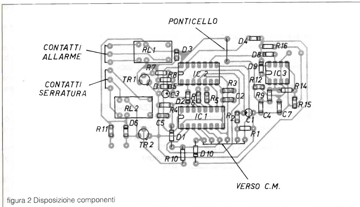
figura 2 Disposizione componenti
