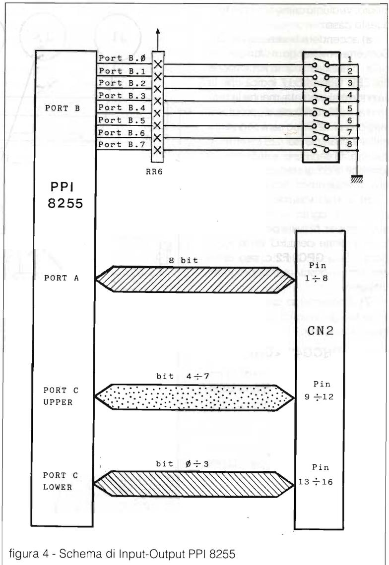
figura 4 - Schema di Input-Output PPI 8255
