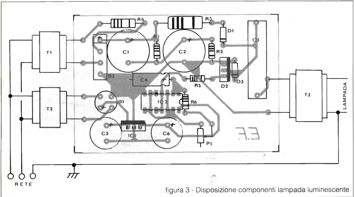
figura 3 - Disposizione componenti lampada luminescente
