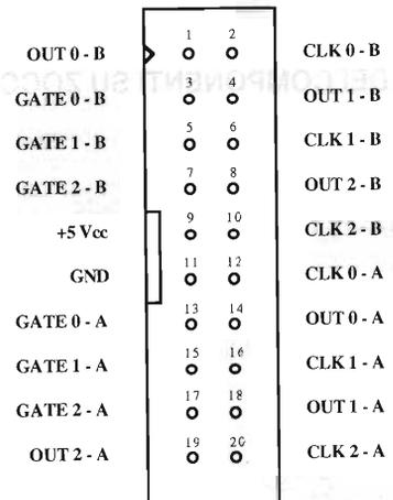
Tab. 3 Connettore CN1 Programmable Interval Timer 8253
