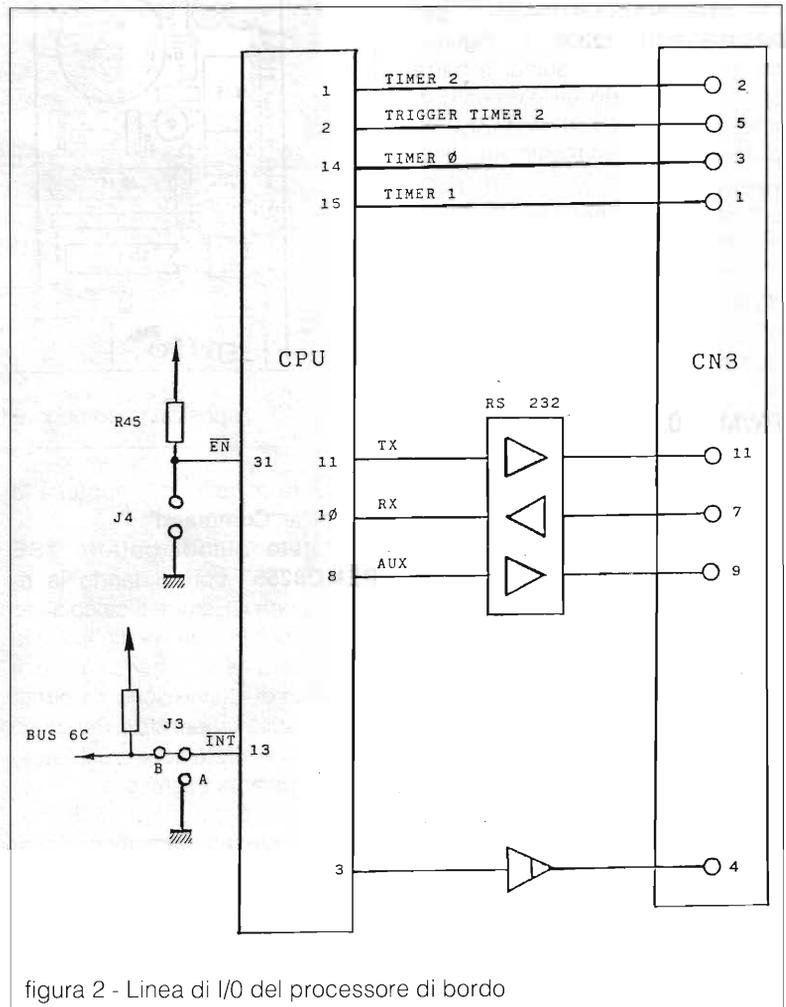
figura 2 - Linea di I/O del processore di bordo
