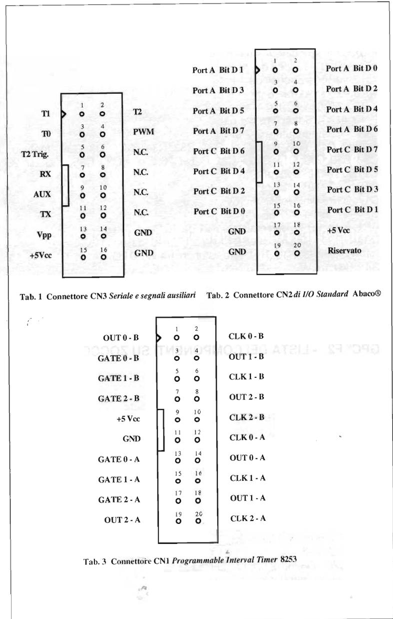
Tab. 1 Connettore CN3 Seriale e segnali ausiliari Tab. 2 Connettore CN2 di I/O Standard Abaco®
