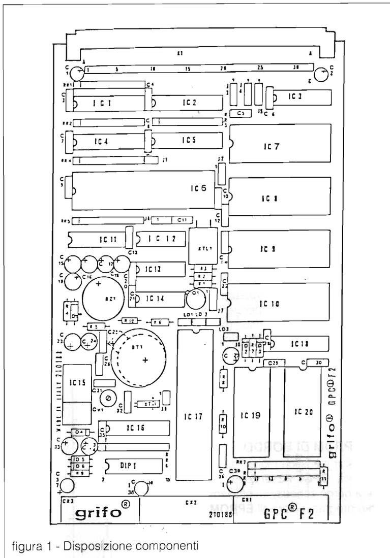
figura 1 - Disposizione componenti
