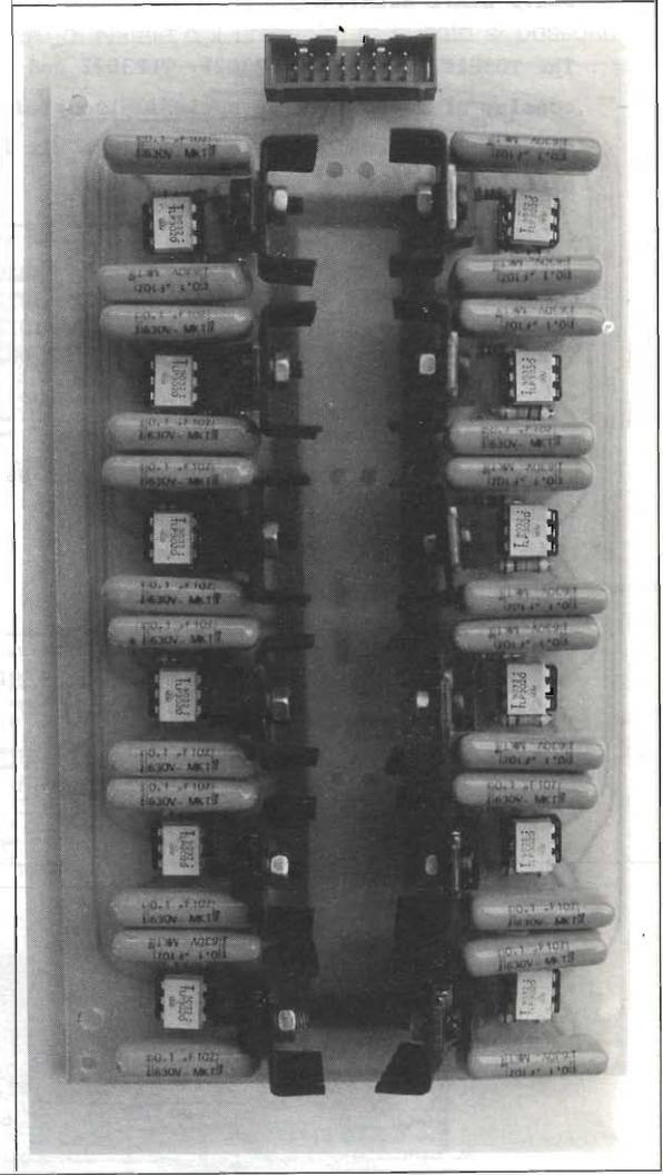
Anche la scheda di potenza è a passo europeo e pertanto inseribile nelle guide, quindi nulla vieta di utilizzare un rack da 42 unità, con l'accorgimento però di dotare l'alimentatore + la CPU + la 8255 di un BUS-MINI, ossia di un bus più corto.
