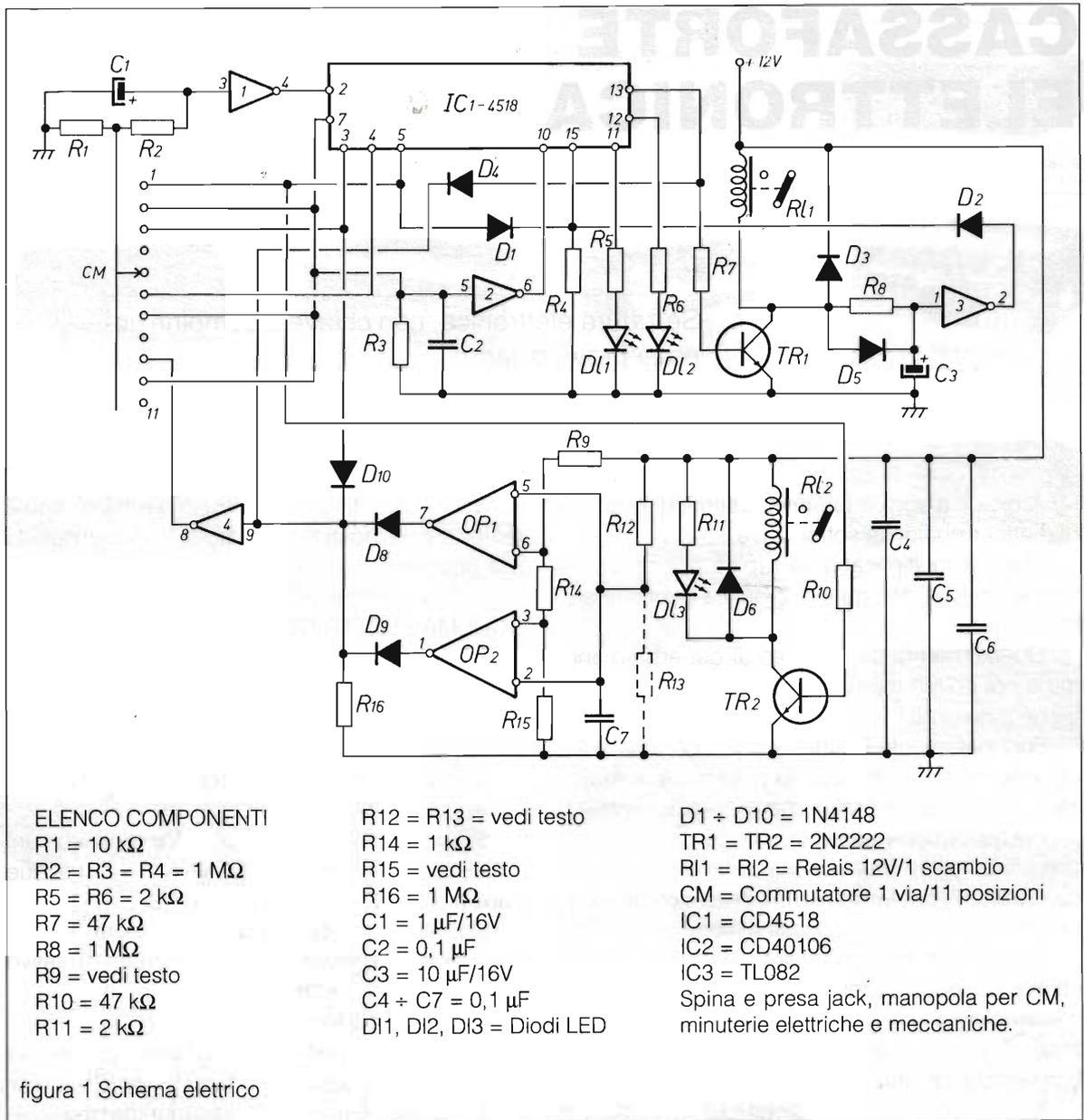
figura 1 Schema elettrico
