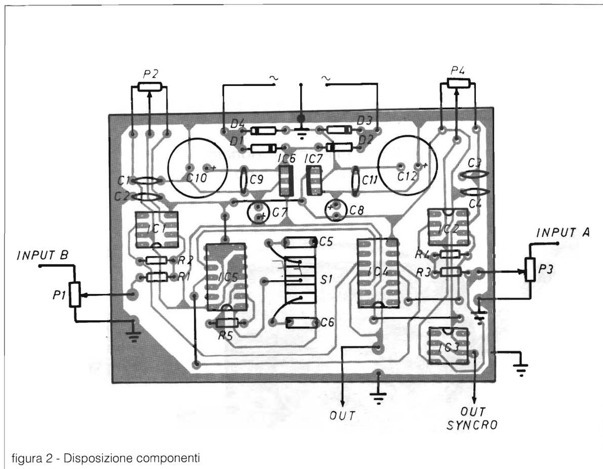
figura 2 - Disposizione componenti
