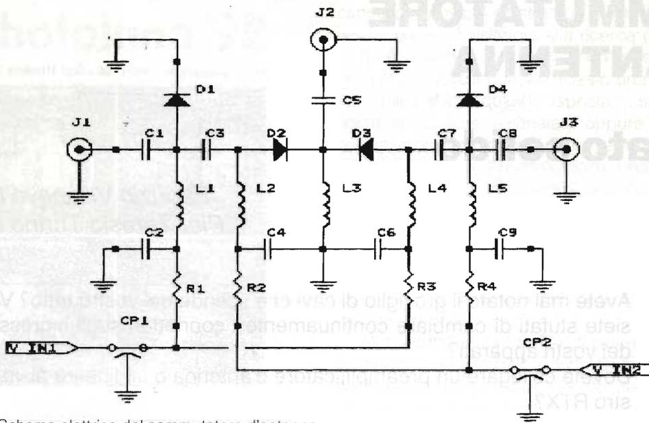
figura 1 - Schema elettrico del commutatore d'antenna
