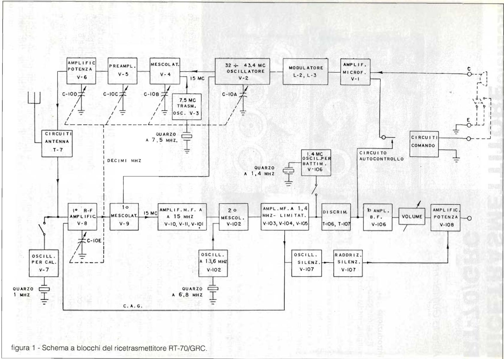
figura 1 - Schema a blocchi del ricetrasmittitore RT-70/GRC.
