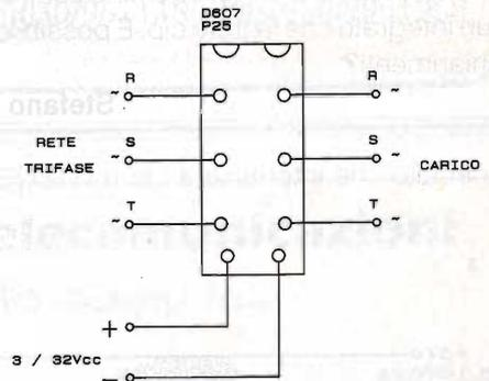
tenuto all'interno di un power stacks con aletta isolata e comprende un triplo accoppiatore ottico e zero crossing detector. La tensione continua applicabile all'ingresso, può variare da 3 a 32V, mentre per il carico, con controllo in serie, potrà raggiungere i 25A a 380V. Naturalmente è necessario dissipare bene l'SSR. (Crydom D607P25 venduto dalla Conrad international).
