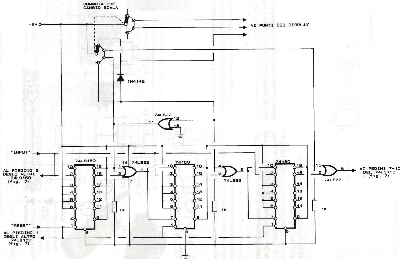
figura 15 - Circuito che permette il cambio di scala.
