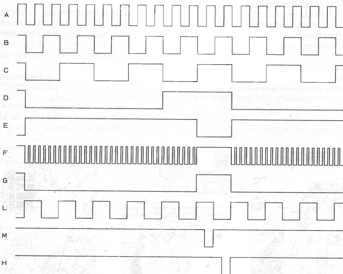
figura 11 - Rappresentazione semplificata degli stati logici presenti in vari punti del modulo di "servizio" di figura 10, durante il funzionamento.
