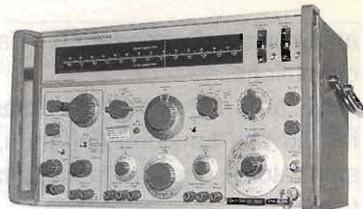
Marconi TF 2008 generatore di segnali 10 kHz+510 MHz AM-FM Sweep Marker Stabilità 5ppm Lit. 1.150.000 + IVA
