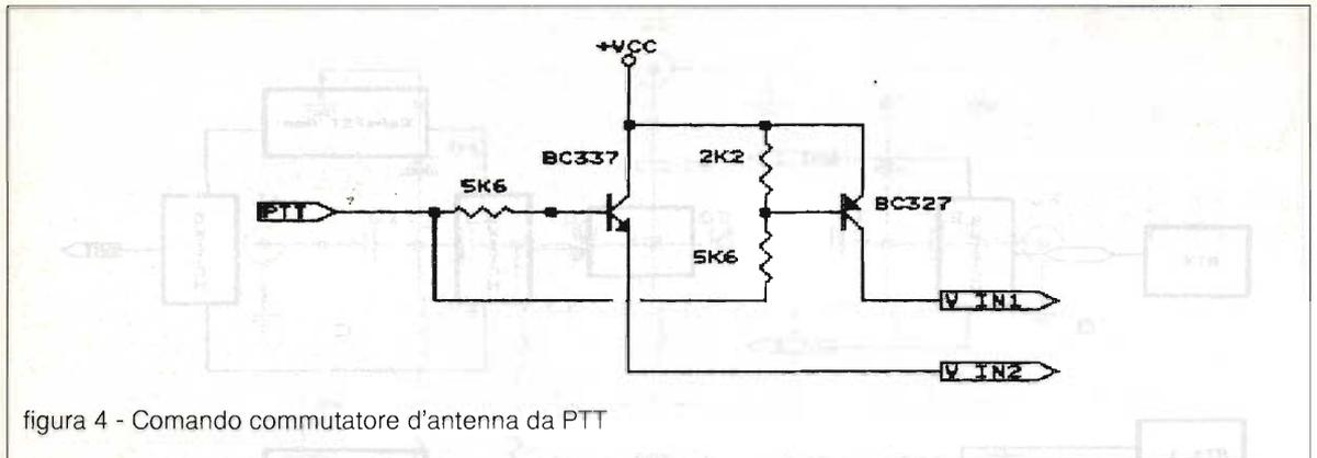
figura 4 - Comando commutatore d'antenna da PTT
