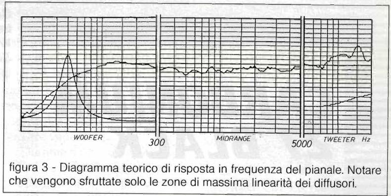
figura 3 - Diagramma teorico di risposta in frequenza del pianale. Notare che vengono sfruttate solo le zone di massima linearità dei diffusori.
