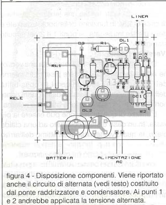
figura 4 - Disposizione componenti. Viene riportato anche il circuito di alternata (vedi testo) costituito dal ponte raddrizzatore e condensatore. Ai punti 1 e 2 andrebbe applicata la tensione alternata.
