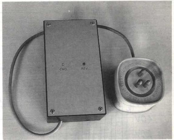
Circuito elettronico azionato dall'alternata della suoneria telefonica per effettuare operazioni di ripetizione o azionamento di qualsiasi altro dispositivo. Non interviene durante gli impulsi di selezione e non presenta alcun sovraccarico alla linea, caratteristica, questa, molto sentita nei casi di linee telefoniche lunghe o comunque con tensione di chiamata di debole intensità.
