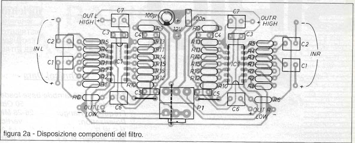
figura 2a - Disposizione componenti del filtro.
