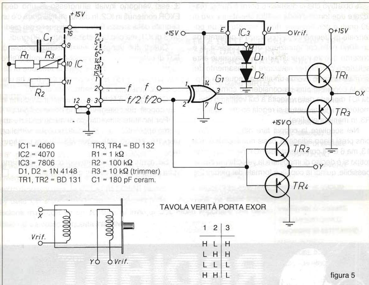
Dalla figura si capisce che invertire il senso della circolazione della corrente negli avvolgimenti statorici successivi corrisponde alla creazione di un campo magnetico rotante che trascina il rotore a magneti permanenti. La velocità di rotazione dipende dalla frequenza alla quale vengono commutate le alimentazioni dei poli statorici, e il verso di rotazione dalla sequenza di commutazione.
