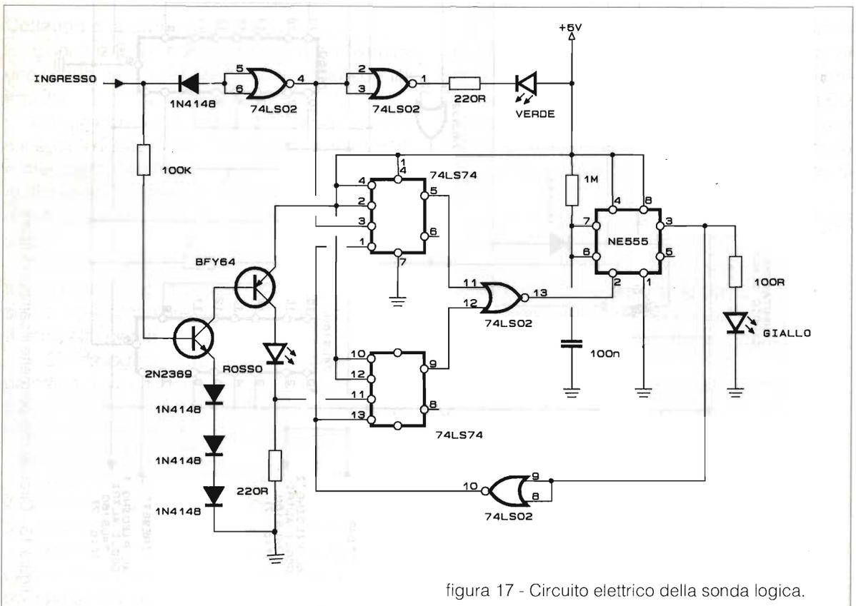
figura 17 - Circuito elettrico della sonda logica.
