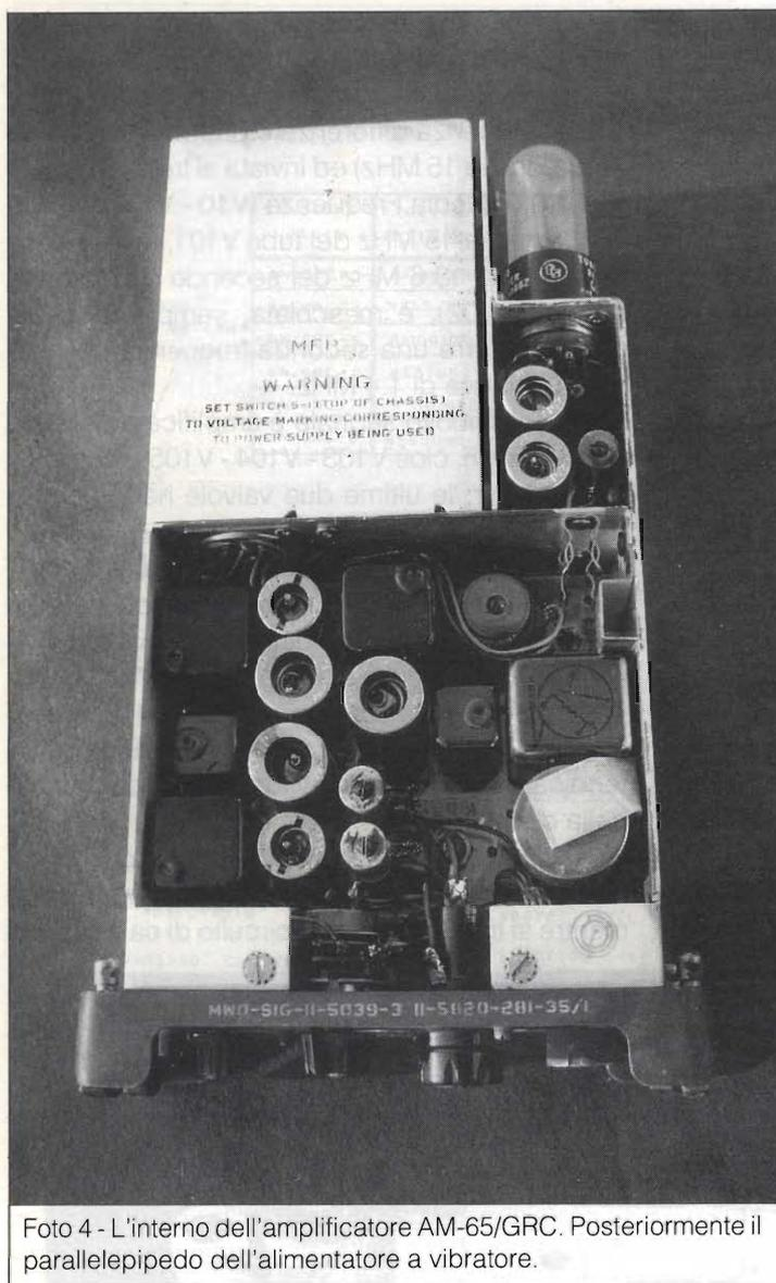
Foto 4 - L'interno dell'amplificatore AM-65/GRC. Posteriormente il parallelepipedo dell'alimentatore a vibratore.
