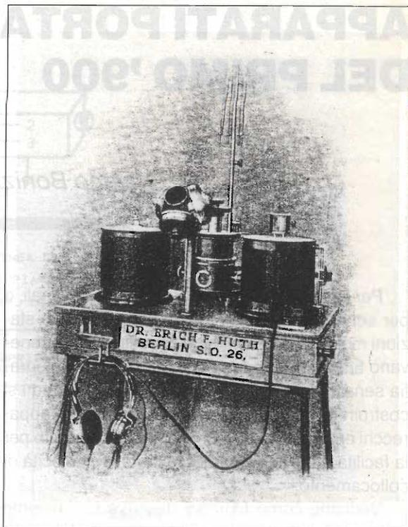
per un'onda di 400 metri, uno spinterometro a filo di zinco, un commutatore, ecc.. Quelli del ricevitore in un'altra cassetta del peso di 15 kg contenente: telefono con il rivelatore elettrolitico Schloemilch, un telefono doppio, un condensatore variabile, quattro pile a secco, un commutatore.
