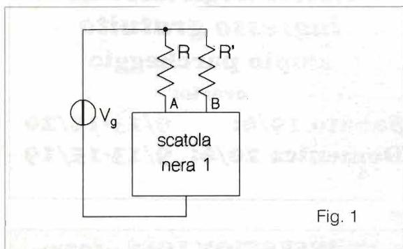
Quando all'ingresso del circuito di figura 1 viene collegato un generatore di tensione sinusoidale  $V_g$ , la tensione che si misura fra i punti A e B ha ampiezza pari a metà di quella del generatore, qualunque sia il valore del resistore  $R'$  e qualunque sia la frequenza del generatore.
