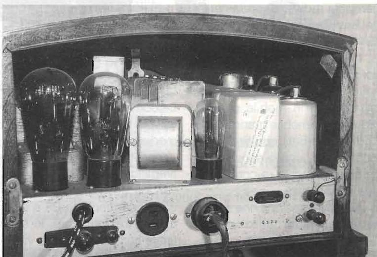
Particolare del telaio nel retro del mobile
