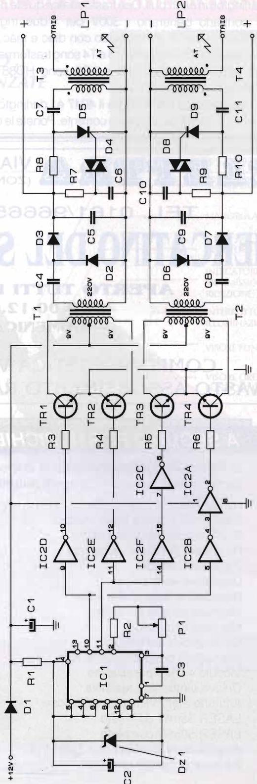
Il circuito si compone di un doppio oscillatore di potenza pilotato da un CD4047 e due coppie di darlington in push pull. Due trasformatori di rete posti al contrario generano i 300V per i due trigger stroboscopico: di tipo classico con diac e triac, ad oscillatore a rilassamento. T3 e T4 sono trasformatori per lampade strobo, LP1 e LP2 sono HD88 da 50W/sec.
