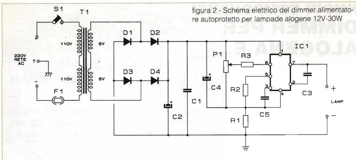
ta rispetto quella di potenza mediante R1. Questo garantisce massima reiezione ai disturbi, siano questi esterni che determinati dallo stesso alimentatore. L'alimentatore non usa bobine, quindi nessun nucleo e induttore critico. L'integrato L9830 si presenta come un contenitore per transistor di
