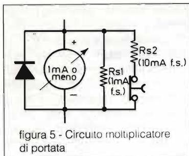
trovare il fondo scala e mettere poi un parallelo di resistori che forniscano il valore resistivo richiesto.
