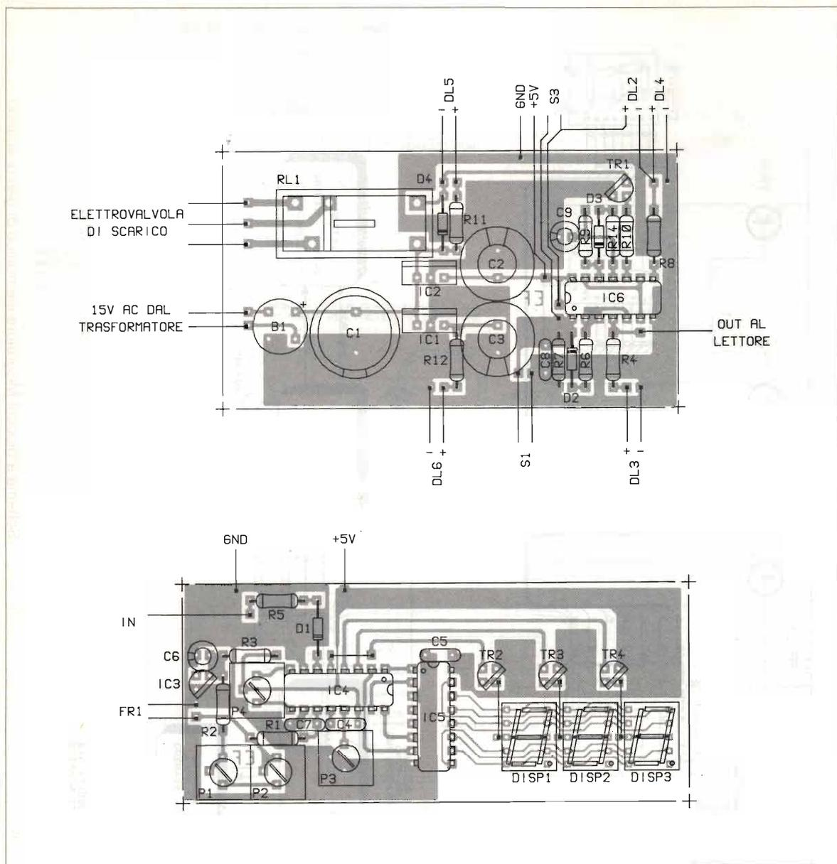
Montate su zoccolo tutti gli integrati escluso IC1, IC2, IC3.
