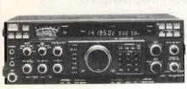
**FT990** - Potenza 100W RX-TX all mode Range 0,1+30 MHz con accordatore automatico
