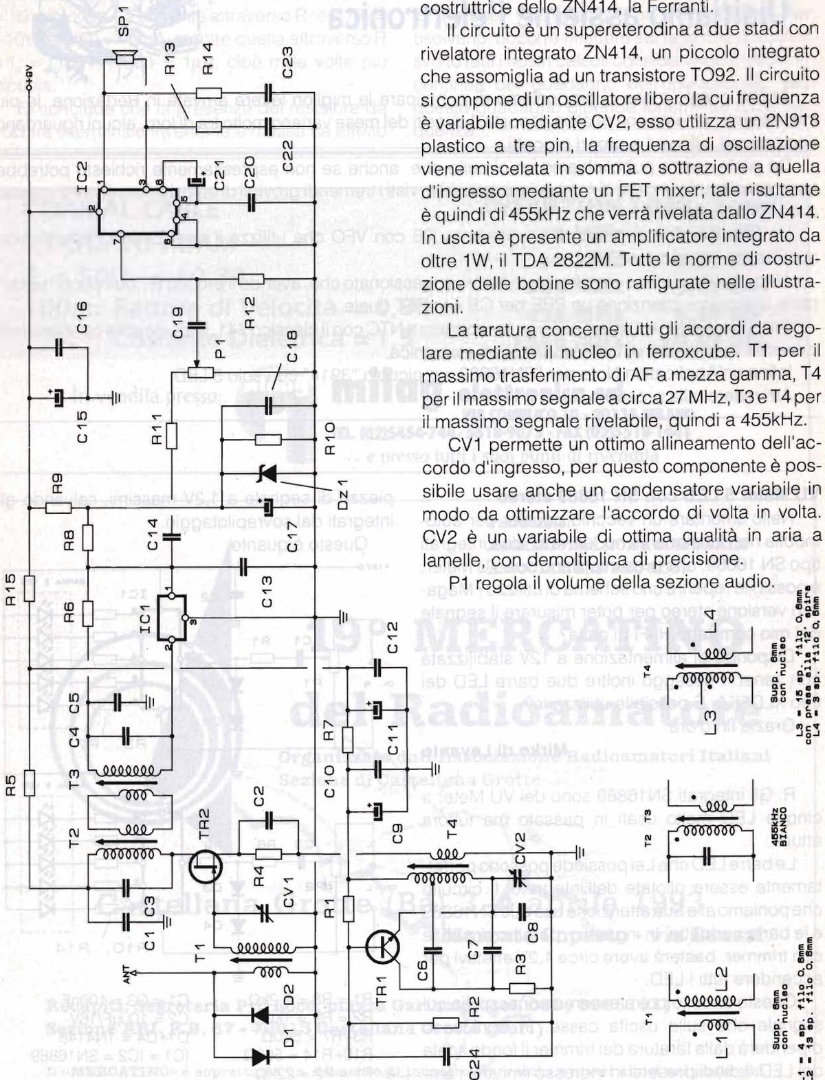
Il circuito è stato assemblato su basetta millefori in vetronite, con collegamenti molto corti e trasferimenti di AF in cavo RG58. Chiudete il circuito in scatola metallica posta a massa, con fori per i controlli e per il bocchettone d'antenna. L'antenna potrà essere di tipo anche caricato a stilo per 27MHz, ma i migliori risultati si otterranno con una GP 1/4 onda a tetto.
