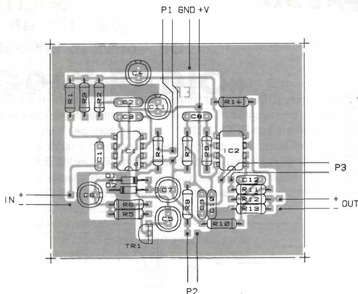
figura 2 - Disposizione componenti
