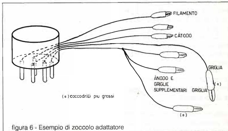
figura 6 - Esempio di zoccolo adattatore
