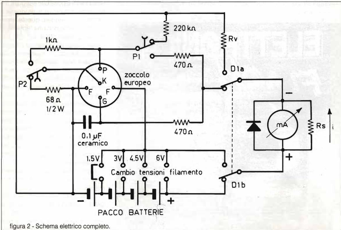
figura 2 - Schema elettrico completo.
