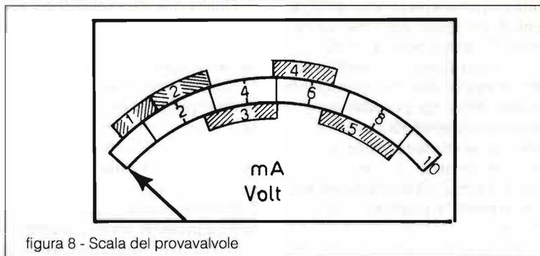
la valvola in prova. Queste zone colorate sono legate al "libretto", che deve essere compilato a cura del costruttore. Infatti a ogni provavalvole che si rispetti, va allegato il "libretto" con i dati di prova e questa nostra realizzazione non fa eccezione.
