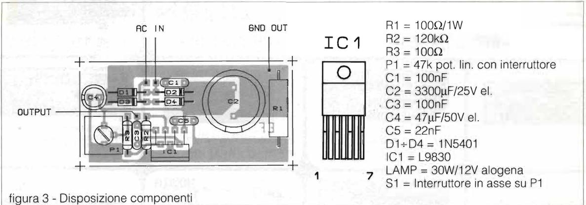
figura 3 - Disposizione componenti
