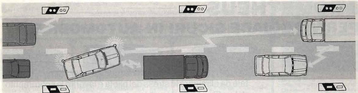
Sistemi elettronici di misura indicano sullo specchietto retrovisore che, valutata la velocità del veicolo da superare, di quello che sorraggiunge in senso contrario ed eventualmente di quello che segue, un sorpasso potrebbe essere pericoloso.
