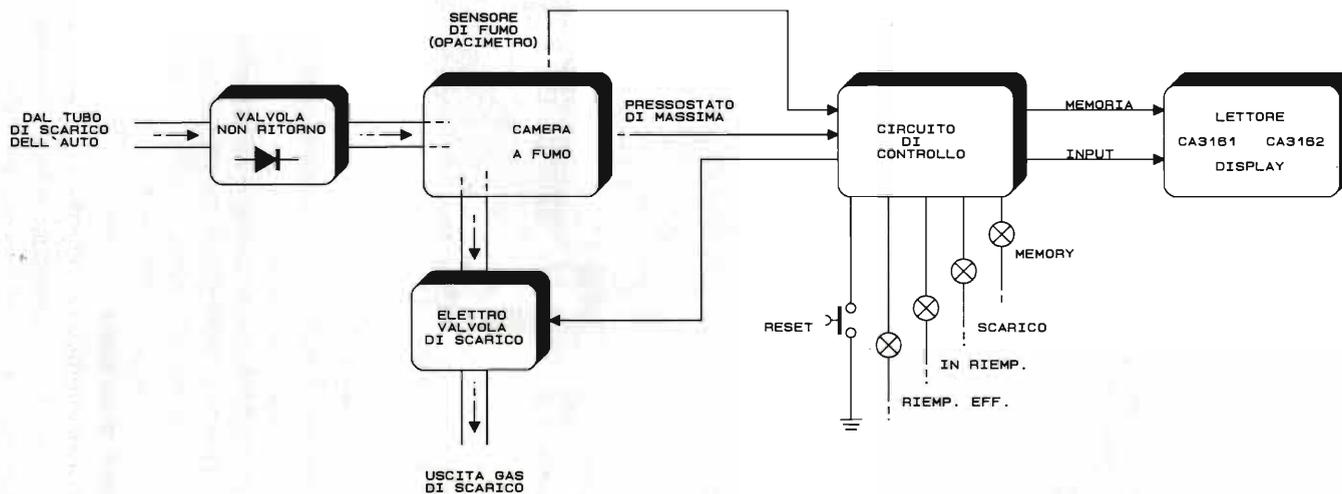
Schema a blocchi Misuratore elettronico di gas di scarico
