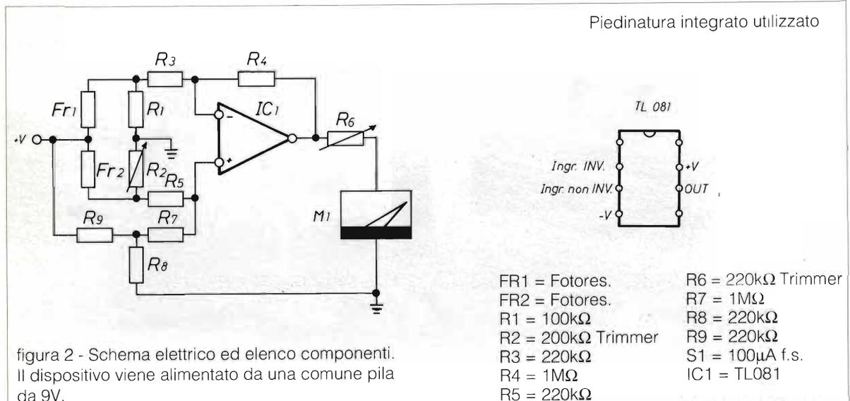
figura 2 - Schema elettrico ed elenco componenti. Il dispositivo viene alimentato da una comune pila da 9V.
