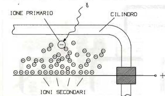
Ciò porterà a una momentanea diminuzione della differenza di potenziale tra filo e cilindro e poi a un successivo ritorno alla condizione preesistente, visto che filo e cilindro rimangono perennemente collegati ai poli del generatore di tensione.
