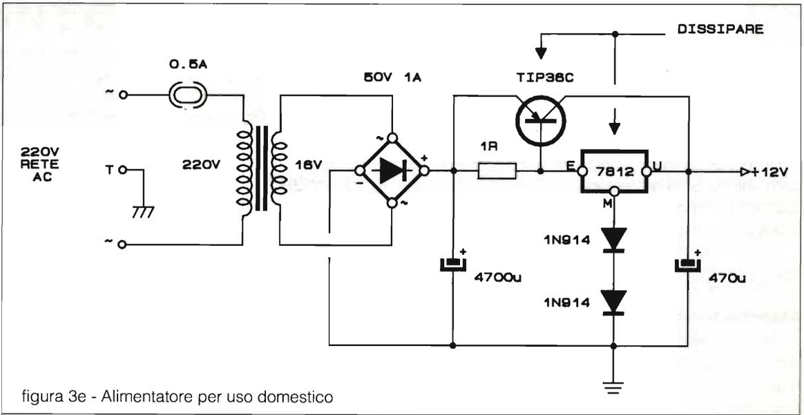
figura 3e - Alimentatore per uso domestico
