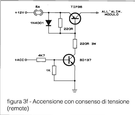
figura 3f - Accensione con consenso di tensione (remote)
