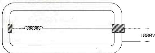
Il gas contenuto nell'interno del tubo è a pressione inferiore a quella atmosferica e quindi il tubo deve risultare perfettamente stagno all'aria.
