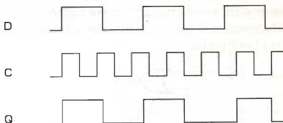
figura 7 - Oscillogrammi teorici relativi al funzionamento del D-LATCH.
