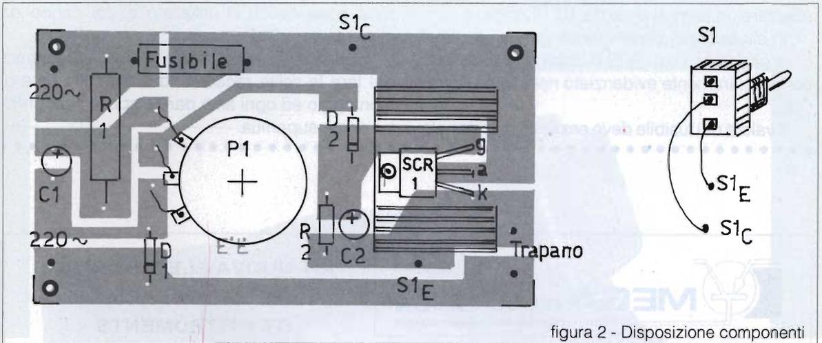
figura 2 - Disposizione componenti
