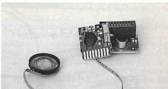
Un minuscolo circuito in grado di funzionare come riproduttore/registratore audio con tempo massimo di lavoro di 20 secondi. Utilizza una memoria EEPROM che mantiene i dati anche in assenza di tensione di alimentazione. Ideale per realizzare sistemi di teleallarme, avvisatori vocali per uso automobilistico, registratori digitali per le più svariate applicazioni.
