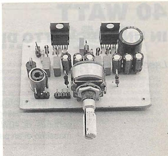
Non sono infatti necessari che pochi componenti esterni, poiché il TDA7240 racchiude già al suo interno tutto quanto è necessario per il funzionamento, ivi compresi i componenti del circuito di reazione e protezione.
