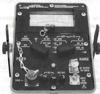
Millivoltmetro elettronico Ballantine AN/USM-413 in dotazione all'Air Force, 6 portate da 5 mV a 500 V fondo scala. Frequenza di lavoro da 10Hz a 1 MHz. Impedenza di ingresso 10 MΩ. Alimentazione 115/220 V o c.c. con batterie Ni-Cd entrocontenute (caricatore interno). Sonda, accessori, manuale tecnico. Nuovi £ 160.000(i.v.a. comp.)
