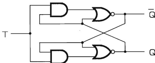
figura 9 - T-LATCH. Schema logico.
