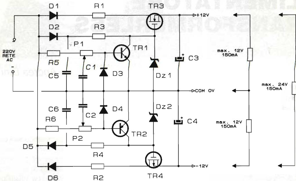
figura 2 - Schema elettrico
