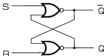
figura 1 - LATCH SET-RESET realizzato con porte NOR.
