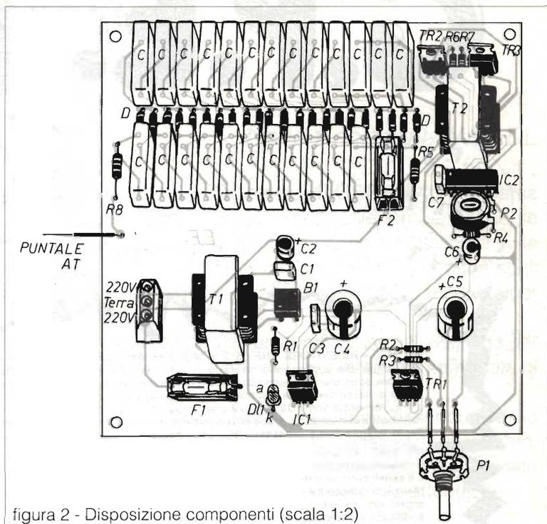
figura 2 - Disposizione componenti (scala 1:2)
