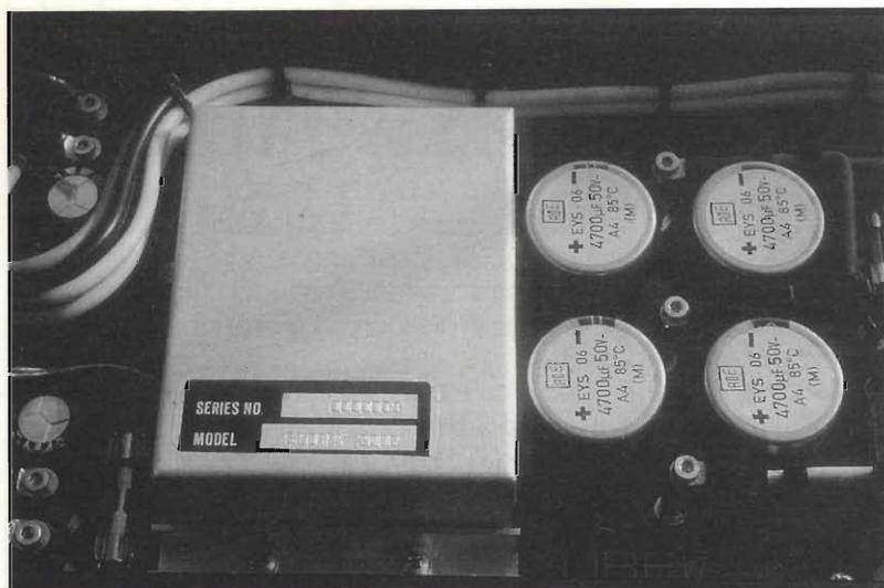
Assolutamente superdimensionate le capacità di filtro per l'inverter.
