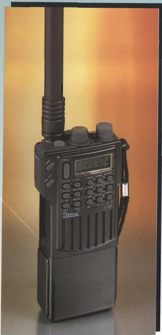
Ricetrasmittitore VHF - FM portatile funzionante in banda radioamatoriale dei due metri (144÷146 MHz) di dimensioni veramente contenute. Provvisto di ampio display per visualizzare le seguenti funzioni:
