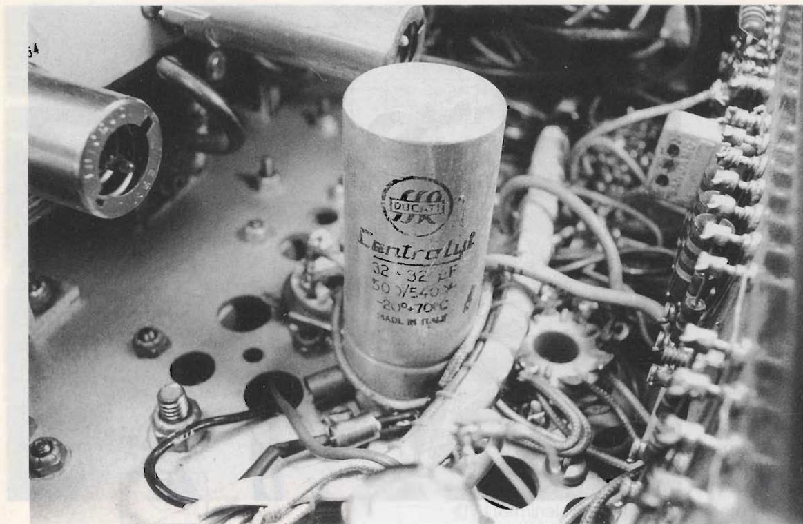
figura 7 - Il condensatore da  $32+32\mu\text{F}$  500Vl, (alla sua base si intravede il diodo da 3A dentro un'aletta di raffreddamento).
