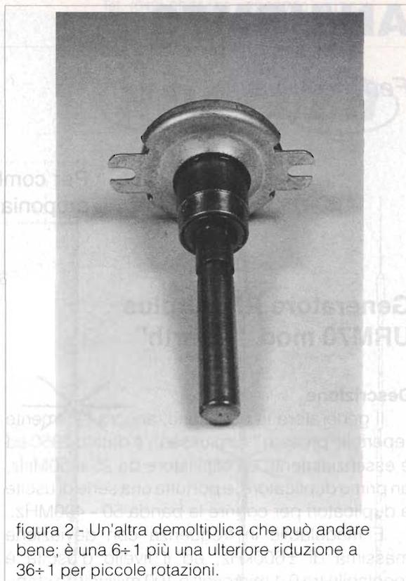
figura 2 - Un'altra demoltiplica che può andare bene; è una 6+1 più una ulteriore riduzione a 36+1 per piccole rotazioni.
