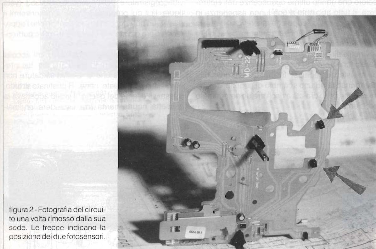
figura 2 - Fotografia del circuito una volta rimosso dalla sua sede. Le frecce indicano la posizione dei due fotosensori.
