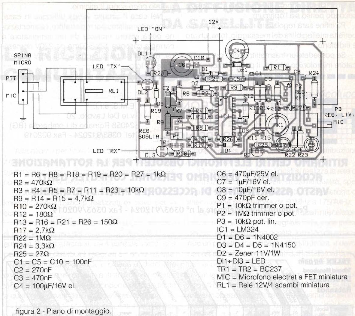
figura 2 - Piano di montaggio.
