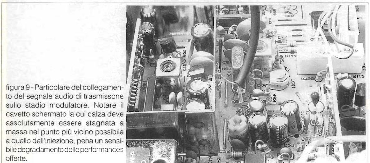
figura 9 - Particolare del collegamento del segnale audio di trasmissione sullo stadio modulatore. Notare il cavetto schermato la cui calza deve assolutamente essere stagnata a massa nel punto più vicino possibile a quello dell'iniezione, pena un sensibile degradamento delle performances offerte.
