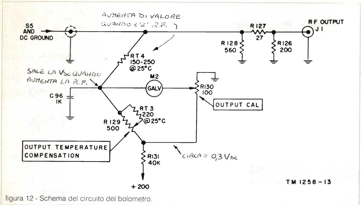
figura 12 - Schema del circuito del bolometro.
