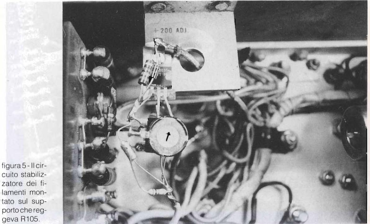
figura 5 - Il circuito stabilizzatore dei filamenti montato sul supporto che reggeva R105.
