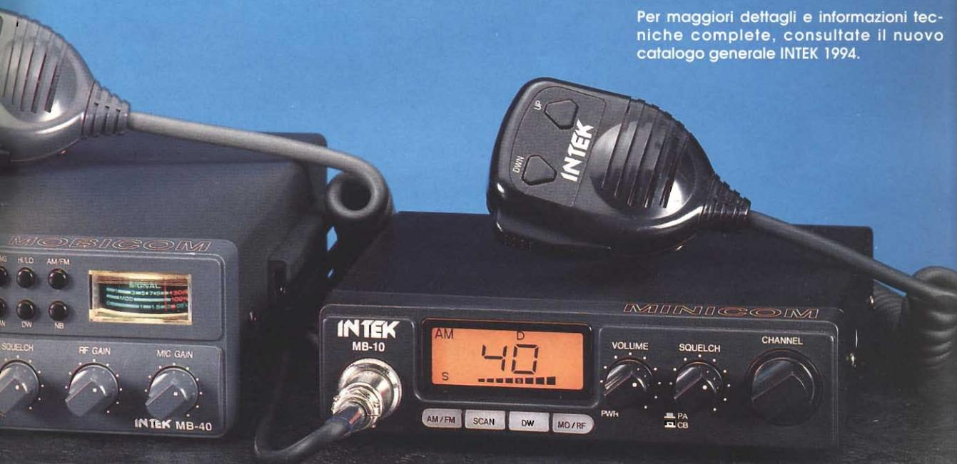
per potenza RF e modulazione. Inoltre potenza RF regolabile, selezione canali da microfono Up/Down o da commutatore, filtro a quarzo, mixer bilanciato a FET. Stadio finale tipo SSB da 15 Watt input (+) e modulatore potenziato.
