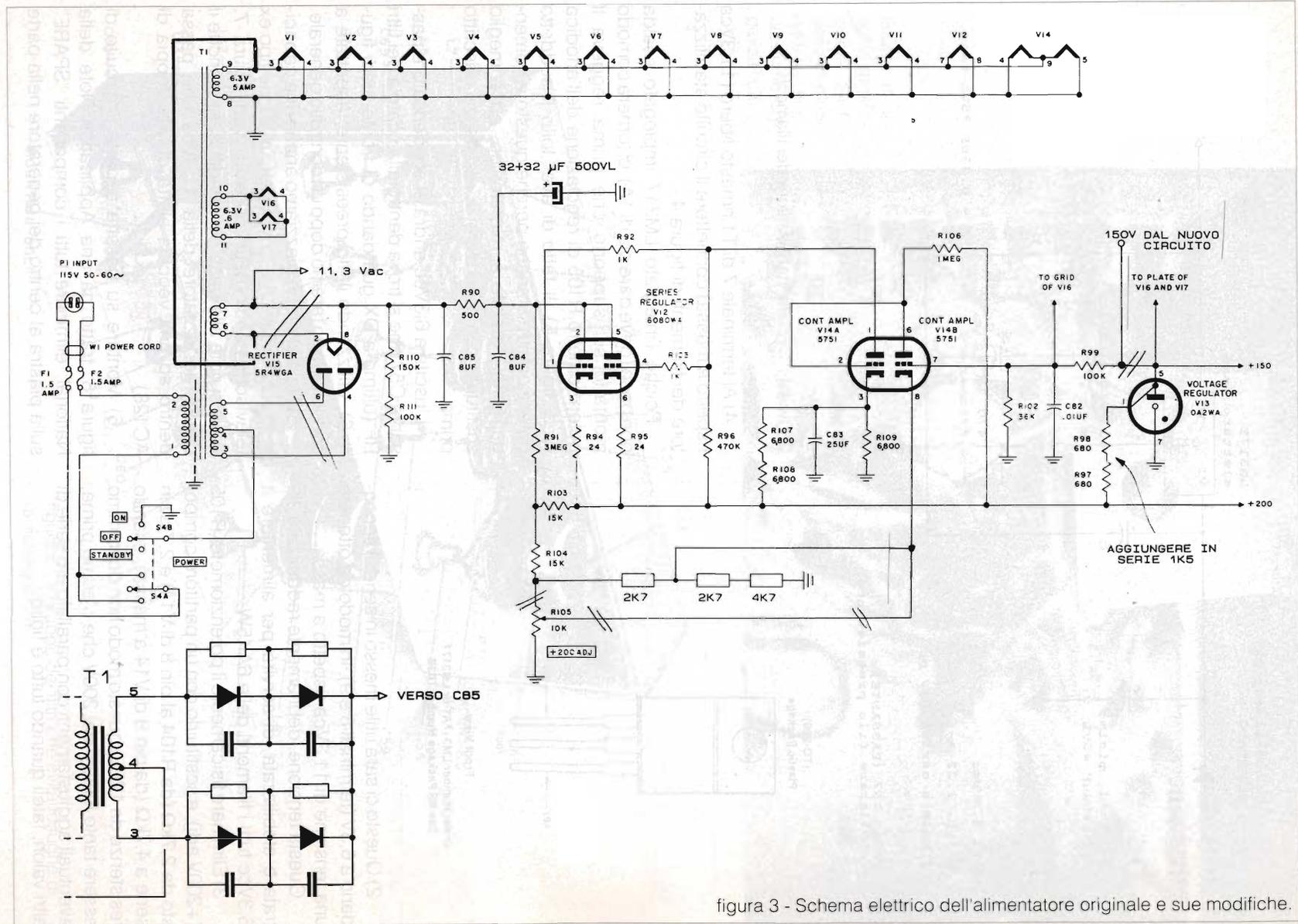
figura 3 - Schema elettrico dell'alimentatore originale e sue modifiche.
