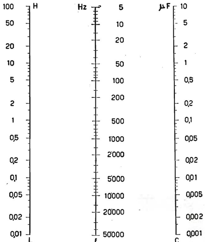
**FREQUENZA DI RISONANZA DI UN CIRCUITO OSCILLANTE (media frequenza)**
