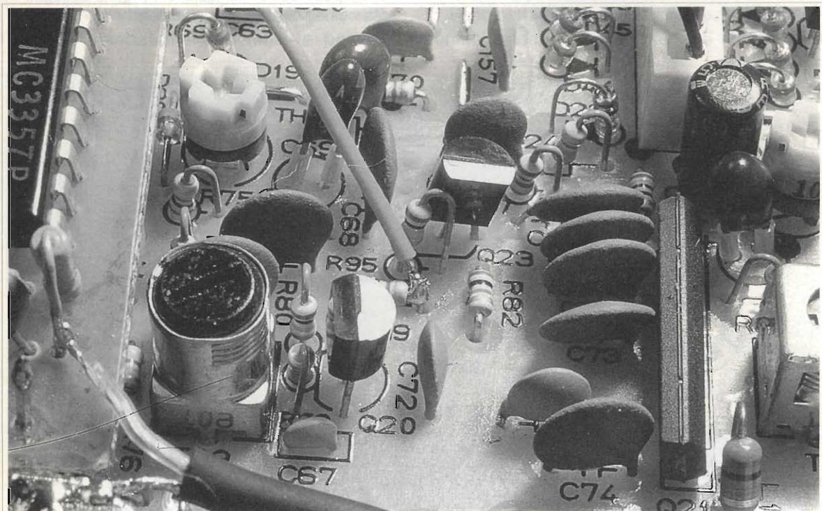
figura 6 - Particolare di collegamento dell'alimentazione positiva sulla piastra del ricevitore del 736. Il collegamento relativo alla massa non è visibile, in quanto effettuato al di sotto della piastrina.
