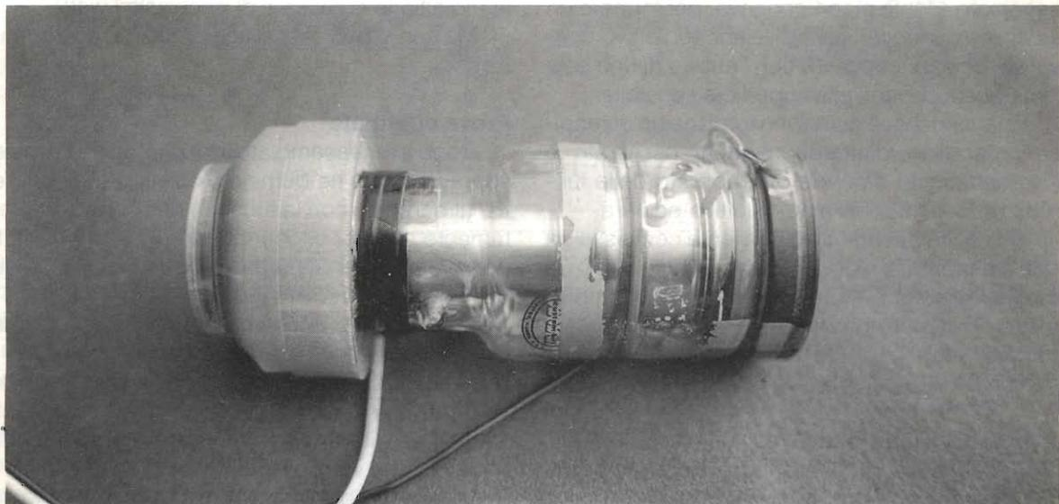
lizzato, similmente a quanto avviene nei tubi televisivi o negli oscilloscopi: a questo compito provvede un terzo elettrodo intermedio in funzione di lente elettronica, a sua volta posto ad un potenziale positivo abbastanza elevato.
