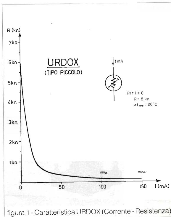
figura 1 - Caratteristica URDOX (Corrente - Resistenza).
