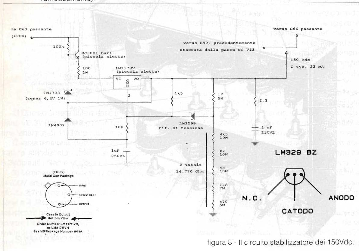
figura 8 - Il circuito stabilizzatore dei 150Vdc.
