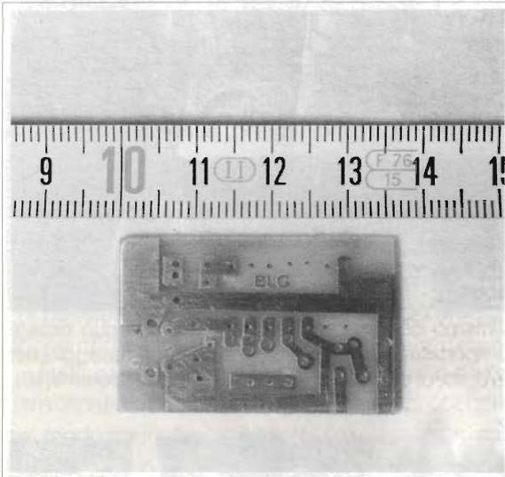
lissimo circuito stampato realizzato in vetronite, il cui disegno in grandezza naturale è visibile in figura 3.
