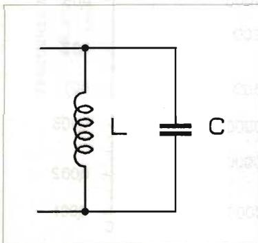
Si ha un condensatore (C) di valore ignoto connesso in parallelo ad una induttanza (L) di valore sconosciuto.
