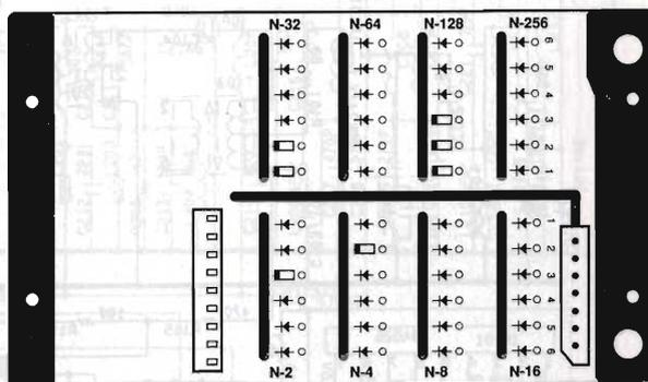
L'apparecchio viene fornito con i sei canali programmati sulle frequenze utilizzabili per i punti 1/2/3/4/7 art. 334 C.P. è però possibile variare tali frequenze per meglio adeguare l'apparecchio alle proprie esigenze.
