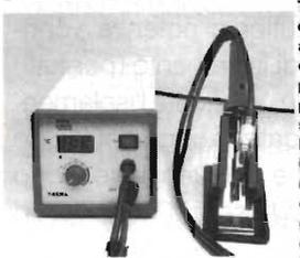
Termostata elettronicamente con regolazione zero-crossing tramite sensore a termocoppia. Sul display a led (3 digit) è possibile leggere la temperatura effettiva dell'ugello. La pompa aspirante a motore provoca una depressione immediata che avviene premendo il pulsante sul corpo del dissaldatore, senza ritardi di risposta.
