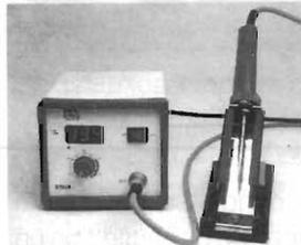
Termostata elettronicamente con regolazione zero-crossing tramite sensore a termocoppia. Sul display a led 3 1/2 digit è possibile leggere la temperatura effettiva della punta.
