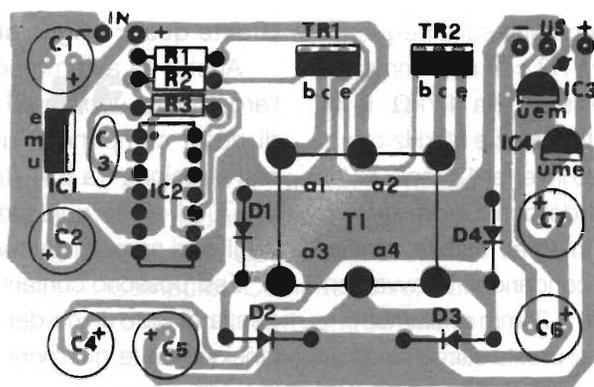
figura 2 - Disposizione componenti.
