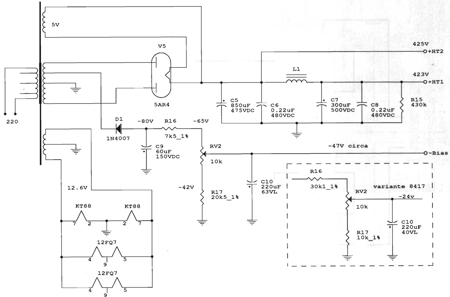
figura 4 - La sezione "power supply"; notare le differenze della versione con 8417.
