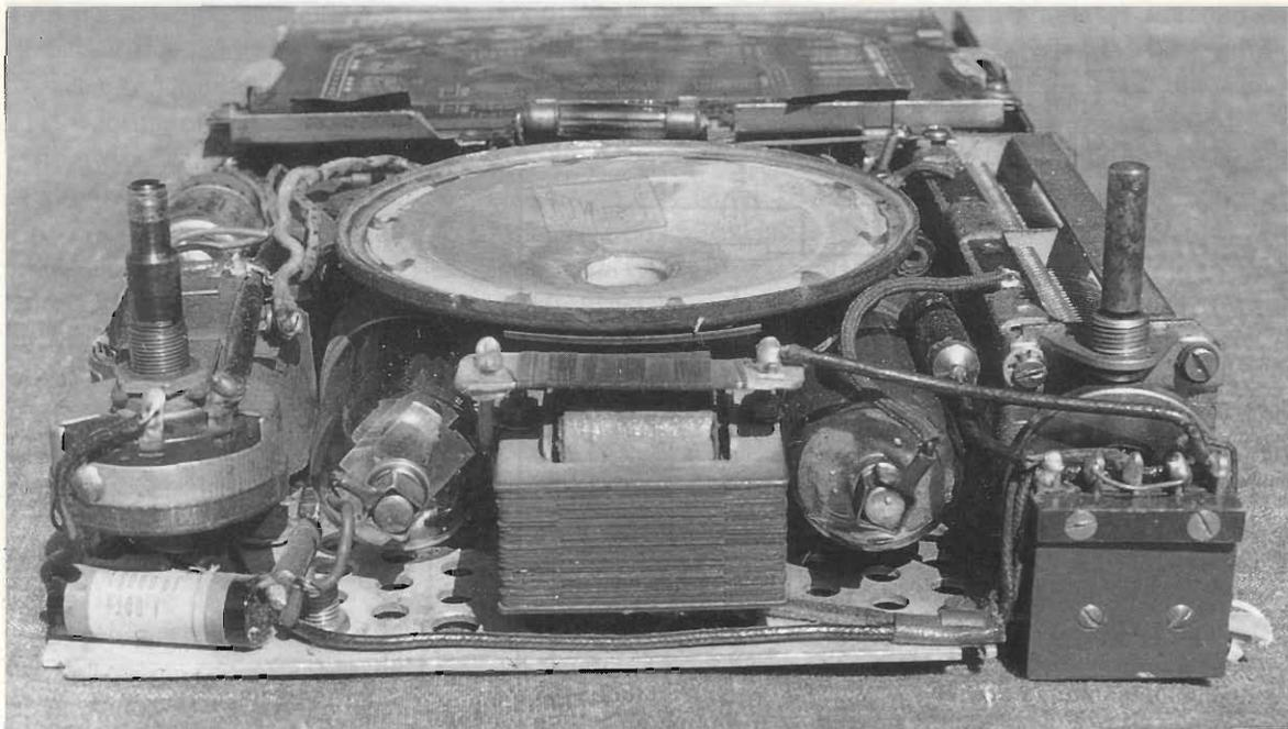
Può apparire strano che la sintonia sulle OM richiede un valore di capacità massima più piccola di quello necessario per la copertura della gamma OC, di frequenza notevolmente più alta.
