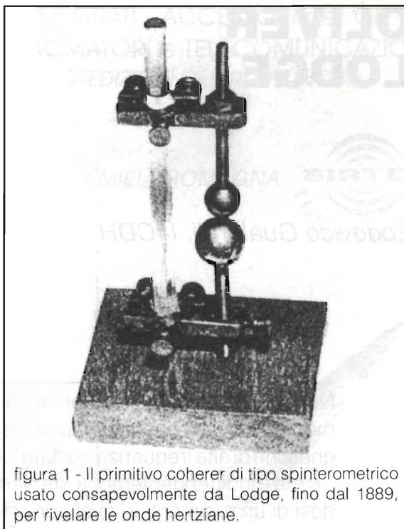
figura 1 - Il primitivo coherer di tipo spinterometrico usato consapevolmente da Lodge, fino dal 1889, per rivelare le onde hertziane.
