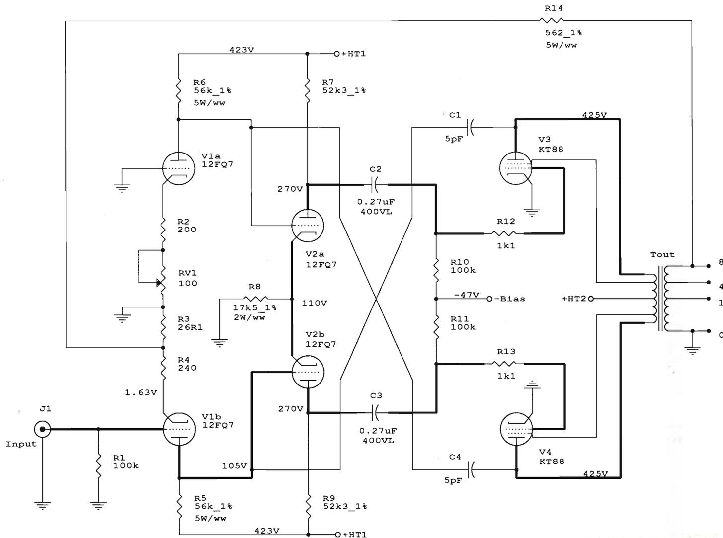
figura 3 - Lo schema elettrico della versione con KT88.
