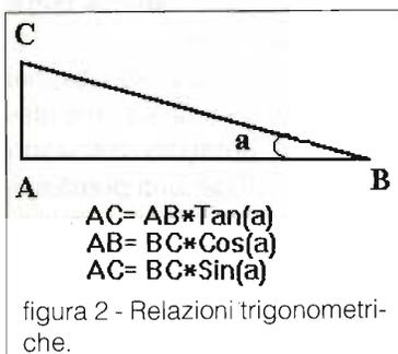
Dopo aver ritagliato il triangolo, appoggerete il cateto maggiore ovvero AB alla staffa del polar mount e regolerete le viti dei supporti fino a che il sostegno di fissaggio della parabola sarà parallelo all'ipotenusa del triangolo, ovvero, se il triangolo è abbastanza grande e la distanza tra le due superfici sufficientemente piccola, a contatto con questa.
