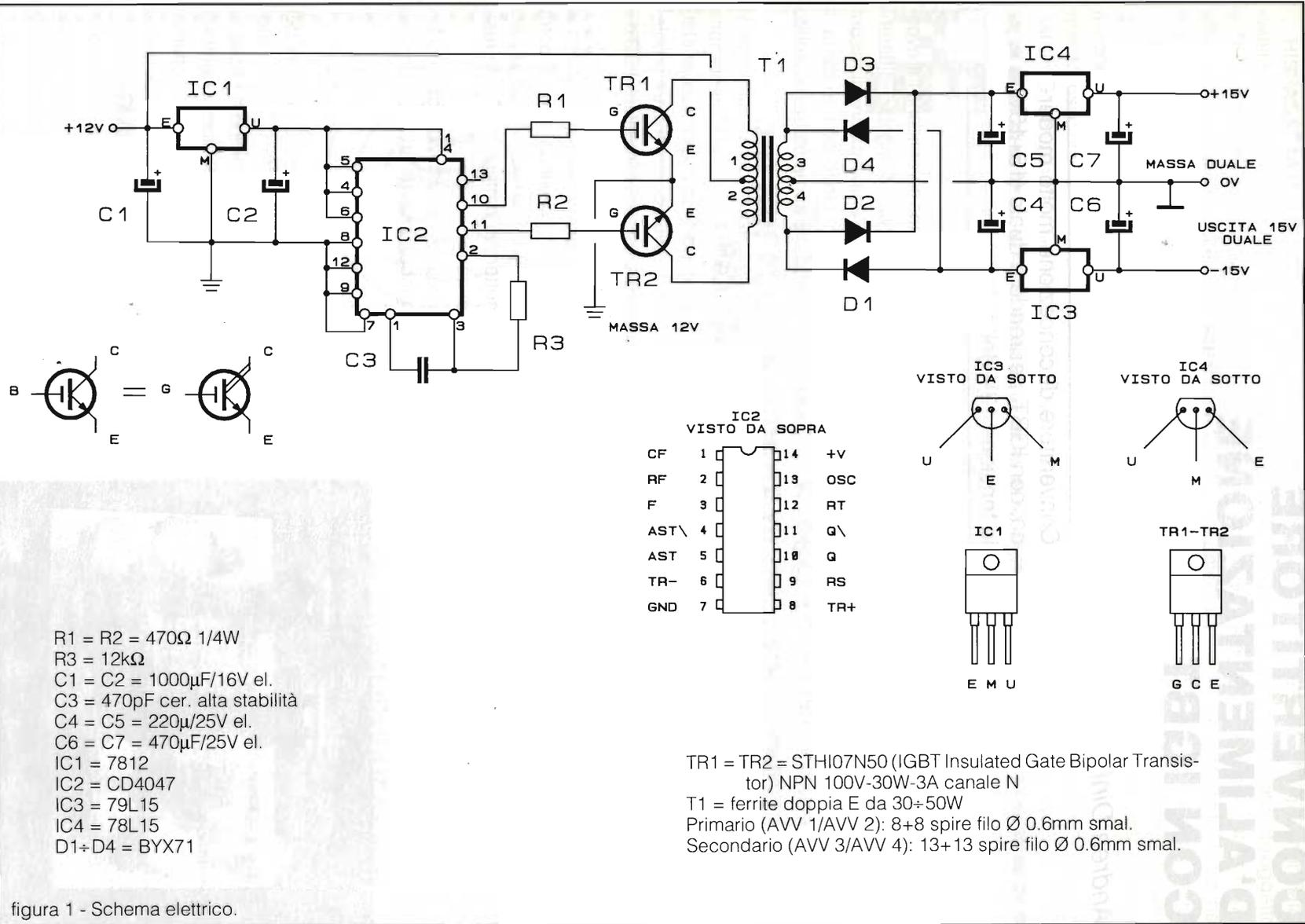
figura 1 - Schema elettrico.
