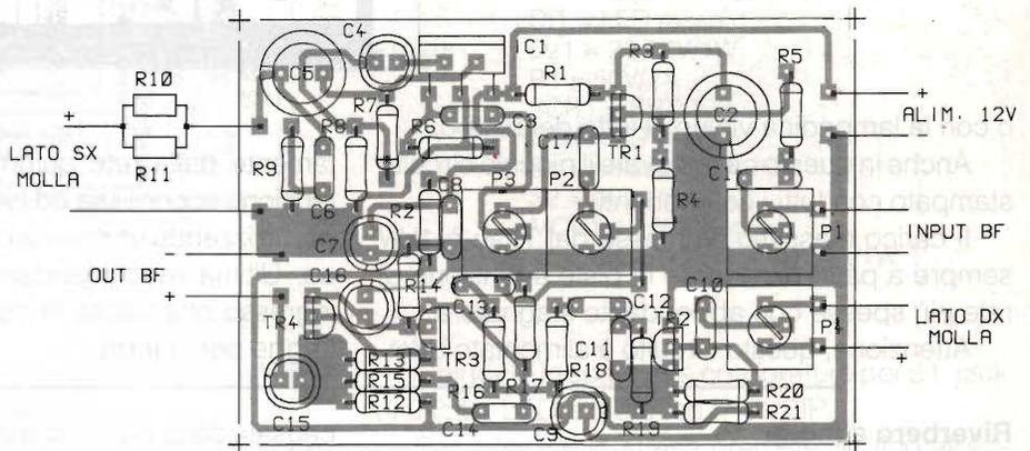
pilotaggio testina/molla (da regolare una tantum); P4 = sensibilità preamplificatore di uscita.
