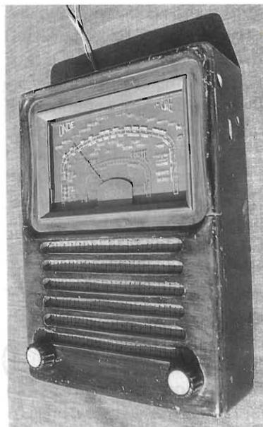
eterodina a 5 valvole Octal, con due gamme d'onda, altoparlante a bobina di campo e alimentazione a rete-luce con trasformatore: tutti i componenti su elencati hanno dimensioni non trascurabili e tali da lasciare ben poco spazio tra loro, una volta assemblati.
