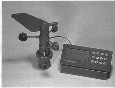
Il montaggio è estremamente semplificato: l'unità di rivelazione del vento utilizza un sensore brevettato a bassa impedenza (senza potenziometro) ed un esclusivo sistema di puntamento al Nord, nonché un semplicissimo e resistente attacco al palo, senza necessità di chiavi od altri attrezzi.
