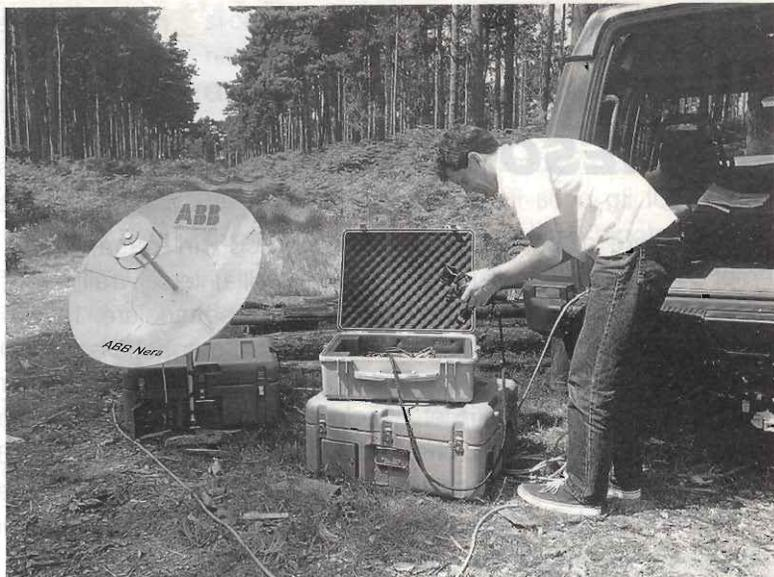
Bastano dieci minuti per montare e attivare il sistema di telepresenza via satellite CAMNET.
