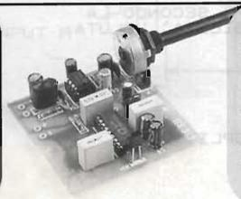
Serve a ricevere e convertire in segnali audio gli impulsi a RAGGI INFRAROSSI trasmessi in PWM dall'RS 348. L'alimentazione deve essere fornita tramite una batteria da 9 V per radioline e l'assorbimento massimo è di circa 80 mA. Per l'ascolto occorre collegare all'uscita una qualsiasi cuffia con impedenza compresa tra 4 e 100 Ohm. Il dispositivo è dotato di controllo volume e può essere alloggiato nel contenitore plastico LP 462 il quale è completo di vano batterie.
