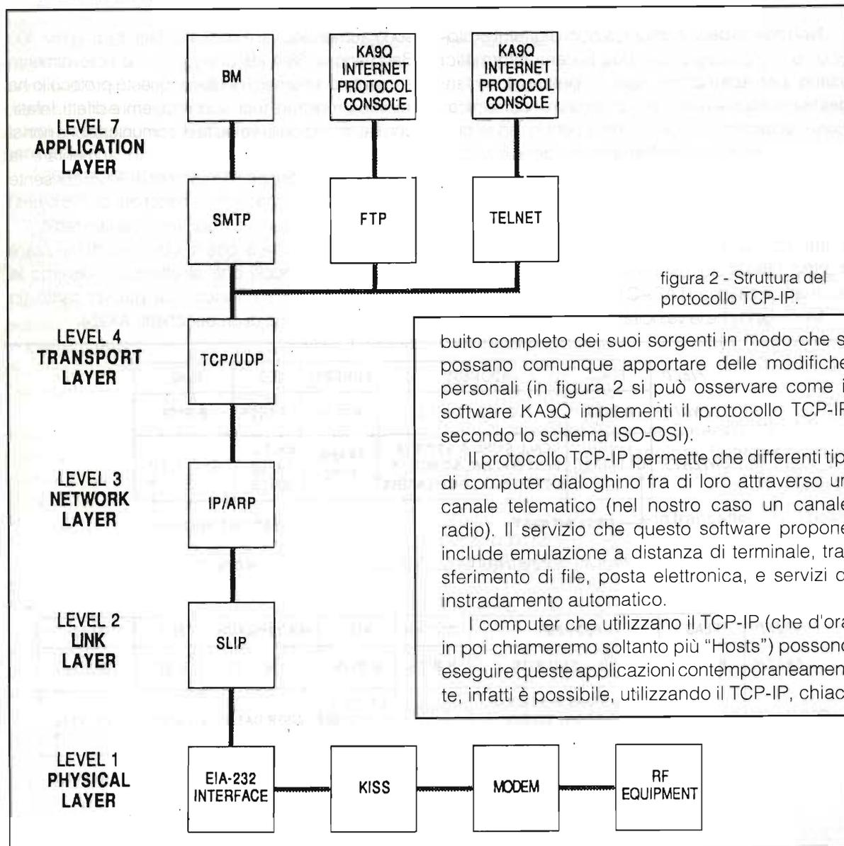
figura 2 - Struttura del protocollo TCP-IP.
