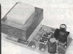
E' un particolare alimentatore DEDICATO che serve ad alimentare fino a cinque moduli RS 350 diventando quindi PARTE INTEGRANTE di un MIXER LUCI a più canali. Il KIT è completo di ogni sua parte compreso il trasformatore di alimentazione. Collega l'RS 350 alla tensione di rete a 220 Vca e gli fornisce una tensione stabilizzata di 15 V per il suo funzionamento.
