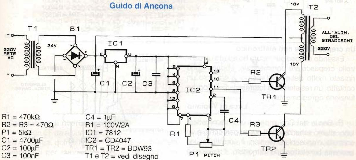
te un integrato regolatore. Le uscite del 4047, complementari tra loro pilotano un push pull di Darlington connessi ad un trasformatore 18+18V/220 che alimenta il motore del giradischi. P1 regola la velocità di rotazione.
