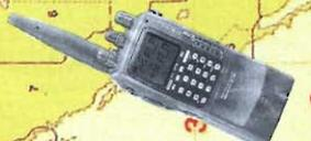
**IC W21 e IC W21ET** - Bibanda palmare 5W
