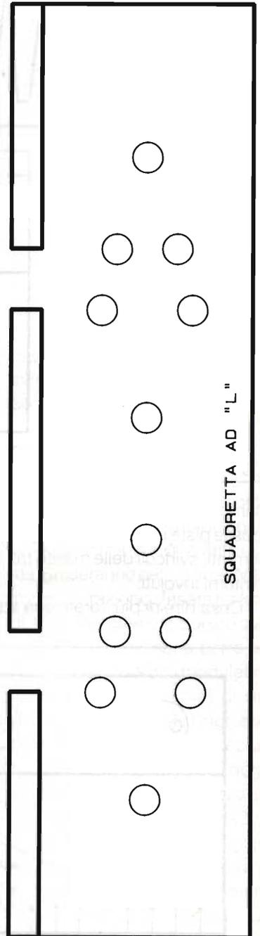
figura 2c - Aletta di accoppiamento al dissipatore.
