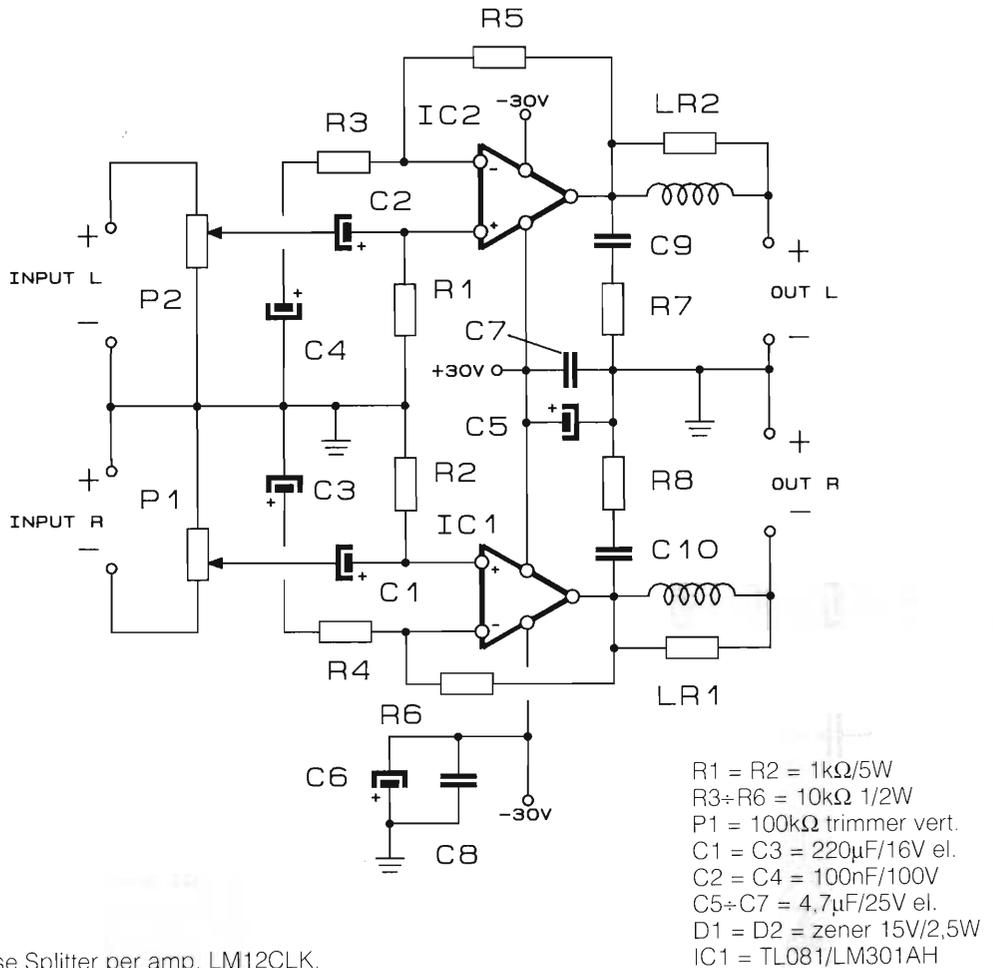
figura 5 - Phase Splitter per amp. LM12CLK.
