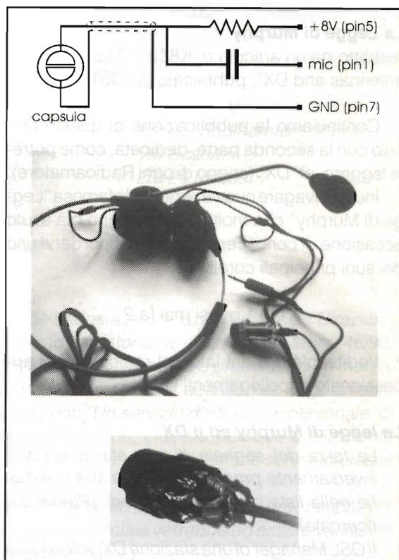
Sul pin5 della presa microfonica sono presenti 8 V, prelevati tramite R per alimentare la capsula con la giusta corrente; C conduce la BF al pin1 separandola dalla CC; infine la calza è collegata alla massa dell'apparato (pin7).
