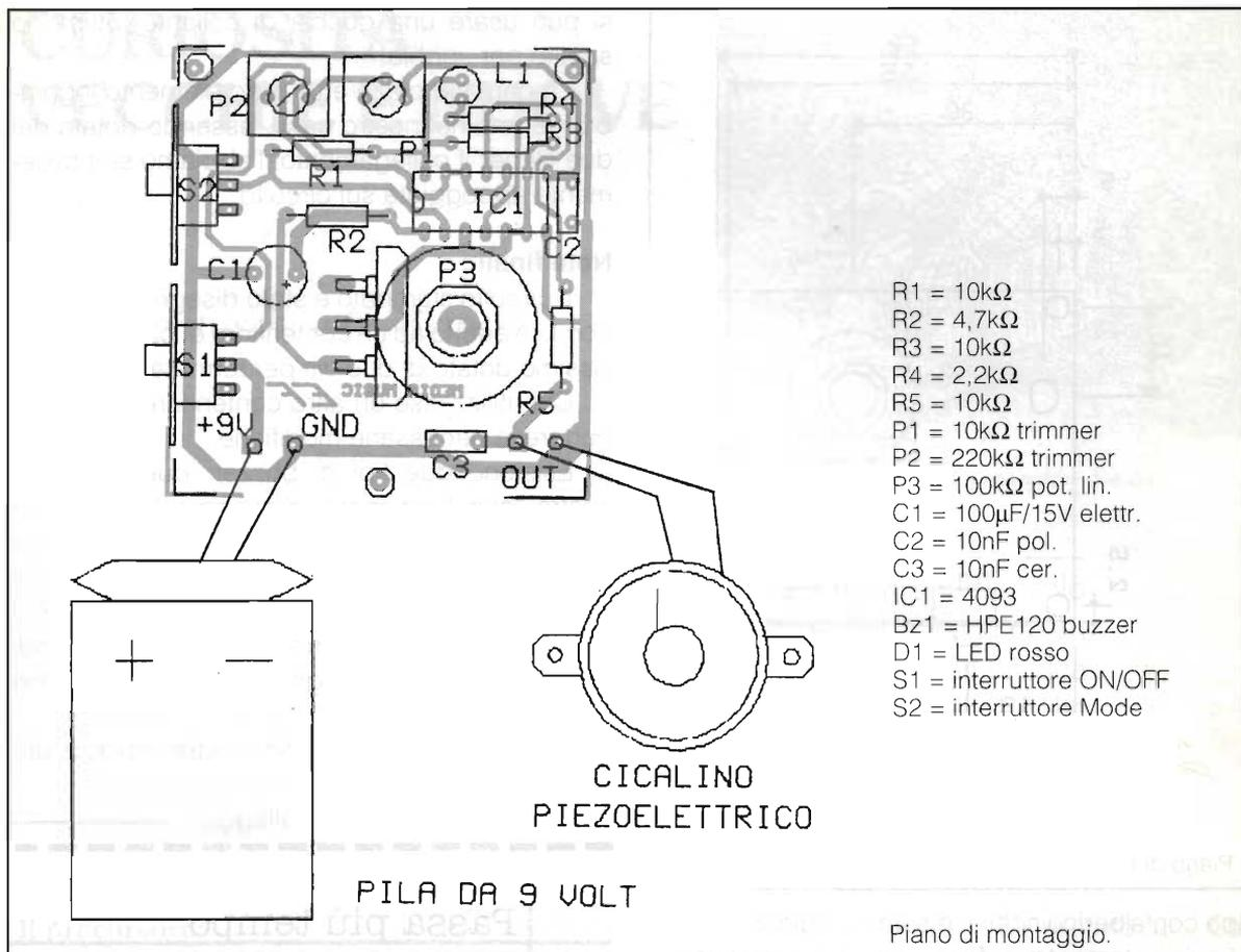
Quando invece S2 è aperto - *open* - la resistenza R2 fornisce un "uno" consentendo quindi la libera oscillazione del circuito imbastito attorno ad IC1A che va a modulare l'oscillatore in modo da ottenere l'effetto metronomo. In pratica l'oscillatore a 440Hz è sempre in funzione ma subordinato all'uscita di IC1A.
