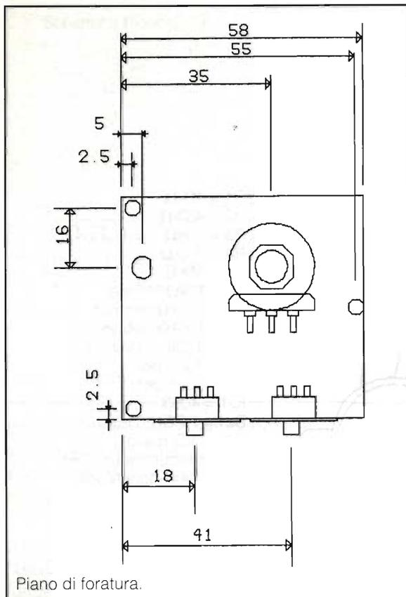
tipo con alberino sottile, è saldato rigidamente al circuito stampato e fuoriesce dalla scatola in modo da permettere la regolazione del tempo.
