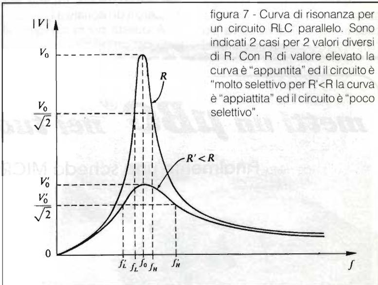
figura 7 - Curva di risonanza per un circuito RLC parallelo. Sono indicati 2 casi per 2 valori diversi di R. Con R di valore elevato la curva è "appuntita" ed il circuito è "molto selettivo" per  $R' < R$  la curva è "appiattita" ed il circuito è "poco selettivo".
