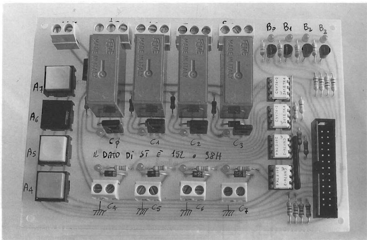
fa capo al PORT C ed esattamente a C0, C1, C2, C3; un fotoaccoppiatore doppio provvede poi a separare i relè che vengono pilotati da un transistor darlington di tipo BD679 o similare.
