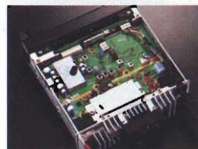
Robusta costruzione e notevole semplificazione nel progetto per maggiore facilità di manutenzione
