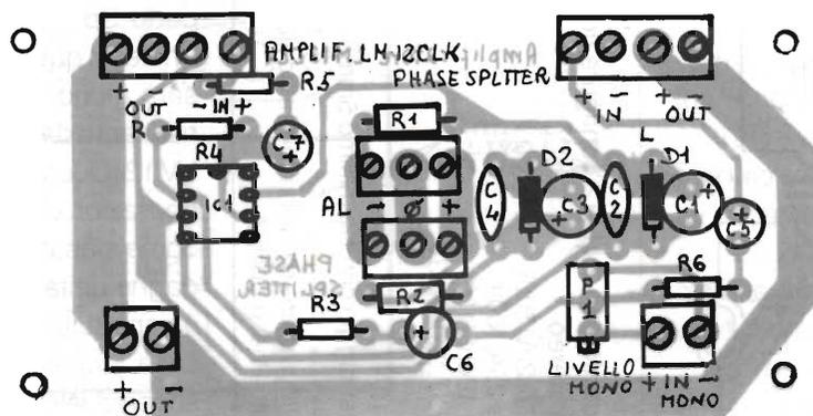
figura 6 - Disposizione componenti del Phase Splitter.
