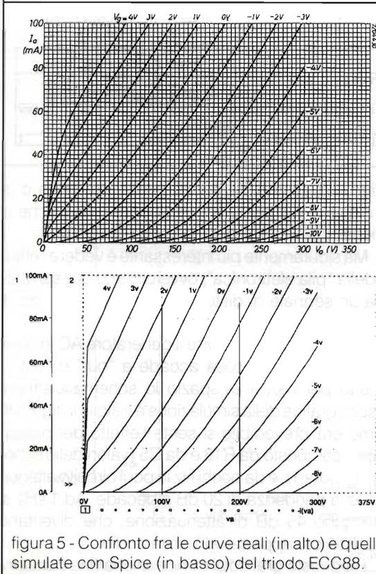
figura 5 - Confronto fra le curve reali (in alto) e quelle simulate con Spice (in basso) del triodo ECC88.
