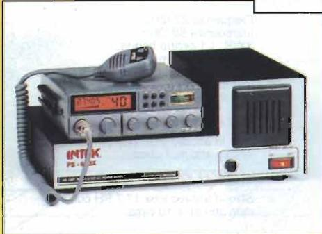
Dimensioni compatibili con tutti i tipi di ricetrasmittitori mobili in commercio, protezioni in neoprene sull'area di appoggio dell'apparato, protezione elettronica contro cortocircuiti, sovraccarichi e radiofrequenza.
