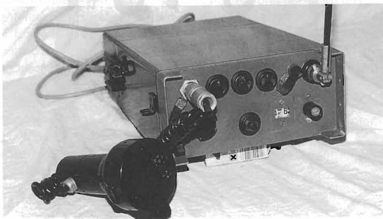
Foto 8 - RTx UF 435: 60 canali / 45,600-47,075 MHz.
