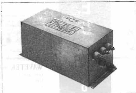
Filtri trifase doppia cella che assicurano un'ottima attenuazione in rete fino a 120 A. Impiego in reti trifasi fortemente disturbate e in presenza di piccoli e medi inverter, azionamenti cc e altre apparecchiature a sinusoide commutata. Il circuito è studiato in modo da assicurare una robusta attenuazione delle interferenze sia con carico bilanciato che sbilanciato.
