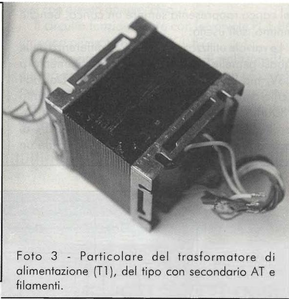
Foto 3 - Particolare del trasformatore di alimentazione (T1), del tipo con secondario AT e filamenti.
