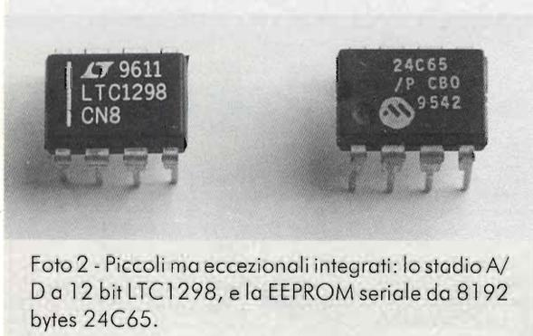
Foto 2 - Piccoli ma eccezionali integrati: lo stadio A/D a 12 bit LTC1298, e la EEPROM seriale da 8192 bytes 24C65.
