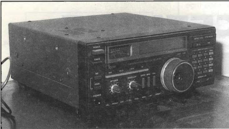
figura 2 - L'RX Icom IC R72 utilizzato per la ricezione del meteofax.
