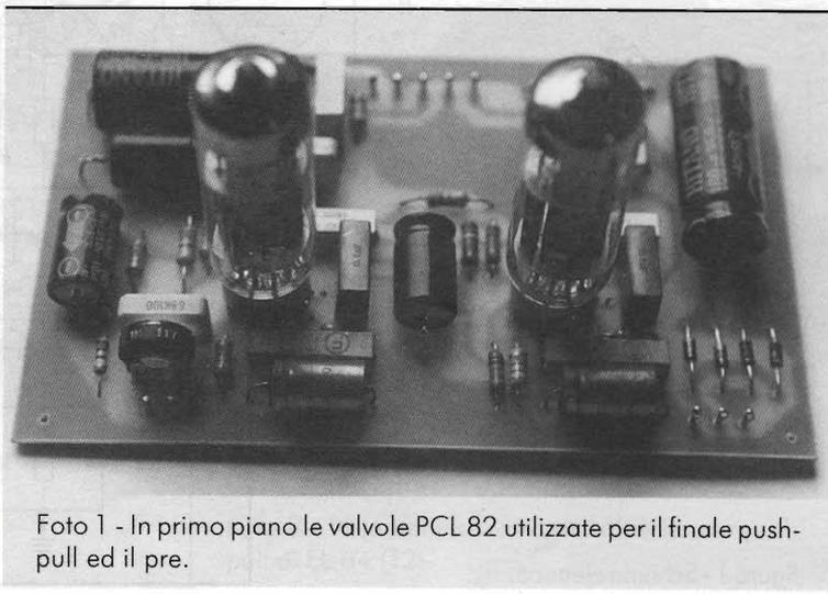
Foto 1 - In primo piano le valvole PCL 82 utilizzate per il finale push-pull ed il pre.
