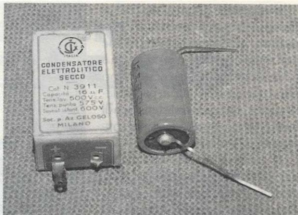
Foto 4 - Condensatore elettrolitico a pacchetto GeloSO anni '35/60, del quale si recupera il contenitore per inserirci dentro il nuovo elettrolitico.
