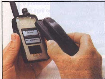
Semplice montaggio e smontaggio batteria
