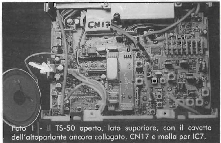
Foto 1 - Il TS-50 aperto, lato superiore, con il cavetto dell'altoparlante ancora collegato, CN17 e molla per IC7.
