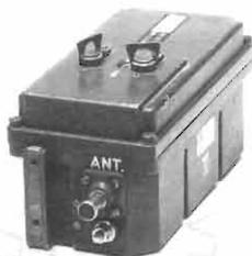
Potenza 50 W circa, frequenza 26 ÷ 70 MHz. Molto interessante la meccanica con 2 motorini a 24 Vdc, ingranaggi, relè, ecc. Connettori d'uscita BNC femmina. Dimensioni cm 10x10x22, peso Kg 2,7.
