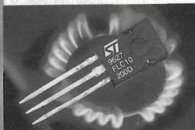
Al suo interno racchiude un tristore che gestisce la fase di scarica, un diodo zener che imposta il valore di soglia, un rettificatore e una resistenza per la limitazione della corrente, ma per saperne di più citate il rif. 71/97/SGS-THOMSON-P230T rivolgendovi a:
