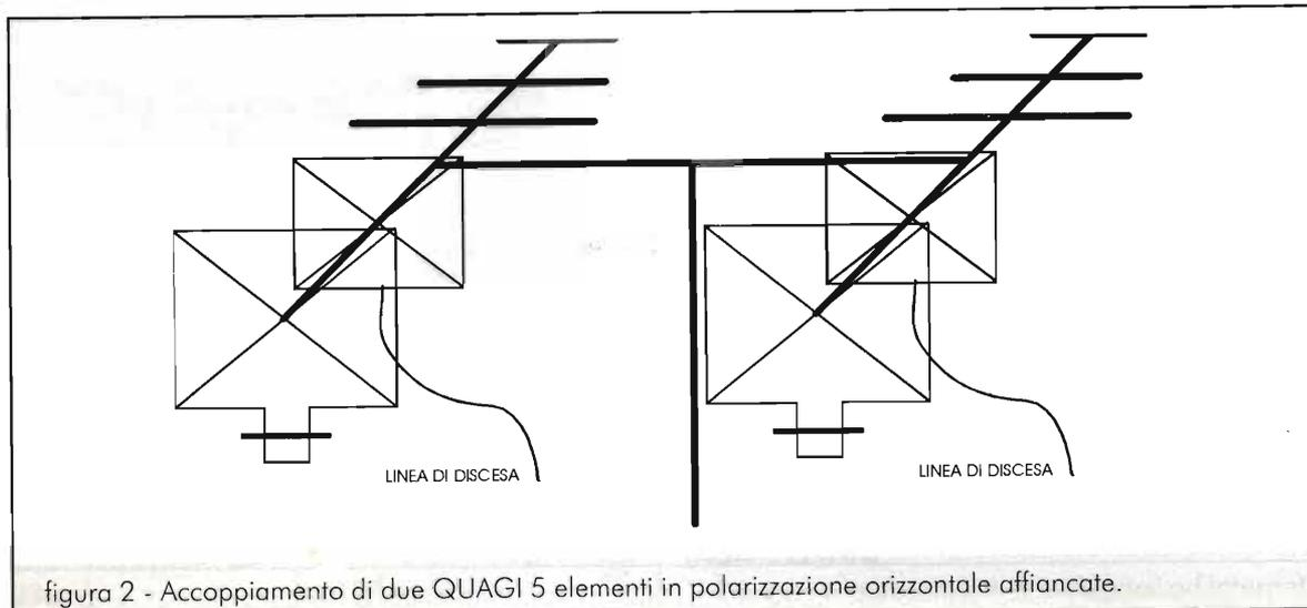
figura 2 - Accoppiamento di due QUAGI 5 elementi in polarizzazione orizzontale affiancate.
