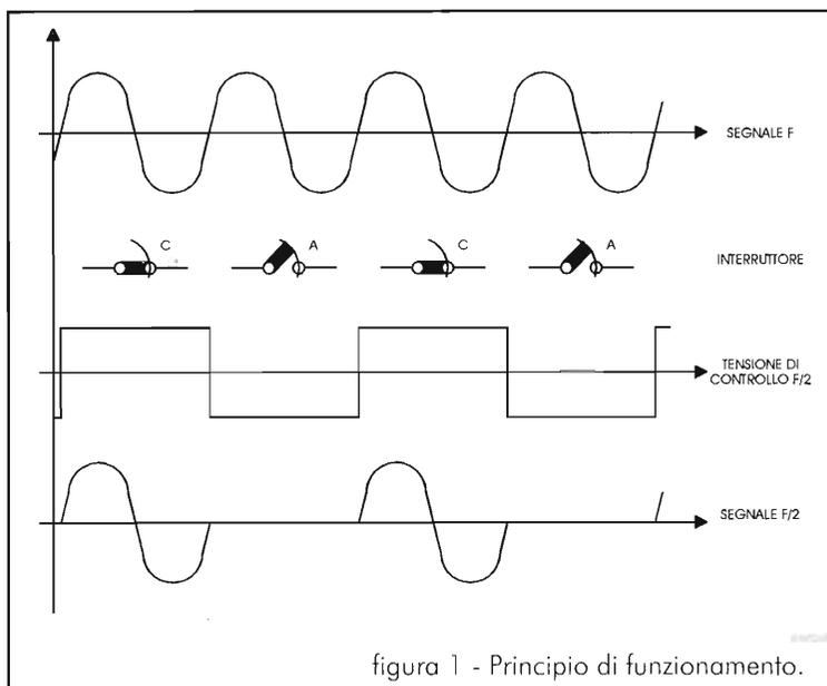
figura 1 - Principio di funzionamento.
