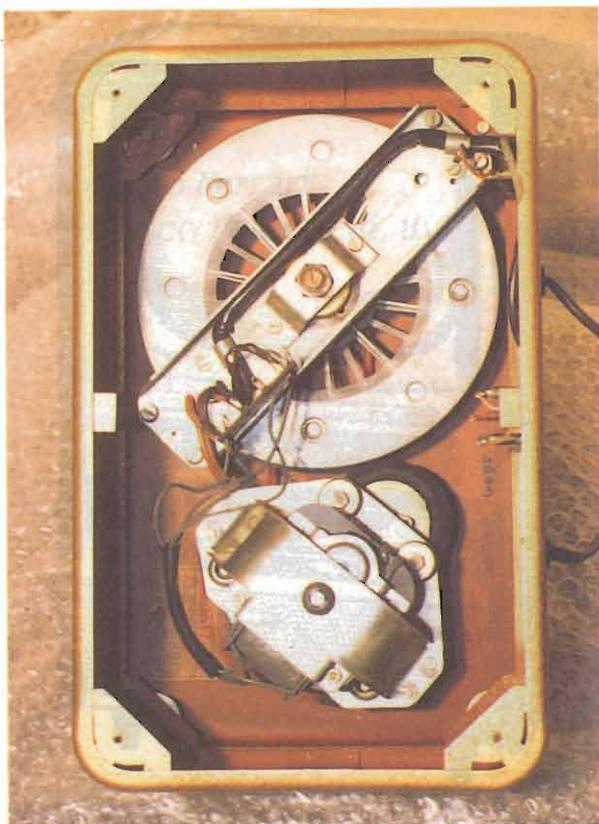
Foto 6 - Il motore e il grosso volano stabilizzatore.
