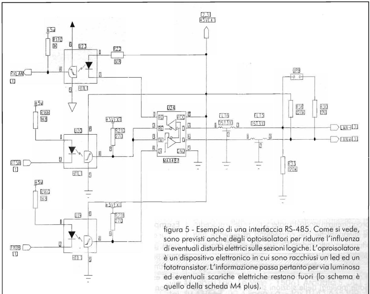
figura 5 - Esempio di una interfaccia RS-485. Come si vede, sono previsti anche degli optoisolatori per ridurre l'influenza di eventuali disturbi elettrici sulle sezioni logiche. L'optoisolatore è un dispositivo elettronico in cui sono racchiusi un led ed un fototransistor. L'informazione passa pertanto per via luminosa ed eventuali scariche elettriche restano fuori (lo schema è quello della scheda M4 plus).
