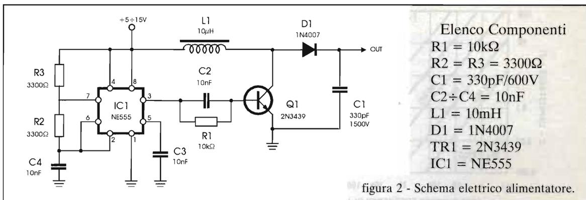
figura 2 - Schema elettrico alimentatore.
