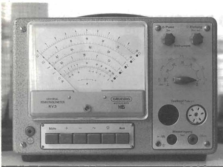
il forte sbilanciamento del ponte quando la valvola non ha ancora raggiunto il regime normale di funzionamento o la mancanza di stabilità, per cui è necessaria una regolazione continua dello zero.
