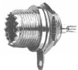
figura 3 - Presa coassiale da pannello tipo SO-239, con pagliuzza di massa, fissaggio a vite e isolamento in Delrin.
