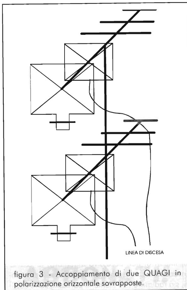
figura 3 - Accoppiamento di due QUAGI in polarizzazione orizzontale sovrapposte.
