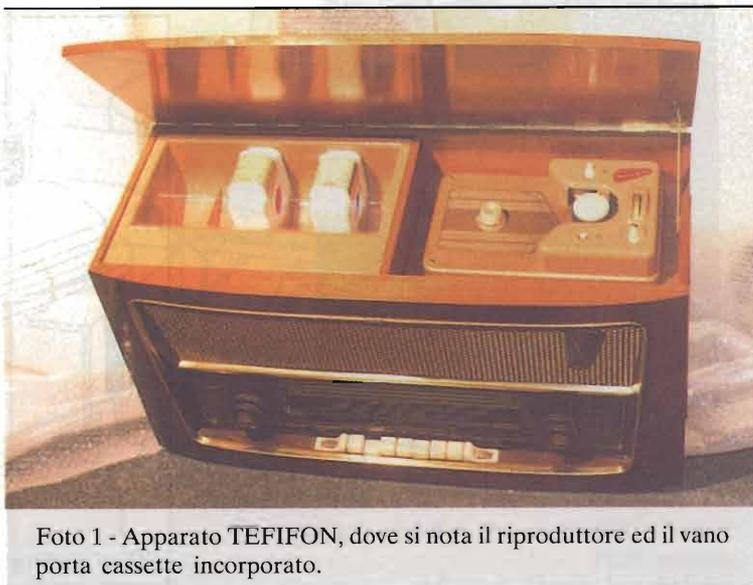
Foto 1 - Apparato TEFIFON, dove si nota il riproduttore ed il vano porta cassette incorporato.
