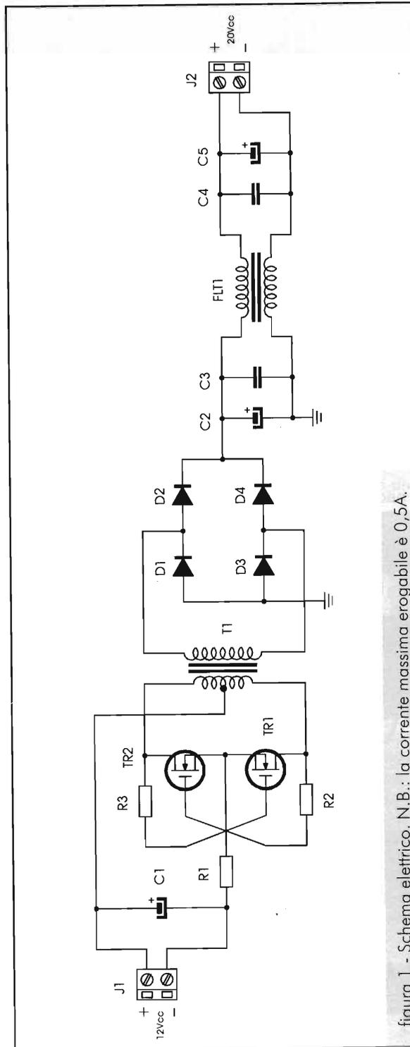
figura 1 - Schema elettrico. N.B.: la corrente massima erogabile è 0,5A.
