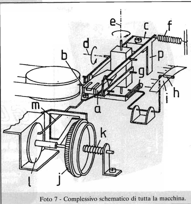
Foto 7 - Complessivo schematico di tutta la macchina.
