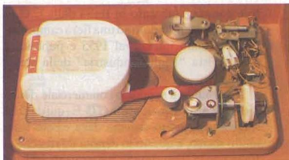
Foto 8 - Il riproduttore "TEFI" messo a nudo: si può notare la meccanica di lettura.
