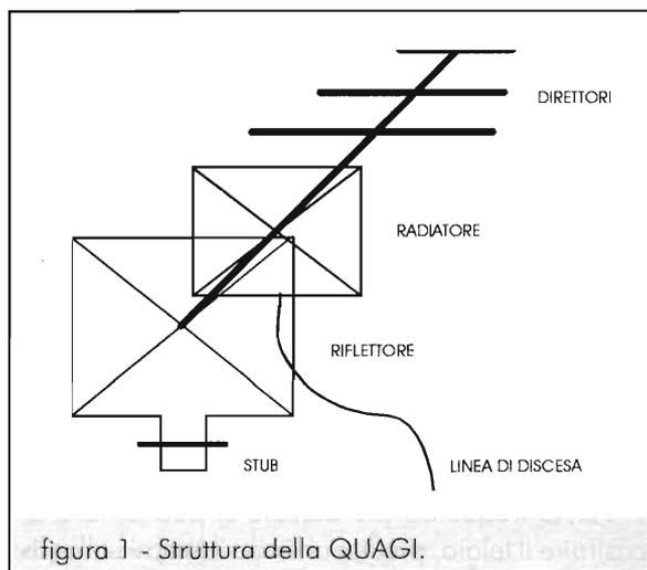
figura 1 - Struttura della QUAGI.
