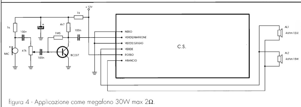
figura 4 - Applicazione come megafono 30W max 2Ω.
