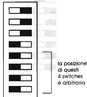
Rimontare lo sportellino/filtro e spostare gli interruttori S2 e S3 nella posizione superiore. Riempire una metà del contenitore plastico del dosimetro con acqua pulita (non contaminata) fino al bordo e posizionare il dosimetro su questo recipiente.
