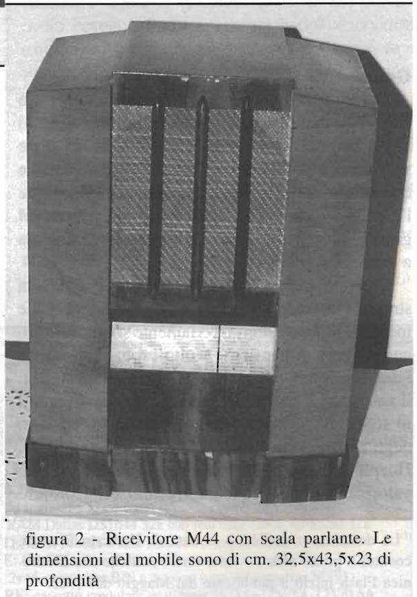
figura 2 - Ricevitore M44 con scala parlante. Le dimensioni del mobile sono di cm. 32,5x43,5x23 di profondità
