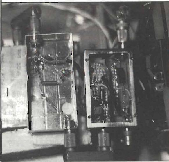
Foto 2 - Particolare degli stadi separatore/modulatore e attenuatore d'uscita.
