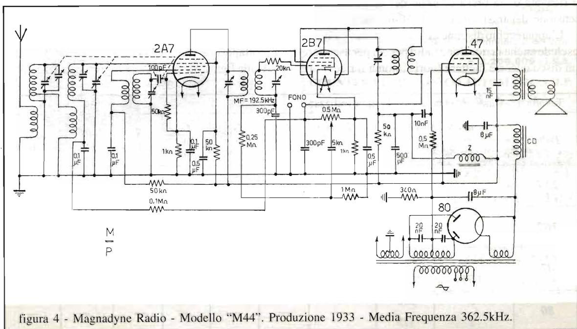
figura 4 - Magnadyne Radio - Modello "M44". Produzione 1933 - Media Frequenza 362.5kHz.
