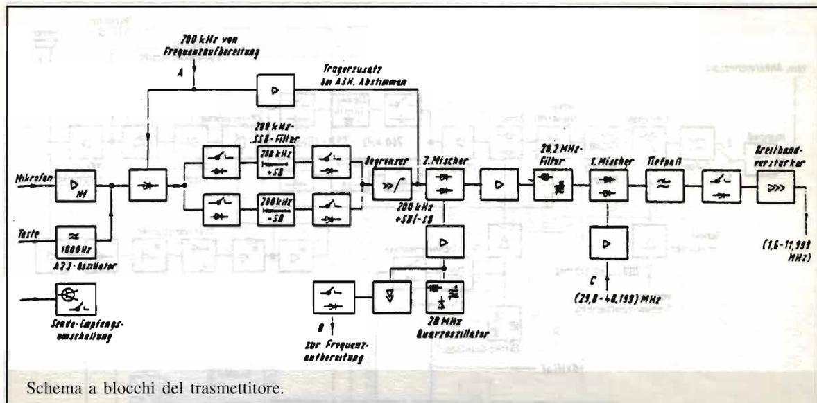
Schema a blocchi del trasmettitore.
