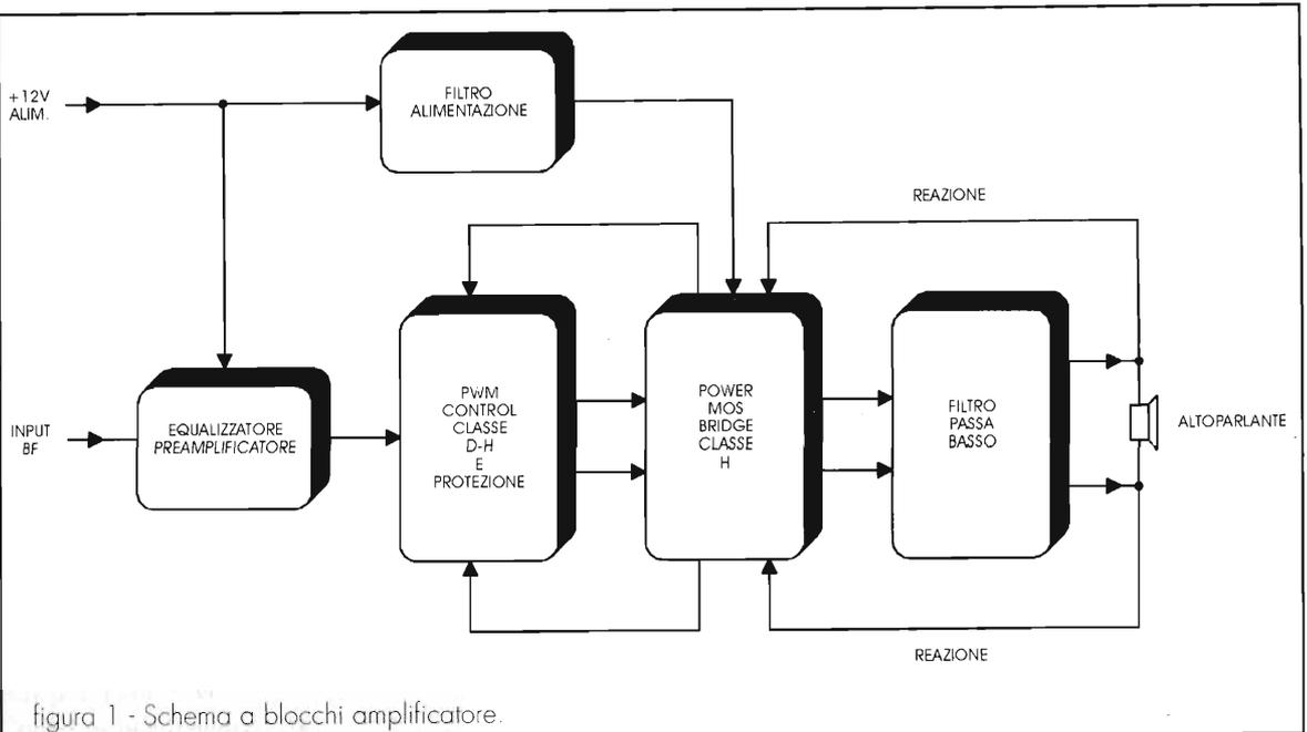
figura 1 - Schema a blocchi amplificatore.
