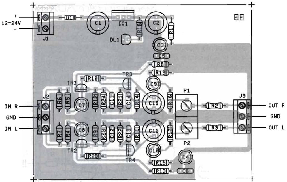
no tra ingresso e testina un preamplificatore ad hoc, detto RIAA, con una curva di risposta adatta a tale pick up. Col passare del tempo tutti i compatti Hi-Fi furono dotati di ingresso magnetico a basso livello ma ora, con l'avvento dei CD player molti compatti hanno solo presa AUX medio livello non adatta ai giradischi con testina magnetica, ecco perché questo circuito è tornato in auge più che mai!
