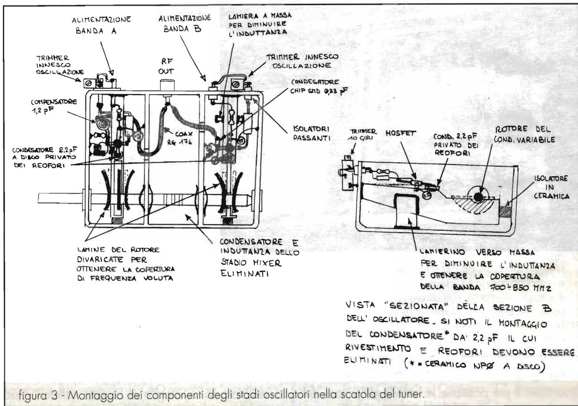
figura 3 - Montaggio dei componenti degli stadi oscillatori nella scatola del tuner.
