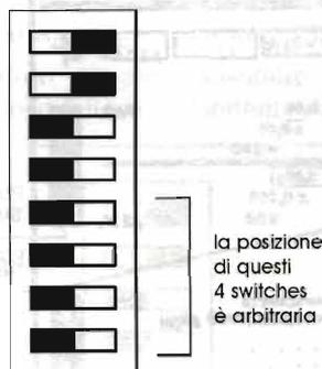
Chiudere lo sportellino/filtro e spostare S2 e S3 nella posizione superiore. Accendere lo strumento con S1 (verso l'alto). Dopo circa 28 secondi lo strumento produrrà un tono audio intermittente ad indicazione della fine del ciclo di misura e sul display apparirà un numero di 4 cifre. Il numero mostrato rappresenta il valore delle radiazioni gamma espresso in  $\mu\text{R}/\text{h}$ .
