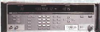
**Fluke 6060A/AN** - Generatore RF sintetizzato. Banda 10kHz/520MHz, step 10Hz. Oscillatore di riferimento TCXO. Livello di uscita da +13 a -127dBm (+15/-140 usabile). Ottima purezza spettrale. Modulazione AM e FM. Interfaccia HP-IB con funzioni di controllo master/slave. 10 memorie. Include un misuratore digitale di deviazione FM
