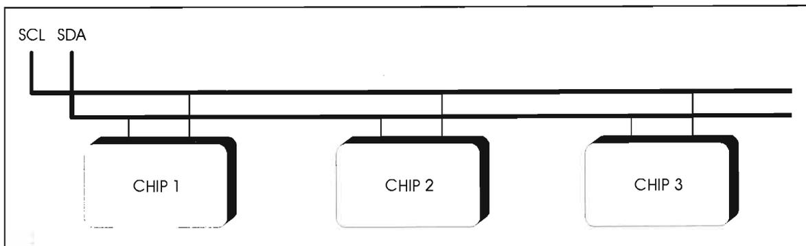
In figura vediamo come ogni periferica è connessa al bus IIC. SDA ed SCL sono connessi al positivo di alimentazione con resistori di pull-up, quindi, quando il bus è libero, entrambe le linee sono mantenute a livello alto.
