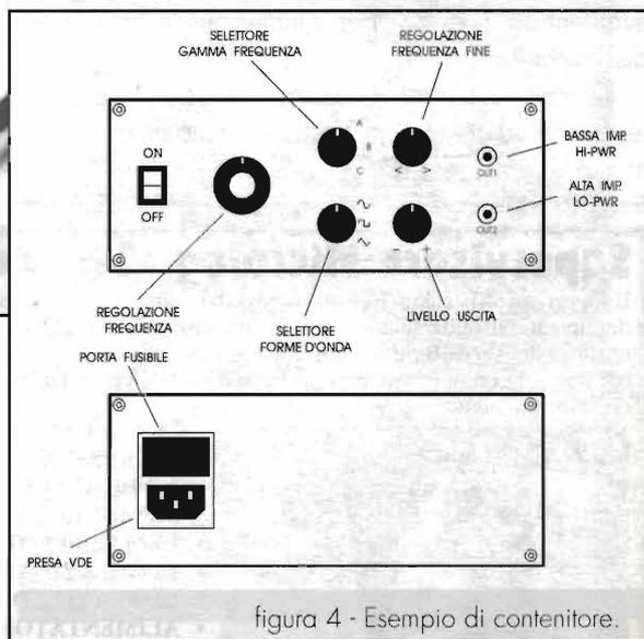
figura 4 - Esempio di contenitore.
