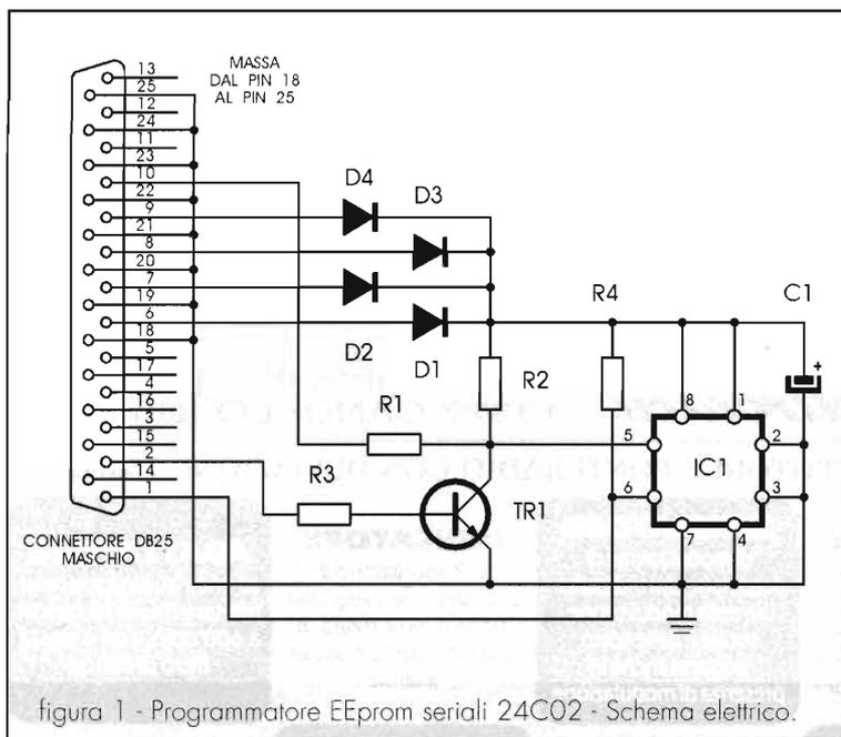
figura 1 - Programmatore EEprom seriali 24C02 - Schema elettrico.
