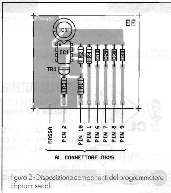
figura 2 - Disposizione componenti del programmatore EEprom seriali.
