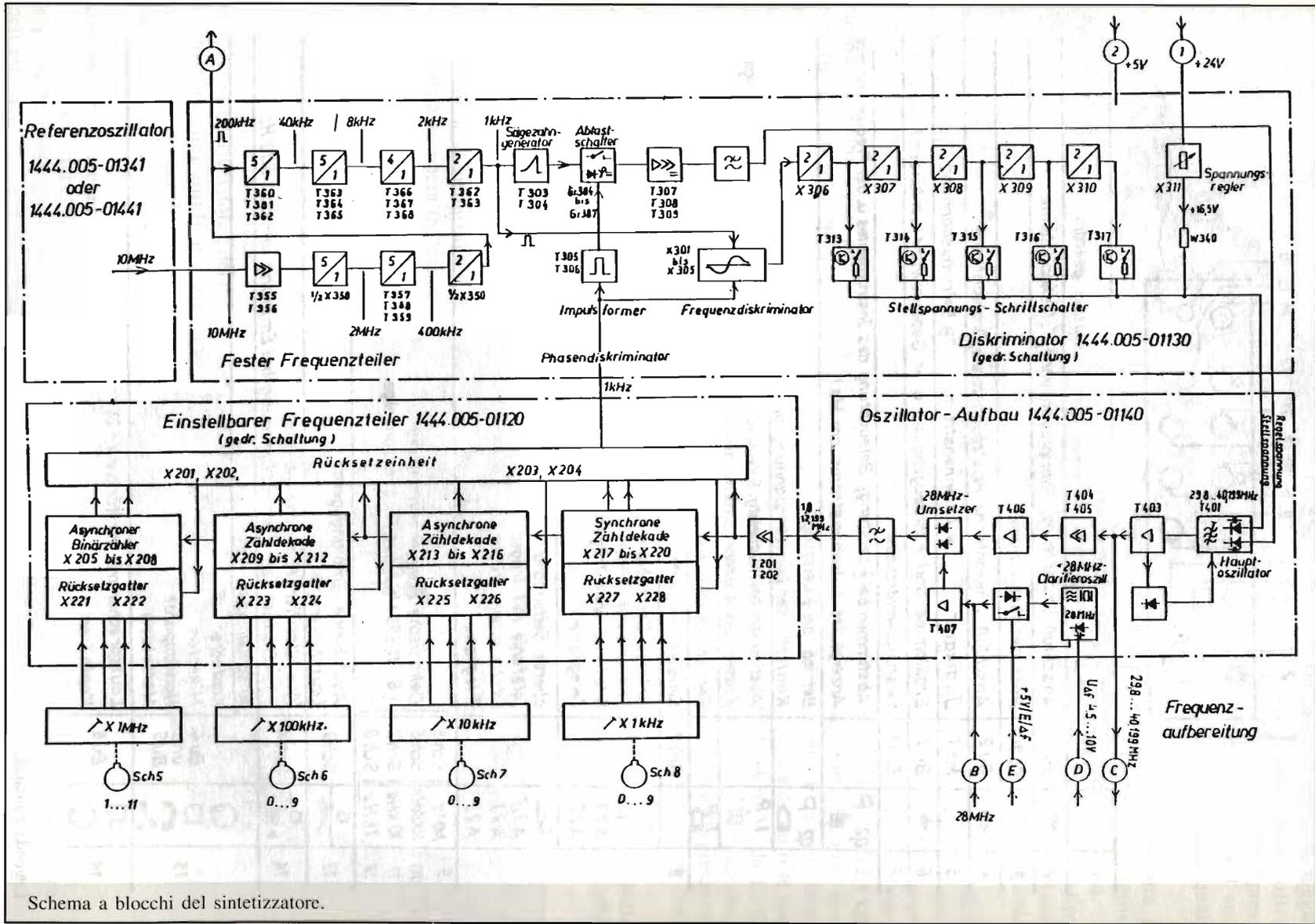
Schema a blocchi del sintetizzatore.
