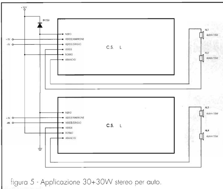
figura 5 - Applicazione 30+30W stereo per auto.
