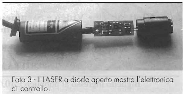
Foto 3 - Il LASER a diodo aperto mostra l'elettronica di controllo.
