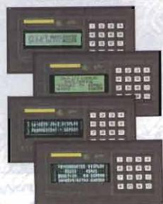
Pannello Operatore, a basso costo, con contenitore standard DIN da 96x192 mm. Disponibile con display LCD Retroilluminato o Fluorescente nei formati 2x20 o 4x20 caratteri; Tastiera da 16 tasti; comunicazione in RS 232, RS 422 o Current Loop; Buzzer; E<sup>2</sup> in grado di contenere fino a 100 messaggi; 4 ingressi optoisolati, acquisibili tramite la linea seriale ed in grado di rappresentare autonomamente 16 diversi messaggi.
