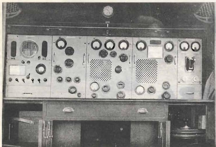
Foto 1 - Quadro di controllo delle alimentazioni e pannelli del trasmettitore e del ricevitore.
