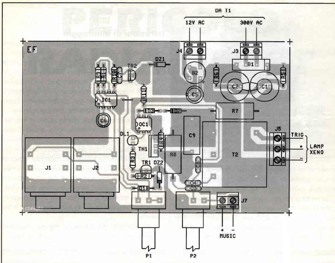
cemente mentre C4 lo fa attraverso R7. Ora, con C1/C2 e C4 carichi avremo superato la soglia di conduzione di D2 e D3 ( $33+33V=66V$  circa). Se OC1 riceve segnale tale da accoppiare otticamente il TRIAC interno avremo il pilotaggio del gate di TH1, con conseguente scarica di C4 sul primario di T2 che induce sul suo secondario, in salita, l'alta tensione necessaria al trigger della lampada strobo.
