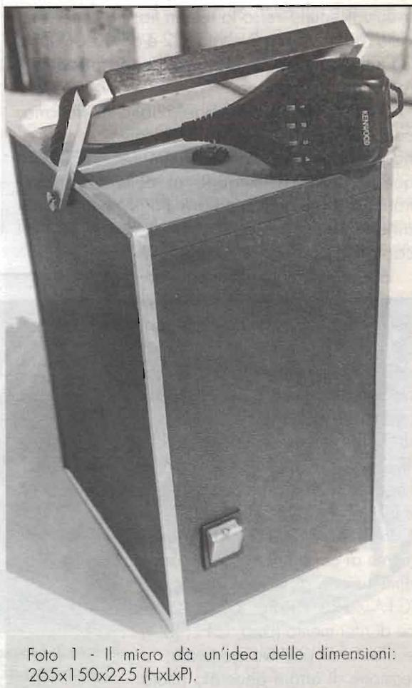
Foto 1 - Il micro dà un'idea delle dimensioni: 265x150x225 (HxLxP).
