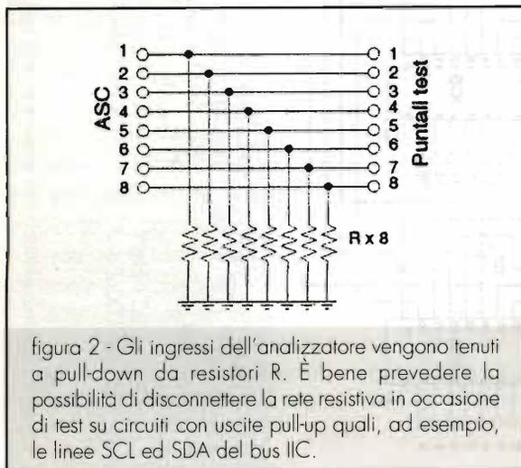
figura 2 - Gli ingressi dell'analizzatore vengono tenuti a pull-down da resistori R. È bene prevedere la possibilità di disconnettere la rete resistiva in occasione di test su circuiti con uscite pull-up quali, ad esempio, le linee SCL ed SDA del bus IIC.
