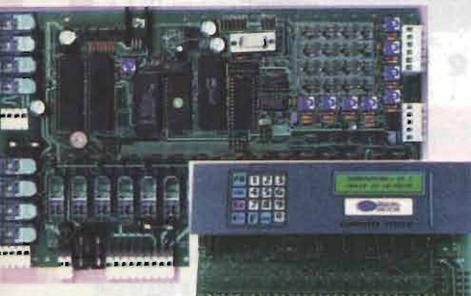
**DD24LCD** è un PLC completo e pronto all'uso realizzato con una scheda a microprocessore basata su Z84C00 con quarzo a 10 MHz.
