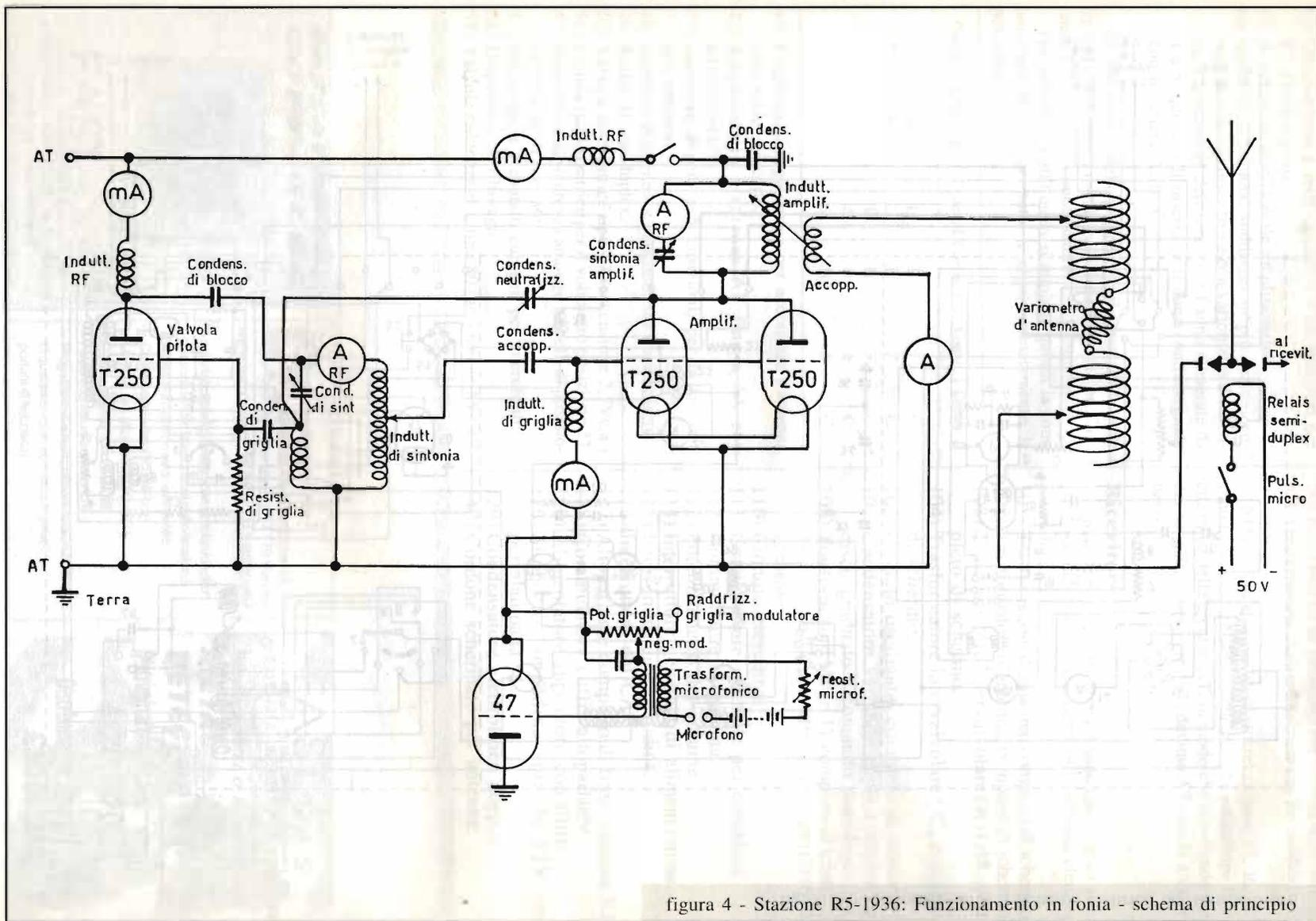
figura 4 - Stazione R5-1936: Funzionamento in fonia - schema di principio
