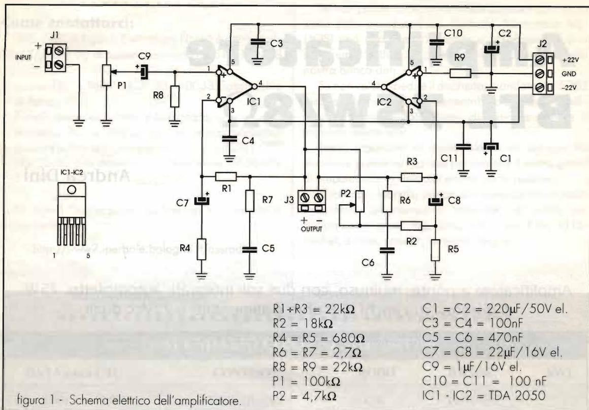
ponte fa lavorare entrambi gli stadi alla stessa ampiezza. Per chi non potesse controllare l'onda con l'oscilloscopio è possibile eliminare P2 con un ponticello e portare R2 da 18 a 22kΩ.
