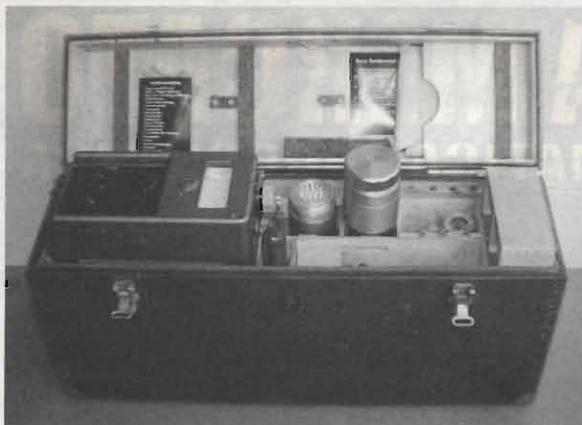
Foto 12 - Lo strumento, con tutti gli accessori, è contenuto in una solida cassetta di legno verde oliva dotata di tasche e scomparti. Il contenitore è in realtà molto più compatto di quanto la quantità di oggetti del corredo non faccia presagire.
