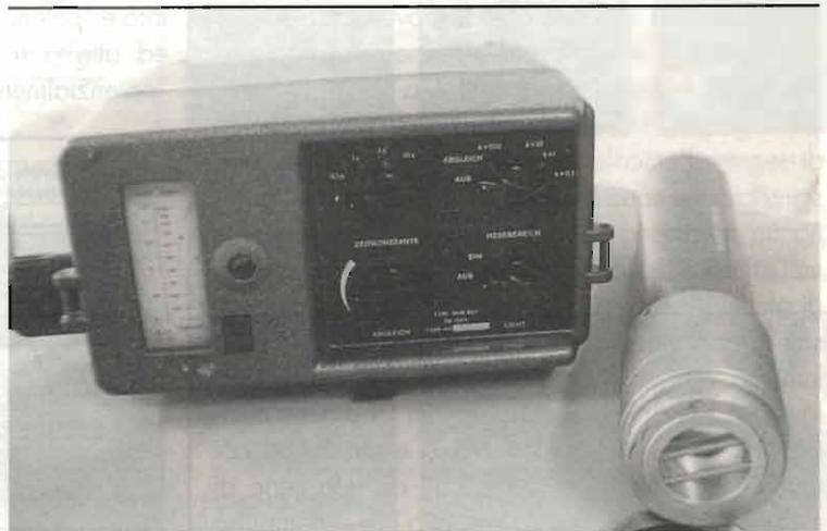
Foto 2 - Primo piano del contatore con, a destra, la sonda per  $\beta$  e  $\gamma$  con la finestra sensibile aperta.
