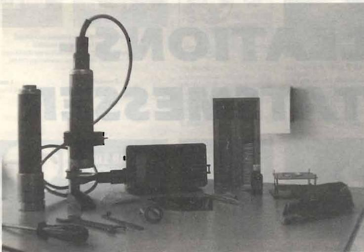
Foto 1 - Lo strumento e l'ampia dotazione di accessori. Da sinistra in secondo piano: la sonda per  $\beta$  e  $\gamma$ , la sonda per  $\alpha$  montata sullo stativo, il contatore ed i piattini portacampioni. Davanti, sempre da sinistra, le chiavi ed i cacciaviti, i collimatori di scorta, i fondo scala aggiuntivi, le cinghie e gli accessori per la preparazione dei campioni tra cui contagocce, pinzette e fornellino.
