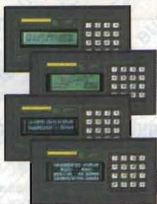
Pannello Operatore, a basso costo, con contenitore standard DIN da 96x192 mm. Disponibile con display LCD Retroilluminato o Fluorescente nei formati 2x20 o 4x20 caratteri; Tastiera da 16 tasti; comunicazione in RS 232, RS 422 o Current Loop; Buzzer; E' in grado di contenere fino a 100 messaggi; 4 ingressi optoisolati, acquisibili
