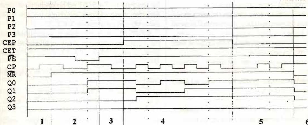
figura 4 - Confronto tra i risultati di un'analisi condotta sul contatore 74LS161 al simulatore SPICE ed all'ASC (test su componente erelae).
