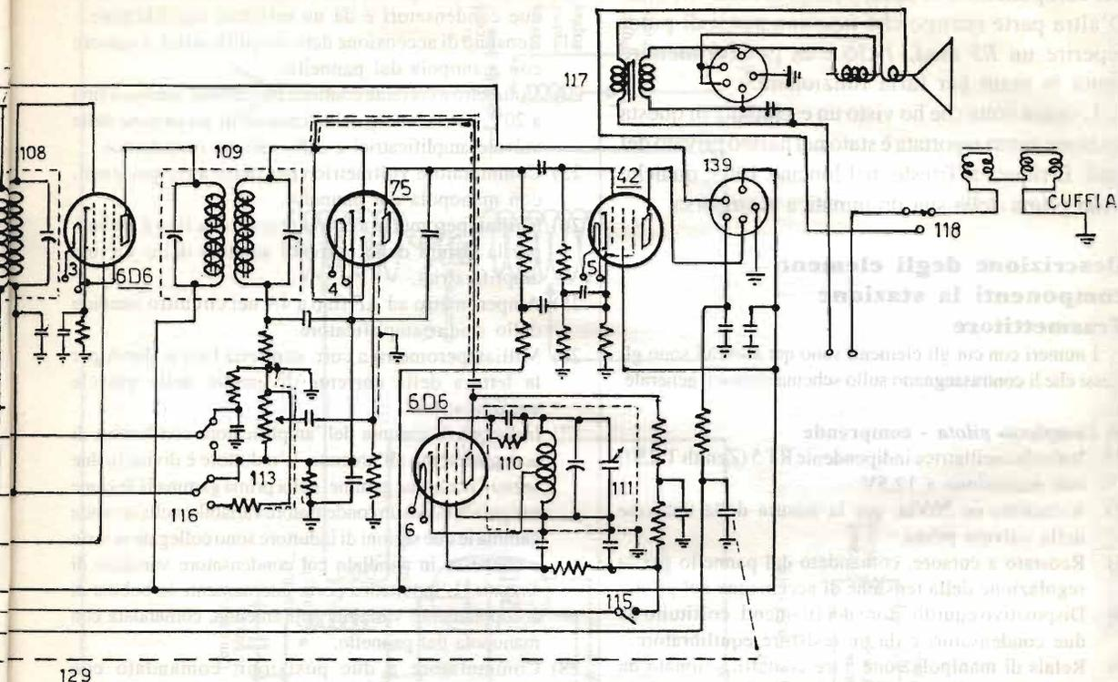
figura 1 - Autostazione R5: Schema di principio del ricevitore.
