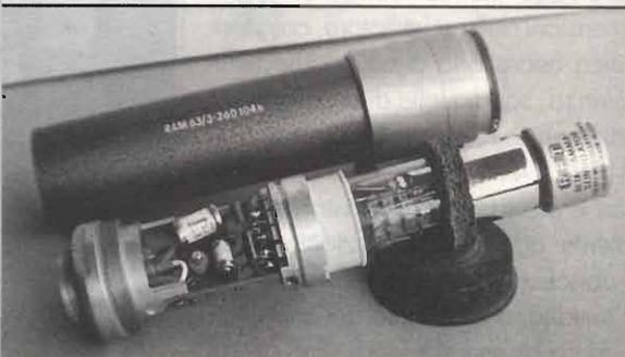
Foto 7 - Vista interna della sonda per raggi  $\beta$  e  $\gamma$ : da destra si notino il cristallo scintillatore, il fotomoltiplicatore, lo zoccolo e i componenti della rete di alimentazione dei dinodi. Sullo sfondo il contenitore di protezione.
