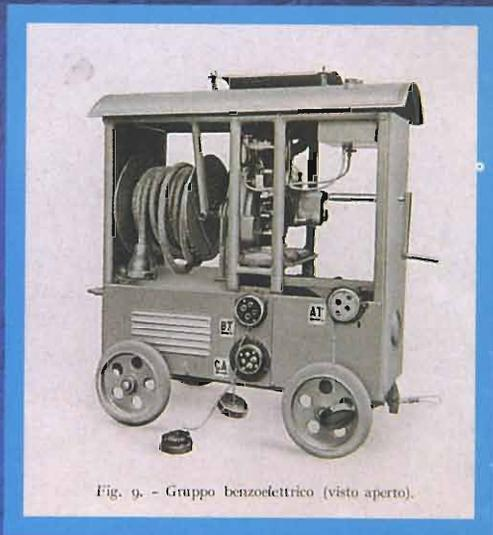
Fig. 9. - Gruppo benzoelettrico (visto aperto).
