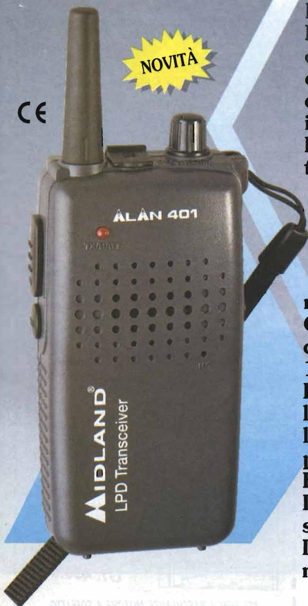
Mini ricetrasmittitore LPD funzionante a un canale, impostabile tra 32 disponibili. Per le caratteristiche peculiari di leggerezza e per le ridotte dimensioni, è molto adatto per comunicare durante l'intero arco della giornata, senza creare inconvenienti di peso o ingombro. Funziona con 4 batterie alcaline tipo "AAA" (a perdere) oppure con 4 batterie Ni-Cd tipo "AAA" (ricaricabili).
