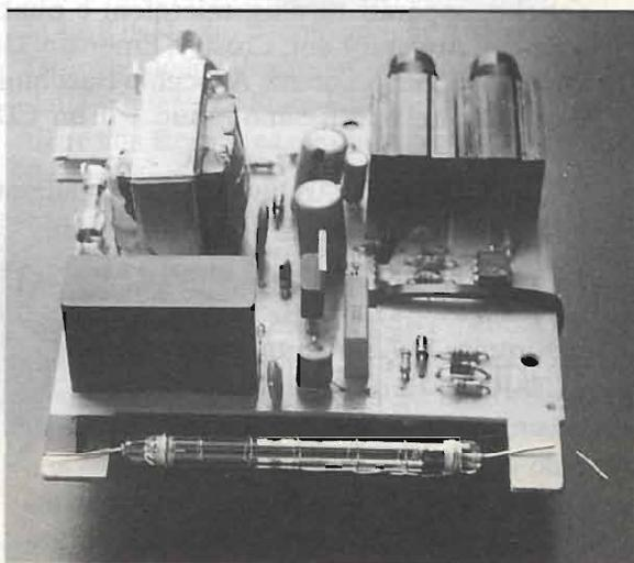
Foto 2 - Vista della lampada strobo lineare sostituibile con un normale tubetto ad "U" (lo stampato qui fotografato non è quello definitivo).
