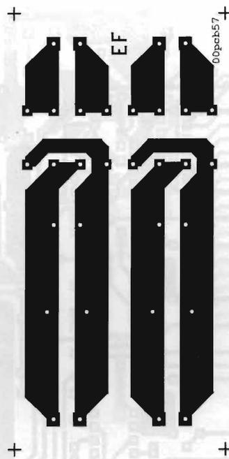
PREAMPLI VALVOLARE (ALIMENTATORE)
