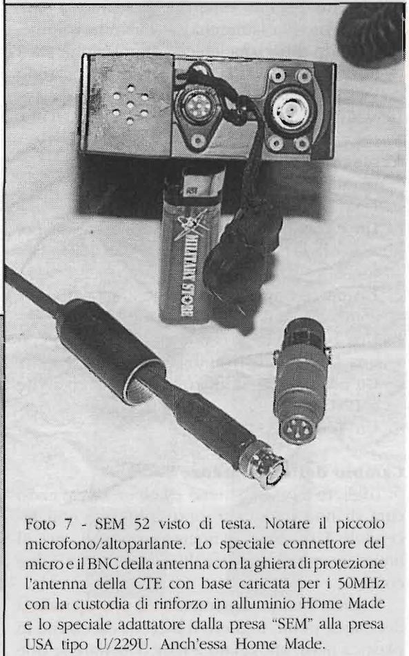
Foto 7 - SEM 52 visto di testa. Notare il piccolo microfono/altoparlante. Lo speciale connettore del micro e il BNC della antenna con la ghiera di protezione l'antenna della CTE con base caricata per i 50MHz con la custodia di rinforzo in alluminio Home Made e lo speciale adattatore dalla presa "SEM" alla presa USA tipo U/229U. Anch'essa Home Made.
