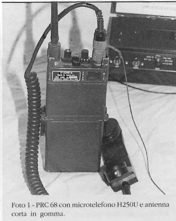
Foto 1 - PRC 68 con microtelefono H250U e antenna corta in gomma.
