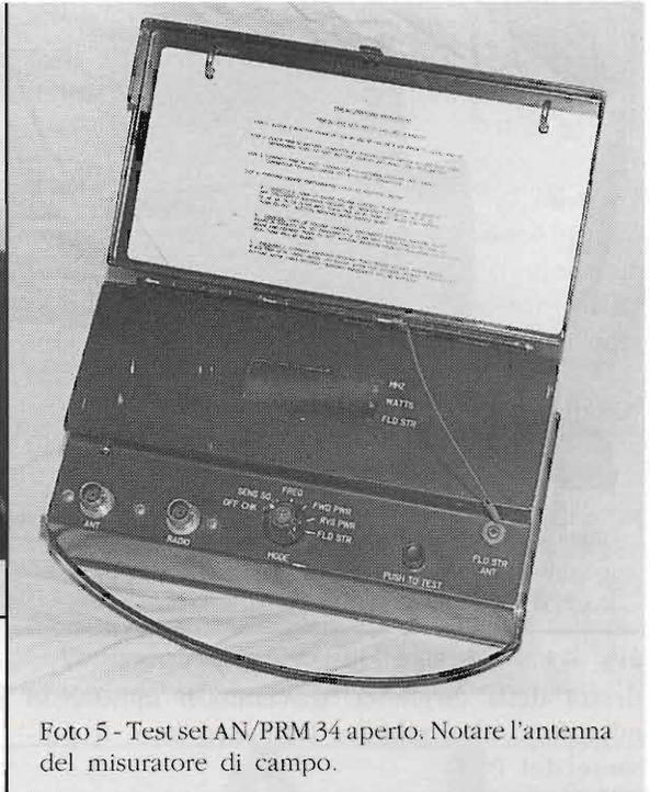
Foto 5 - Test set AN/PRM 34 aperto. Notare l'antenna del misuratore di campo.
