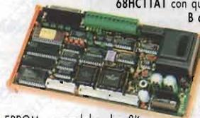
EPROM e modulo da 8K RAM+RTC; E<sup>2</sup> interna alla CPU; 8 linee A/D; 32 I/O TTL; RS 232, RS 422 o RS 485; Watch-Dog; Timer; Counter; ecc. Alimentatore incorporato da 220Vac. Ideale da abbinare al tool di sviluppo software ICC-11 o Micro-C.
