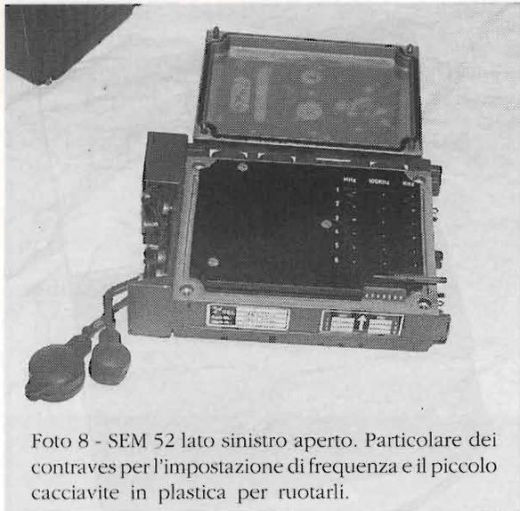
Foto 8 - SEM 52 lato sinistro aperto. Particolare dei contraves per l'impostazione di frequenza e il piccolo cacciavite in plastica per ruotarli.
