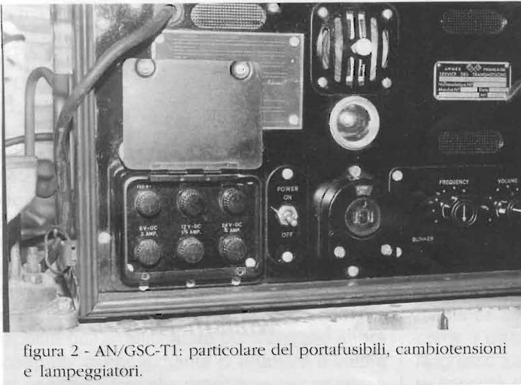
figura 2 - AN/GSC-T1: particolare del portafusibili, cambiotensioni e lampeggiatori.
