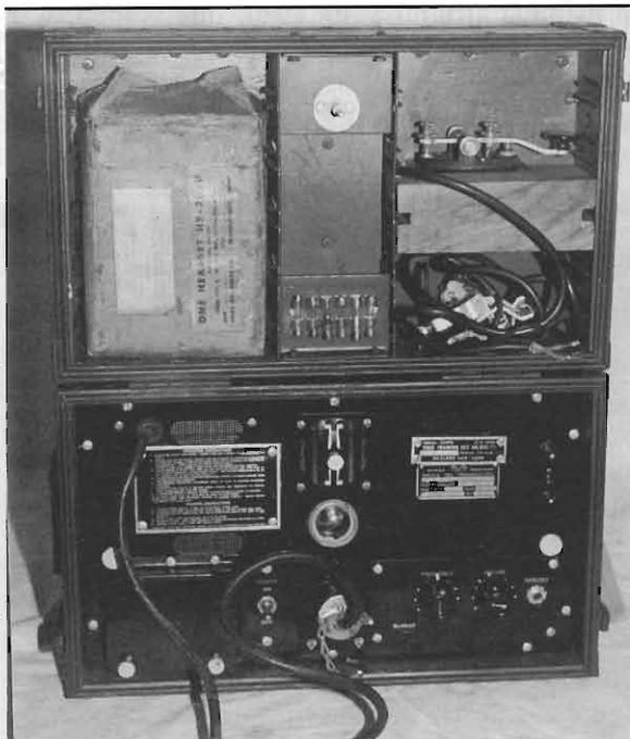
figura 1 - Oscillofono-eliografo AN/GSC-T1.
