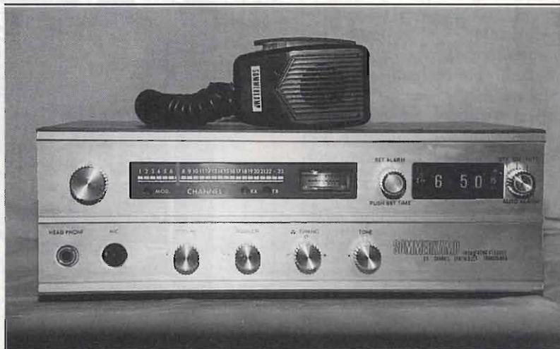
**RICORDO INDIMENTICABILE:** il Sommerkamp TS 5023. Su tratta di un classico Old CB con 23 canali in modulazione di ampiezza (AM) doppia, alimentazione 220V/13,8V.
