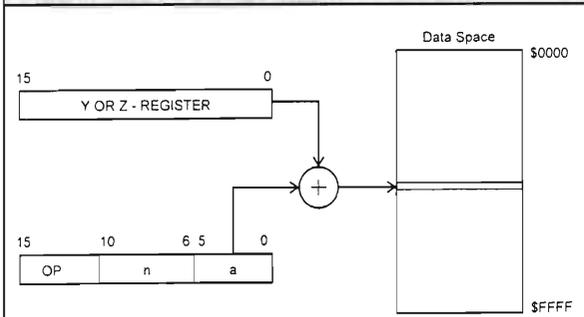
figura 4 - Per spiegare l'indirizzamento indiretto con "displacement".
