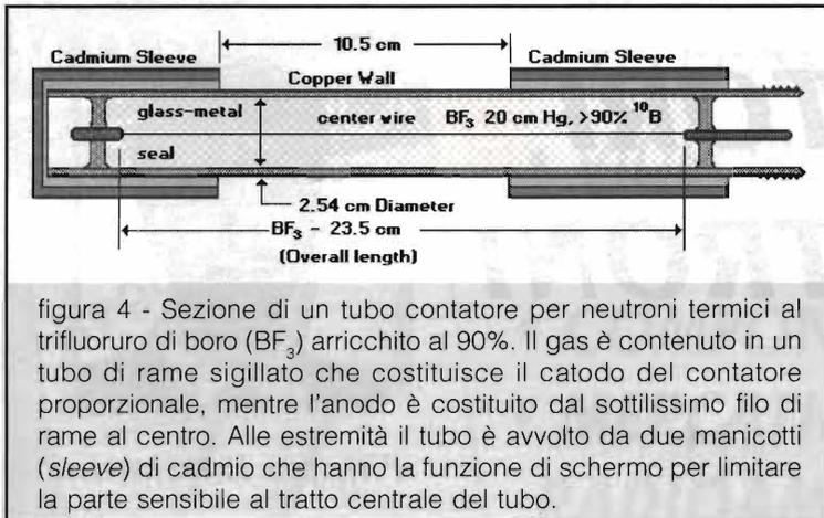
figura 4 - Sezione di un tubo contatore per neutroni termici al trifluoruro di boro ( $\text{BF}_3$ ) arricchito al 90%. Il gas è contenuto in un tubo di rame sigillato che costituisce il catodo del contatore proporzionale, mentre l'anodo è costituito dal sottilissimo filo di rame al centro. Alle estremità il tubo è avvolto da due manicotti (*sleeve*) di cadmio che hanno la funzione di schermo per limitare la parte sensibile al tratto centrale del tubo.
