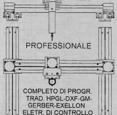
STRUTTURA IN ALLUMINIO CON ROTAIE IN ACCIAIO, MOVIMENTO ASSI XY SU CREMAGLIERA AZIONATI DA MOTORI PASSO PASSO CON RISOLUZIONE 39 MICRON E UNA SPINTA PER L'ASSE X 10KG. E PER L'ASSE Y 20KG. VELOCITA' MAX 40mm/sec SCORRIMENTO SU CUSCINETTI A RICIRCOLO DI SFERE + MINI TRAPANOFRESA 10W
