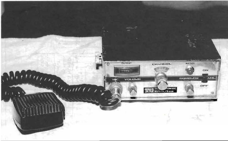
ti caratteristiche in ricezione soprattutto per quanto riguarda i fenomeni di "intermodulazione" e "modulazione incrociata" che purtroppo affliggono quasi tutti i baracchini CB che hanno il primo stadio del ricevitore (amplificatore R.F.) realizzato con transistori "normali" cioè bipolari (in sigla BJT). Questi fastidiosi fenomeni erano detti in gergo "sblateri". Anche gli apparati più recenti purtroppo spesso presentano questi inconvenienti.
