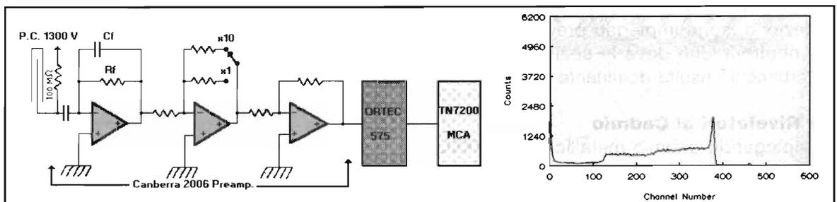
figura 5 - Il contatore al  $\text{BF}_3$ , essendo un tubo proporzionale, abbisogna di un amplificatore abbastanza sofisticato (schema a blocchi a sx). A dx è presentato il tipico spettro ottenuto collegando un multicanale all'uscita dell'amplificatore: se si decide di impiegare un più semplice discriminatore a soglia sarà necessario tararlo attorno al canale 350 dello spettro, per avere una buona reiezione ai  $\gamma$ .
