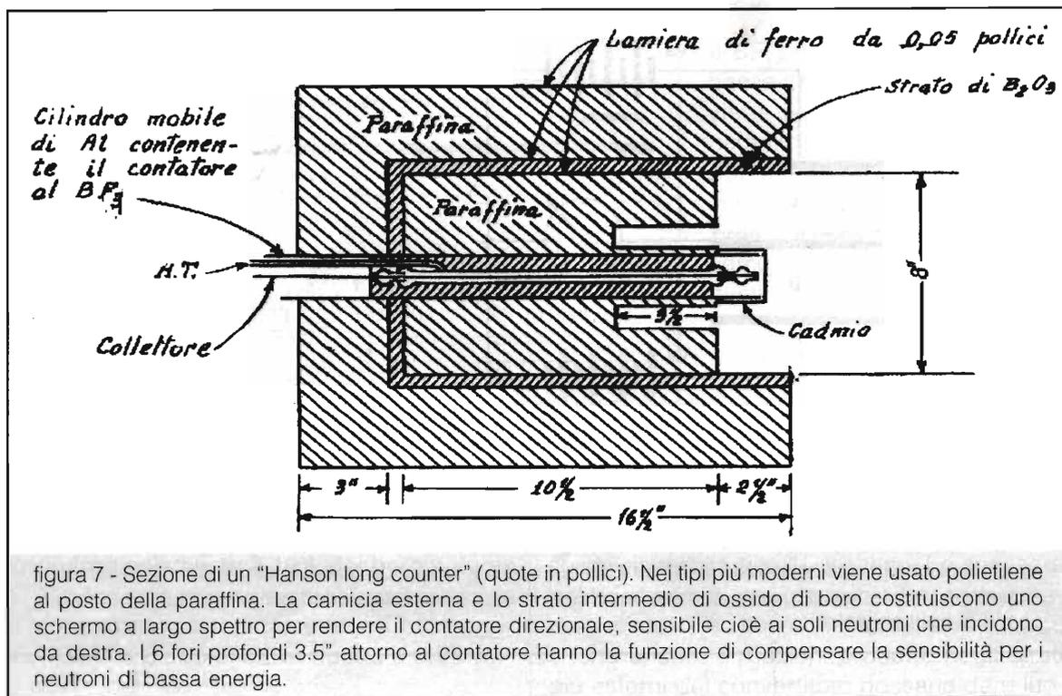
figura 7 - Sezione di un "Hanson long counter" (quote in pollici). Nei tipi più moderni viene usato polietilene al posto della paraffina. La camicia esterna e lo strato intermedio di ossido di boro costituiscono uno schermo a largo spettro per rendere il contatore direzionale, sensibile cioè ai soli neutroni che incidono da destra. I 6 fori profondi 3.5" attorno al contatore hanno la funzione di compensare la sensibilità per i neutroni di bassa energia.
