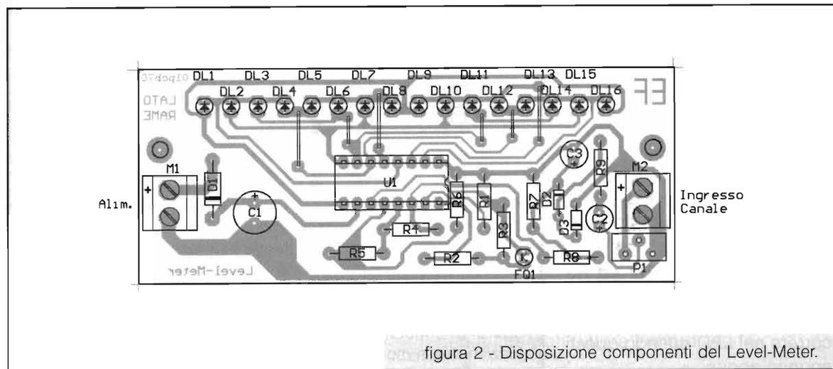
figura 2 - Disposizione componenti del Level-Meter.
