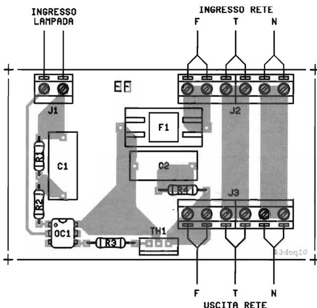
220V delle uscite lampade ed un'uscita dal nostro booster potremo prelevare sempre tensione di rete ma con oltre i 4kW per canale. Dissipate abbondantemente i TRIAC.
