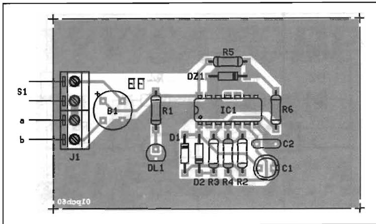
cia del circuito stampato visibile in figura. Si faccia attenzione ai componenti polarizzati e a montare lo zoccolo per IC1.
