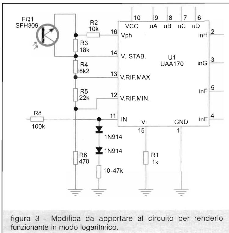
figura 3 - Modifica da apportare al circuito per renderlo funzionante in modo logaritmico.
