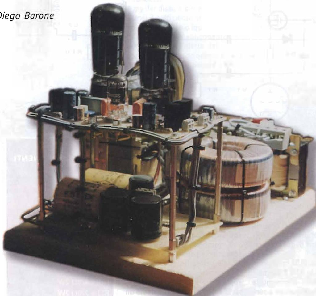
**Ovvero un amplificatore a tubi con potenza di circa 4W, trasformatore di uscita toroidale, ottima resa sonora e prezzo tutto sommato contenuto**
