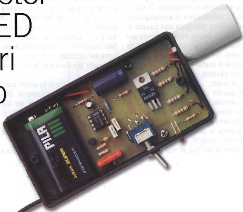
**La perfetta regolazione dell'anticipo di accensione è fondamentale per il corretto funzionamento dei motori endotermici. Conosciamo meglio questo importante parametro e costruiamo un semplice stroboscopio sincronizzato a diodi LED onde eseguirne la periodica verifica, utile per le vecchie auto passate a benzina verde**
