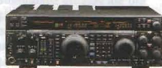
Leader nella gamma VHF Yaesu, 200 W di potenza (classe AB), accordatore automatico d'antenna rapido, preselettore VRF a filtro d'ingresso variabile. Filtro SSB meccanico Collins a 10 poli, alimentatore esterno, 2 ingressi d'antenna + 1 per sola ricezione.
