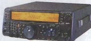
Ricetrasmittitore in grado di operare su 5 bande: HF/50 MHz/144 MHz/430 MHz (1,2 GHz opz.). Accordatore d'antenna incorporato, 300 locazioni di memoria per frequenze simplex, duplex e split. Disponibile in due versioni, con frontale tradizionale o box.
