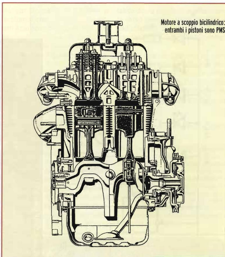
Motore a scoppio bicilindrico:
