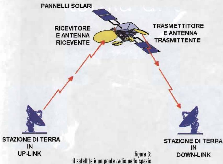
tronici. Il carico utile è tipico per ciascun satellite. Per esempio, il carico utile di un satellite meteorologico include fotocamere dotate di telescopi per ottenere immagini delle formazioni nuvolose, mentre il carico utile di un satellite per comunicazioni include antenne di grandi dimensioni per trasmettere segnali telefonici o TV verso la Terra.
