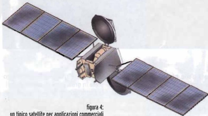
Ciascuno di questi satelliti è composto di molte parti, che variano a seconda del tipo di applicazione e dell'orbita. Due elementi sono tuttavia comuni a tutti i satelliti e sono chiamati "carico utile" ("payload") e carrozza ("bus") (figura5).
