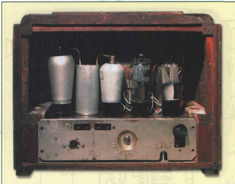
versale, il secondario AT fornisce 325 + 325V per le due placche della raddrizzatrice RGN1064; altri due avvolgimenti a 4V alimentano i filamenti della raddrizzatrice e, con presa centrale a massa, quelli delle altre quattro valvole in parallelo. Sul trasformatore d'alimentazione è presente un disgiuntore termico di protezione contro pericoli di surriscaldamento: esso è costituito da una lamina bimetallica che in pre-
