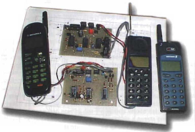
**Recuperare un vecchio cellulare e trasformarlo in un teleavviso da abbinare o sostituire alla sirena di un antifurto di qualsiasi tipo**
