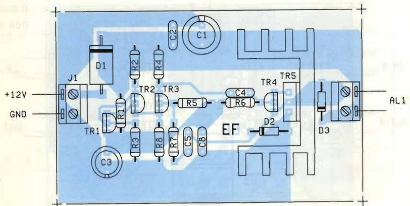
Forse sono tornati di moda i componenti discreti ed i transistor fanno da padroni! Questo alimentatore potrà essere realizzato con i componenti che sono di risulta nel cassetto del laboratorio. Dissipate con cura TR3, infine regolate P1 per la tensione di uscita che vi serve. La resistenza R3 stabilisce la corrente massima tramite TR2.
