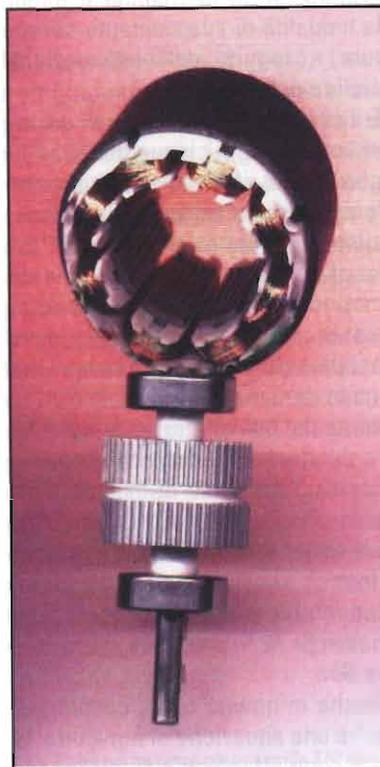
l'ampiezza del passo che il rotore può compiere. Gli avvolgimenti vengono eseguiti in maniera da produrre un avanzamento del flusso radiale come conseguenza della alimentazione sequenziale degli stessi avvolgimenti di fase.
