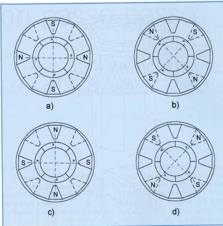
appartenenti al rotore. Successivamente (figura 3b)) risulta diseccitata la fase **a** ed eccitata la **b** appartenente al piano inferiore: la situazione di campo statorico precedente risulta ora ruotata di 45° in senso orario: anche il rotore, adeguandosi, percorrerà un passo angolare di 45°.
