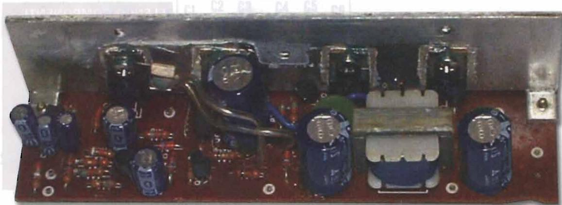
**Un versatile modulo a componenti discreti che eroga oltre 50W su 4 ohm e può essere alimentato con una batteria 12V tipo auto o piombo gel. Le dimensioni ridotte ne consigliano l'uso come elemento attivo interno di box acustici amplificati**
