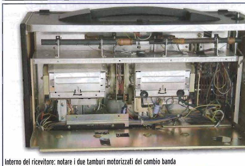
Interno del ricevitore: notare i due tamburi motorizzati del cambio banda
