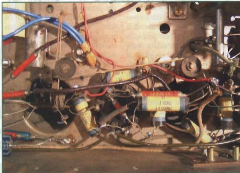
saldati ai terminali della valvola convertitrice ha svelato il mistero: il condensatore da 1nF che accoppia la placca del triodo della WE43 al circuito accordato d'oscillatore era pressoché in corto, rivelando al multimetro una resistenza di appena 800 ohm... e pensare che si tratta, incredibilmente, di un Ducati a mica in custodia fenolica rettangolare!
