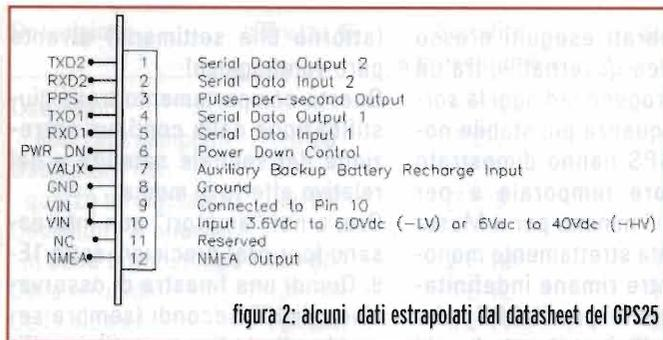
figura 2: alcuni dati estrapolati dal datasheet del GPS25
