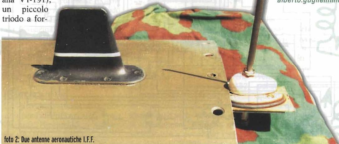
foto 2: Due antenne aeronautiche I.F.F.
