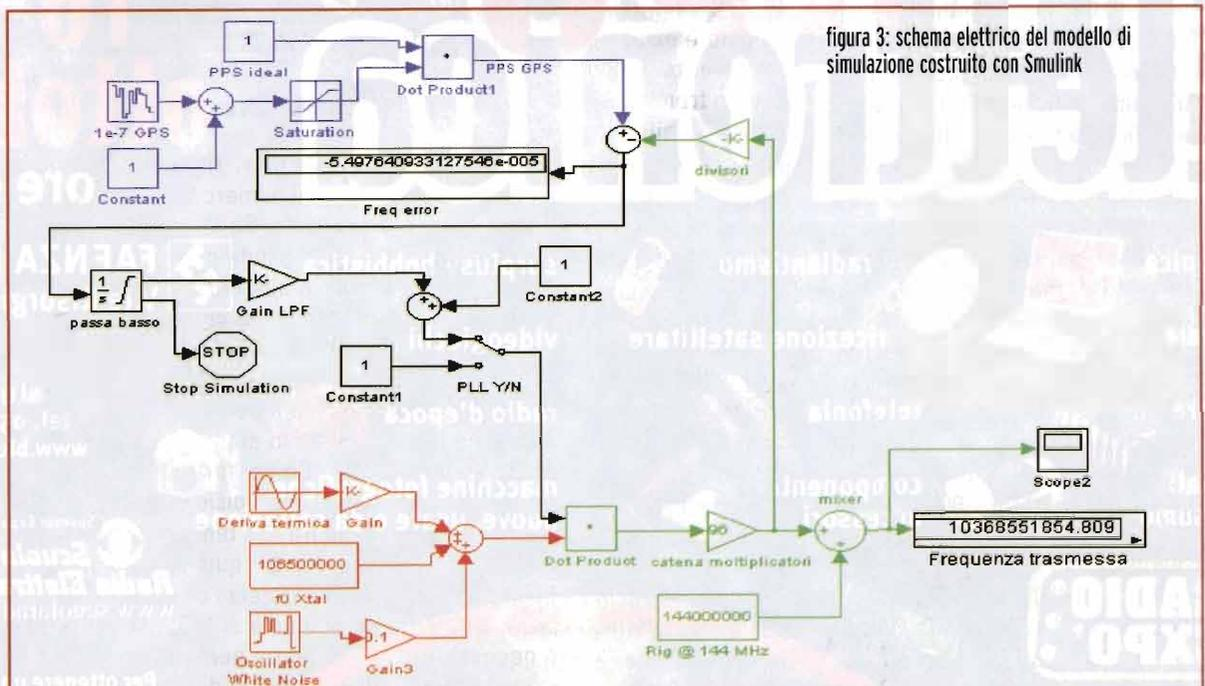
figura 3: schema elettrico del modello di simulazione costruito con Smulink
