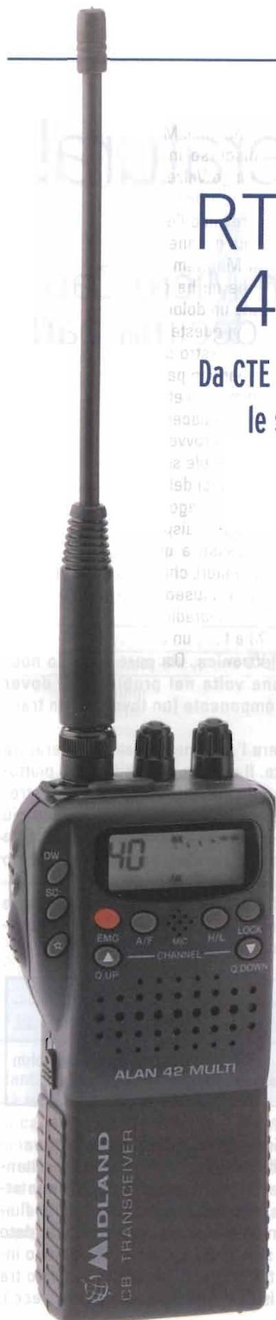
ALAN 42 MULTI è un ricetrasmittitore di piccole dimensioni che garantisce ottime prestazioni nelle più svariate condizioni di utilizzo. È un apparato innovativo in quanto è l'unico CB portatile che offre all'utente la possibilità di selezionare qualsiasi banda CB europea tramite una semplice ed immediata procedura. ALAN 42 MULTI è controllato da un sintetizzatore di frequenza (PLL) e da un dispositivo automatico di risparmio delle batterie.
