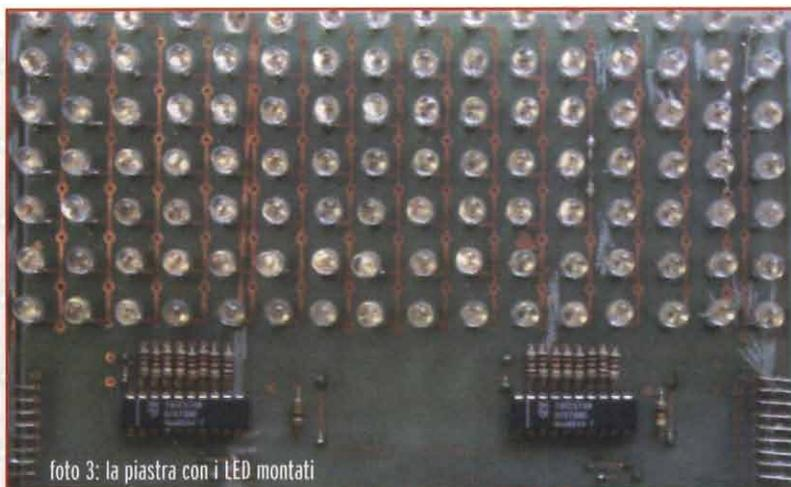
foto 3: la piastra con i LED montati
