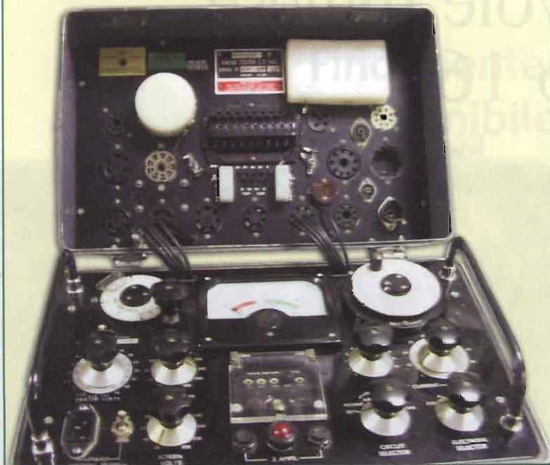
40, 60, 75, 90, 100, 150, 200, 250 e 300, corrente variabile in passi di 1mA da 0 a 100mA, per la tensione di griglia schermo le tensioni selezionabili sono: 20, 40, 60, 75, 90, 100, 125, 150, 200, 250 e 300volt. La tensione di polarizzazione di griglia è variabile con continuità da 0 a -
