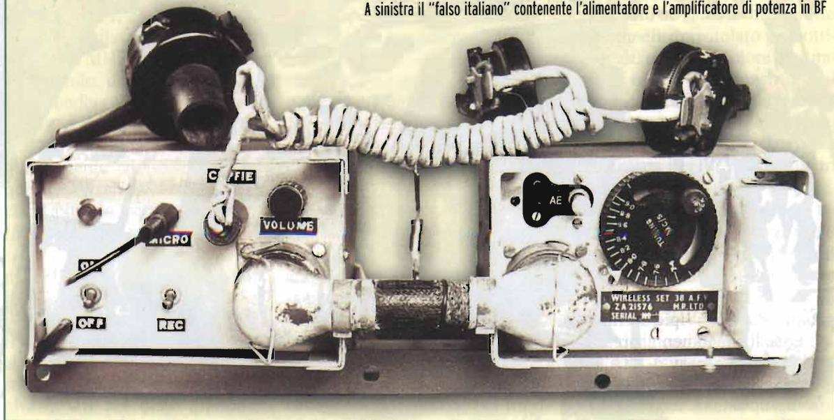
La stazione veicolare consisteva in due unità, il WS38 AFV comprendente il tx rx e l'unità alimentazione ed amplificatore audio di potenza (PS and LF unit n°1) necessario per vincere sul frastuono che regnava a bordo dei tanks (figura 1-2-3). Le due unità erano normalmente montate sopra la 19 MK 2 o 3 ed utilizzavano l'alimentazione del veicolo.
