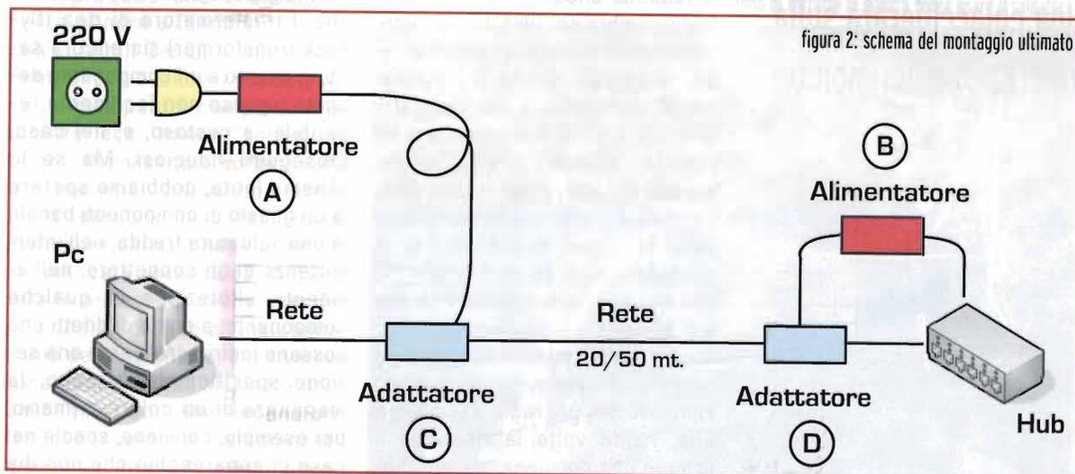
figura 2: schema del montaggio ultimato
