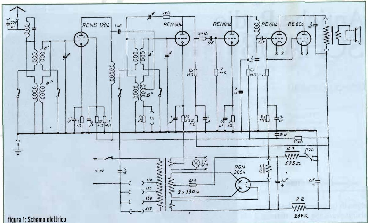
figura 1: Schema elettrico
