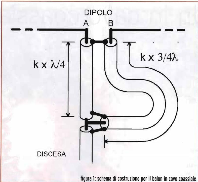
figura 1: schema di costruzione per il balun in cavo coassiale
