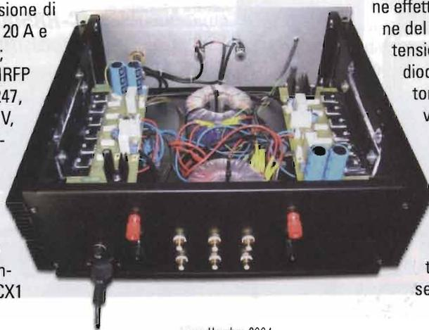
drain, raggiunge i morsetti di uscita attraverso il parallelo di tre condensatori elettrolitici di ottima qualità (ROE, SIEMENS, ecc.) rispettivamente due da 2200 microF/100V ed uno di bypass da 0,27 microF/150 V. In parallelo all'uscita è posta la resistenza R12 (3K9/5W). Lo stesso
