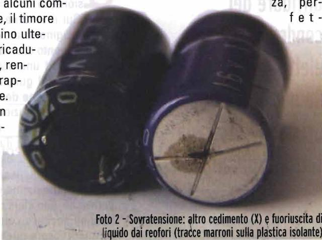
Foto 2 - Sovratensione: altro cedimento (X) e fuoriuscita di liquido dai reofori (tracce marroni sulla plastica isolante)
