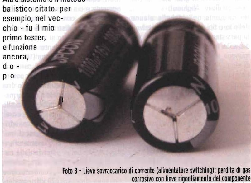
Foto 3 - Lieve sovraccarico di corrente (alimentatore switching): perdita di gas corrosivo con lieve rigonfiamento del componente
