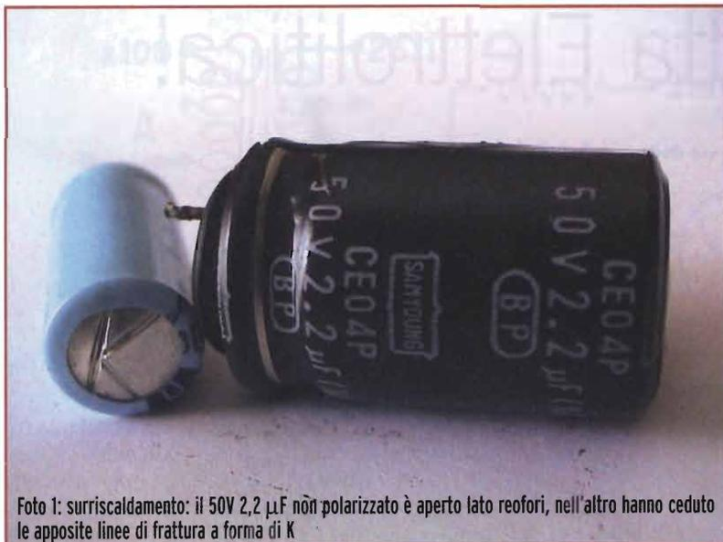
Foto 1: surriscaldamento: il 50V 2,2 µF non polarizzato è aperto lato reofori, nell'altro hanno ceduto le apposite linee di frattura a forma di K
