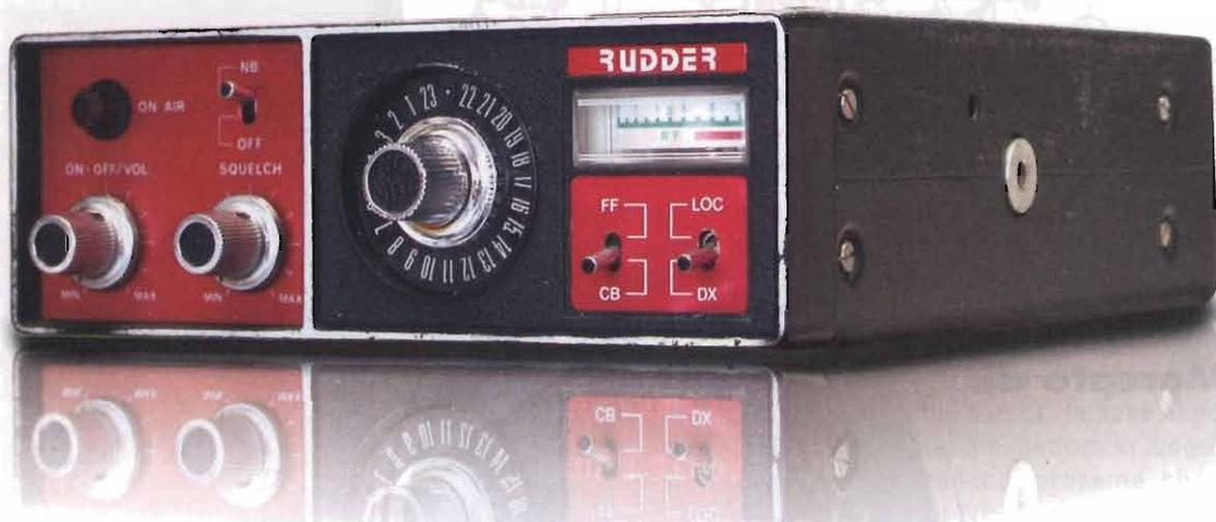
**Baracchino per uso in barra mobile, 23 canali in ampiezza modulata con frequenze di ricezione e trasmissione ottenute per sintesi, utilizzando sei quarzi comuni, e quattro coppie di quarzi**
