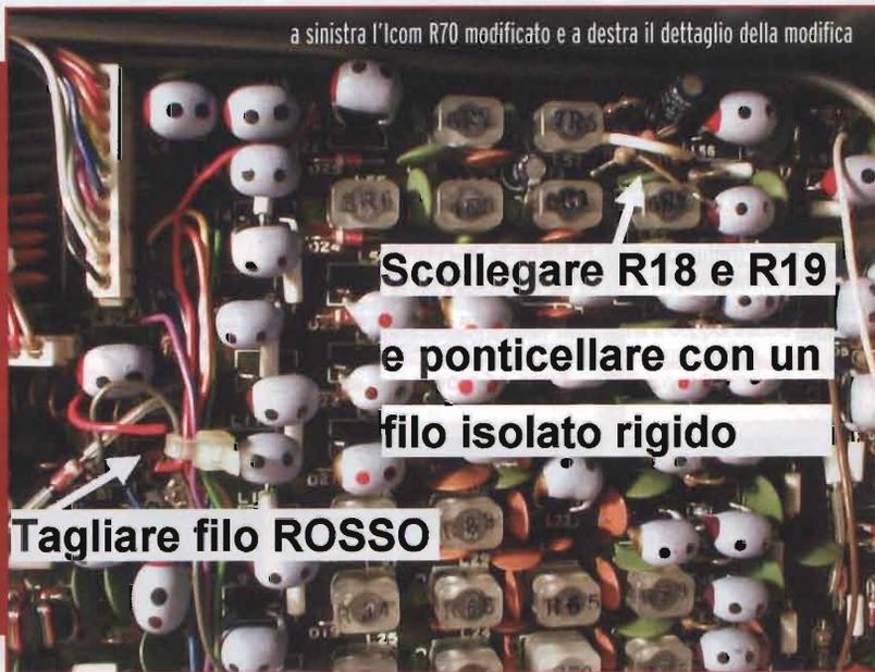
piastra, schema e layout in mano, cerchiamo R18 e R19 (si trovano quasi sul bordo superiore, Foto 2). **Attenzione perché il layout dei componenti è capovolto.** Con attenzione dissaldiamo la R18
