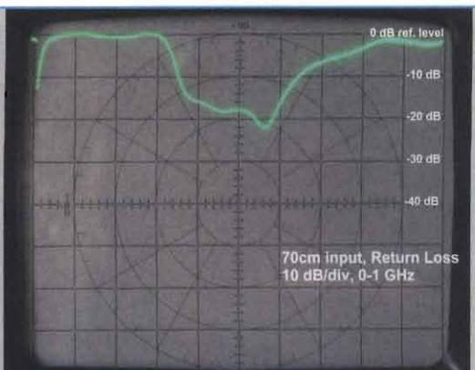
Quest'invece è la curva di return loss della porta comune (con le due uscite ovviamente correttamente chiuse su  $50\Omega$ ). Sono evidenti i due dip (130 e 480 MHz in figura) in prossimità delle bande amatoriali. "Giocando" un poco con la dimensione delle bobine è possibile ottimizzare la curva e portarli esattamente al centro delle nostre bande. Anche senza particolari "cure", il circuito è comunque in grado di soddisfare la maggior parte delle applicazioni.
