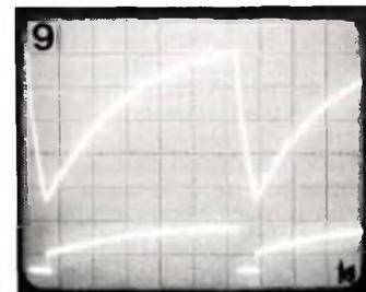
Figure 9 - La courbe supérieure de l'oscillogramme montre l'évolution de la tension aux bornes de C1 au cours du cycle de charge et de décharge. La courbe inférieure retrace les variations de la tension de collecteur de T1 (broche 7). Comparez les deux courbes et vous remarquerez que C1 se décharge quand T1 est conducteur (tension de collecteur = ±0 V).
