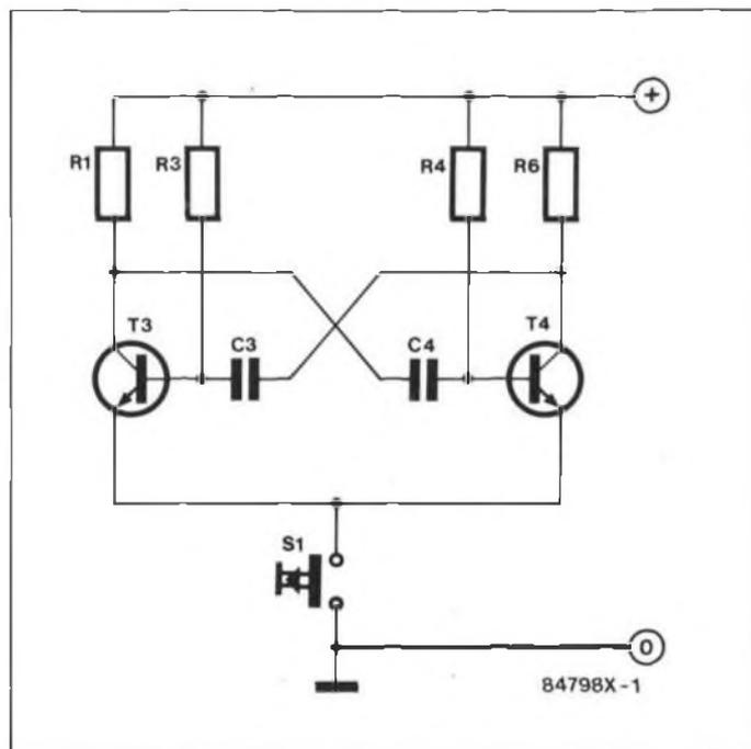
**Figure 1 - Le schéma du multivibrateur astable se reconnaît aisément au croisement caractéristique des lignes de commande mutuelle de la base d'un transistor par le collecteur de l'autre, à travers un condensateur. C'est ce générateur d'impulsions, extrait du schéma complet de la figure 2, qui jette la pièce et la fait tourner tant que l'on appuie sur S1.**
