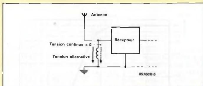
La tension alternative captée par l'antenne est présente aux bornes de la bobine, donc à l'entrée du récepteur. La bobine n'influe pas sur la tension alternative utile. Les tensions continues, au contraire, sont court-circuitées à
