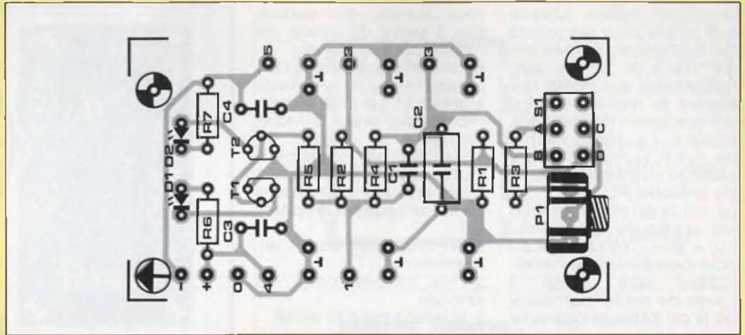
Figure 4 - Ce circuit universel peut recevoir un support à 14 ou 16 broches, toutes accessibles sur des picots de part et d'autre du support. Nous l'utilisons ici pour monter le circuit intégré à tester. Il ne sera pas tenu compte des indications sur la tension d'alimentation, le nombre de broches et le condensateur (destinées à une autre application de cette platine).
