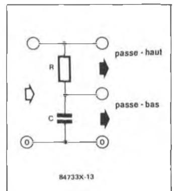
Figure 13 - Dans un réseau RC, les composantes du filtrage passe-haut sont relevées sur la résistance, tandis que les composantes du filtrage passe-bas apparaissent aux bornes du condensateur.
