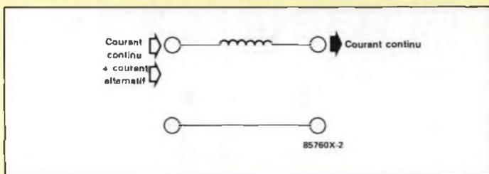
Les bobines sont utilisées pour l'alimentation en continu d'étages amplificateurs à haute fréquence. On les appelle des **bobines de choc**. Elles conduisent le courant continu nécessaire au fonctionnement, grâce à leur faible résistance, mais arrêtent le courant alternatif, grâce à leur forte impédance. Elles empêchent ainsi les signaux à haute fréquence d'aller perturber les autres étages et l'alimentation elle-même.
