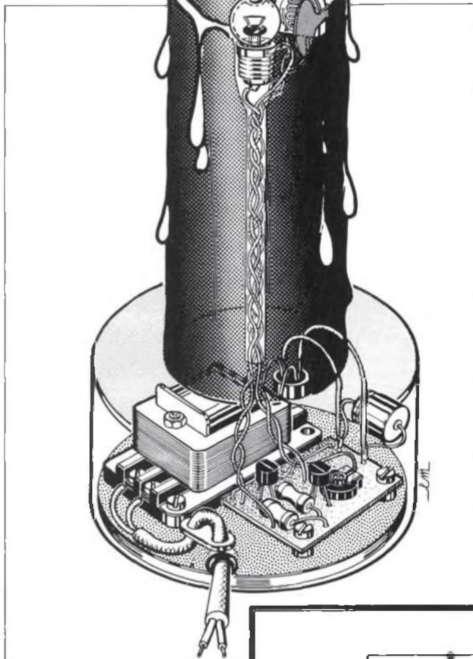
**Figure 1 - Une ampoule électrique à la place de la flamme, une LDR pour détecter la lumière d'une allumette allumée et un disque en carton pour l'obturer quand on souffle dessus pour l'éteindre. Voilà le secret de la bougie électronique.**
