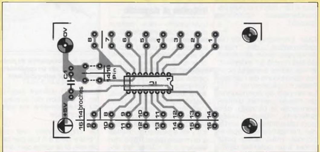
Figure 5 - Pour les composants du testeur d'amplificateur opérationnel, nous vous proposons un dessin de circuit imprimé. Utilisez des picots pour le câblage.
