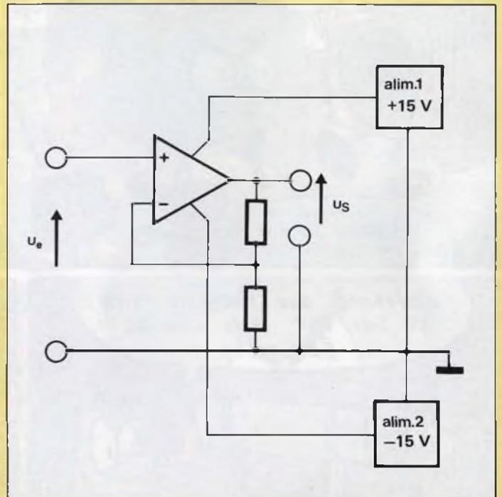
Figure 2 - L'amplificateur non-inverseur, alimenté en symétrie, permet d'amplifier des tensions positives, négatives, ou alternatives.
