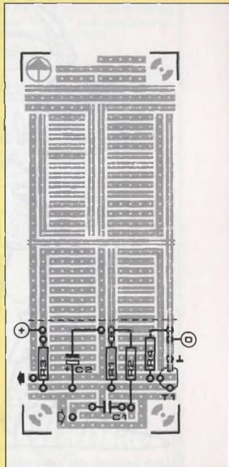
Figure 2 - Alimenté par une pile de 9 V, le circuit de l'amplificateur monté sur une chute de platine d'expérimentation pourra amplifier notamment des signaux BF d'amplitude trop faible pour une entrée ligne.
