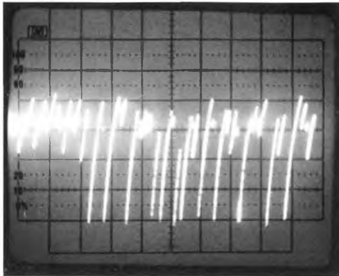
**Figure 3 - On trouve de tout dans le signal de sortie d'un générateur de bruit. Les impulsions résultent du mouvement désordonné des électrons. La sensibilité de l'oscilloscope est de 5 mV par carreau, la base de temps était réglée sur 5 µs par division horizontale pour la photo.**
