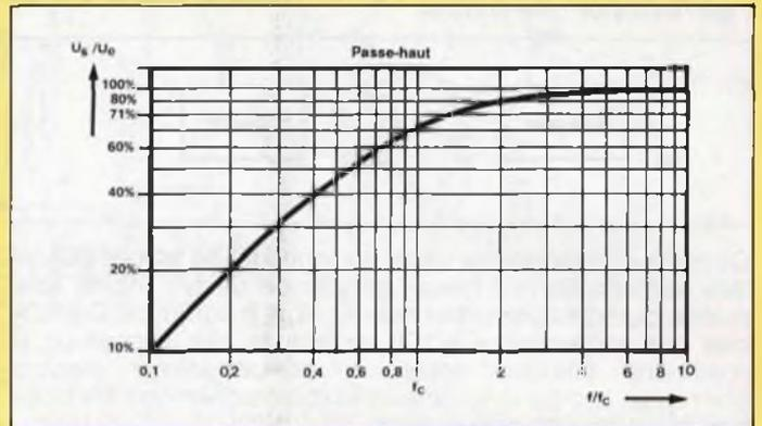
La fréquence de coupure se calcule avec la même formule que celle du filtre passe-bas. Les courbes, tout comme celles des filtres RC, montrent une pente plutôt douce après la fréquence de coupure. L'association d'une bobine et d'un condensateur à la place de la résistance permet d'obtenir une coupure plus franche.
