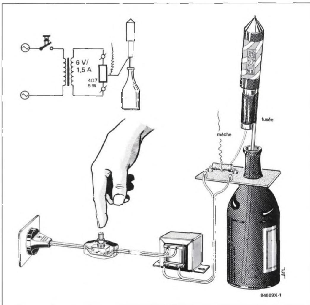
Figure 1 - Avertissement : ce briquet électronique n'est pas utilisable comme allume-clerge. Mais il fonctionne très bien, même si pour des raisons de sécurité, on remplace le transformateur par des piles ou quatre accumulateurs Cad-Ni de capacité respectable et bien chargés. Amusez-vous bien !
