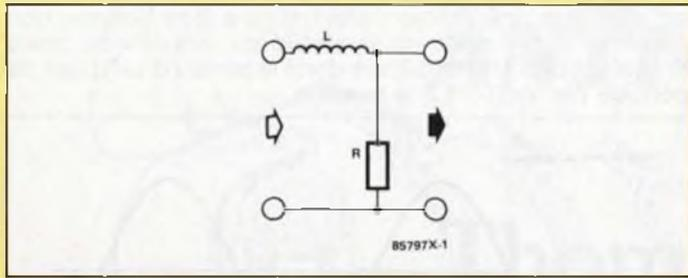
C'est un filtre passe-bas que nous avons réalisé. Il n'oppose quasiment pas de résistance au passage du courant continu (fréquence nulle), mais il s'oppose au passage du courant alternatif, et d'autant plus vigoureusement que la fréquence s'élève. Notre filtre RL (L pour inductance) a une courbe caractéristique symétrique de celle du filtre RC. On y définit aussi une fréquence de coupure, correspondant à une atténuation de 3 dB.
