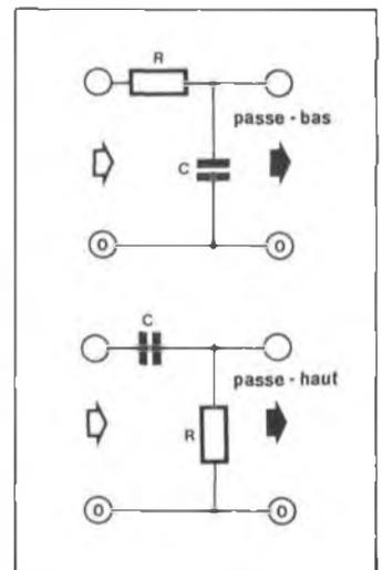
Figure 12 - Schématisation standard des réseaux RC passe-bas et passe-haut.
