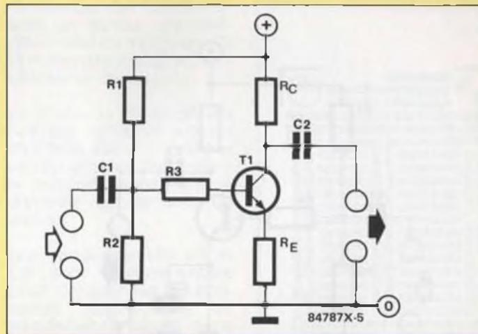
Figure 5 - Difficile à identifier de prime abord, la fonction de contre-réaction de la résistance d'émetteur ! La tension née du courant d'émetteur à travers  $R_E$  réagit sur la tension d'entrée (ici  $R3$  pourrait être omise).
