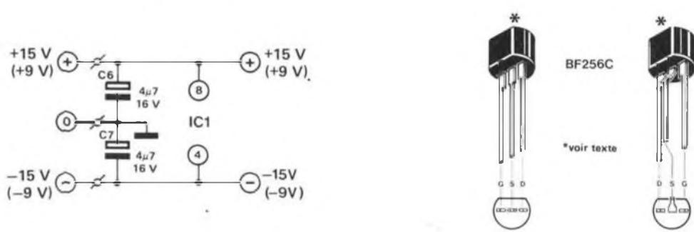
Figure 3 - Au schéma de la trappe à bruit s'applique l'adage : « de la complexité, pas plus qu'il n'en faut, de la simplicité, autant que possible ». Mélez-vous du brochage des BF256. C'est la broche de source (S) qui permet de les distinguer.
