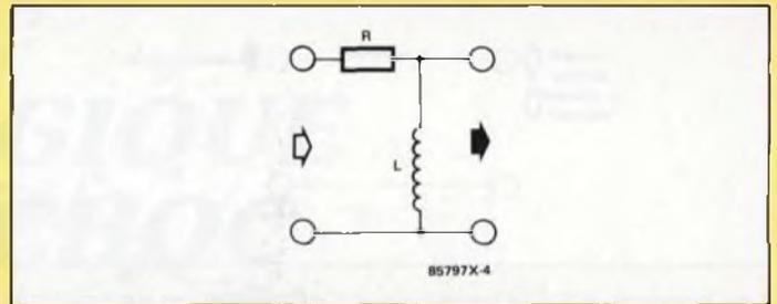
Le filtre RC correspondant avait une caractéristique passe-bas. Ici la bobine représente un court-circuit pour les fréquences basses et le continu alors qu'elle présente une impédance importante aux fréquences les plus hautes.
