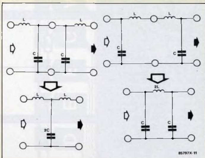
Les composants homologues sont remplacés par un seul, de capacité ou d'inductance double. Les filtres obtenus sont appelés filtres en T ou filtres en  $\pi$  ( $\pi$ ). Ils peuvent être des passe-haut aussi bien que des passe-bas.
