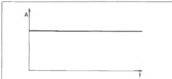
**Figure 4 - Quand on examine le signal de bruit pendant un certain temps, on constate que toutes les fréquences y apparaissent sans que l'une d'entre elles domine ou soit dominée. La courbe de fréquence (théorique) d'un générateur de bruit blanc est donc parfaitement rectiligne.**
