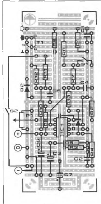
Figure 4 - Plan d'implantation des composants sur une platine d'expérimentation de petit format. Vérifiez le brochage de T1 avant de l'implanter.
