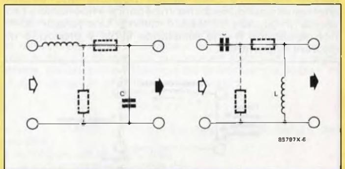
À gauche un filtre LC passe-bas, à droite un filtre LC passe-haut. Les résistances représentées en pointillé figurent les deux filtres RL ou RC que remplace chaque filtre LC. Les courbes caractéristiques présentent comme prévu une coupure plus franche, une pente plus accentuée.
