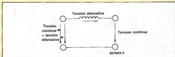
L'inductance n'oppose pas de résistance à la tension continue, qui se retrouve inchangée (ou presque) en sortie. Au contraire, l'impédance provoque une chute importante de la tension alternative, qui a disparu (ou presque) en sortie. Ce principe est exploité entre autres à l'entrée d'un récepteur de radio.
