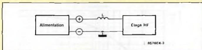
Comme l'impédance varie en fonction de la fréquence, des perturbations à basse fréquence seront moins atténuées que des perturbations à haute fréquence. Dans le cas des ronflements à 100 Hz induits par le secteur, la meilleure solution reste le condensateur électrochimique, moins volumineux et moins cher que les bobines qui seraient nécessaires.
