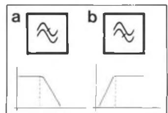
On rencontre souvent un autre symbole pour les filtres passe-haut et passe-bas ; il s'agit d'une schématisation de la courbe de réponse comme celles de la figure 1 et de la figure 2. Quand la courbe descend de gauche à droite, c'est que le filtre est passe-bas, quand elle monte de gauche à droite, c'est un filtre passe-haut.
