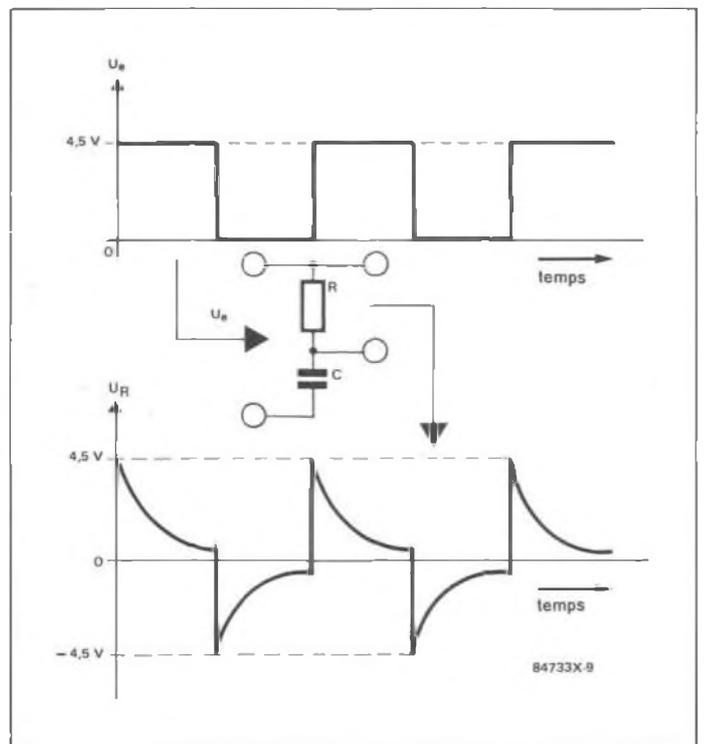
Figure 9 - La loi d'Ohm veut que la tension sur la résistance soit proportionnelle à l'intensité du courant qui la traverse. Nous retrouvons donc entre ses bornes un signal dont la courbe comporte à la fois la courbe du courant de charge du condensateur et celle de son courant de décharge. Il ne reste pas grand chose des fréquences graves sur la résistance d'un réseau RC.
