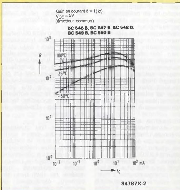
Figure 2 - La courbe du gain en courant d'un transistor BC547 met en évidence le rôle déterminant joué par l'intensité du courant de collecteur et la température du semi-conducteur.
