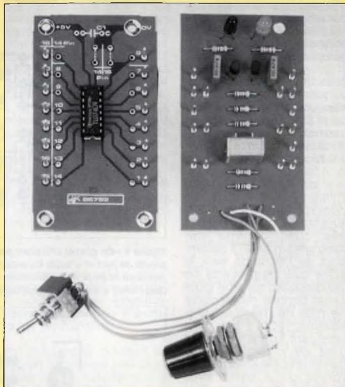
Figure 6 - Photographie du prototype avant assemblage. Remarquez que C2 n'est pas un condensateur chimique, mais un modèle à film polyester, dit auto-cicatrisant.
