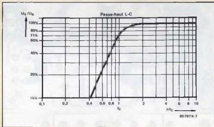
Les pentes sont maintenant de 12 dB/octave. Cela signifie que la tension de sortie est divisée par quatre pour chaque doublement de la fréquence, pour le filtre passe-bas ; pour chaque division par 2 de la fréquence pour le filtre passe-haut. Les filtres RL ou RC n'accusaient que 6 dB/octave, soit une division par deux de la tension de sortie pour les mêmes variations de fréquence.
