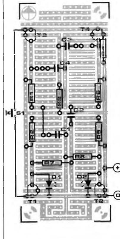
**Figure 3 - Le plan d'implantation de ce pile ou face électronique a été aéré délibérément pour des raisons d'ordre esthétique d'une part, et pour faciliter la tâche des débutants d'autre part. N'oubliez pas les ponts de câblage, notamment les deux petits !**
