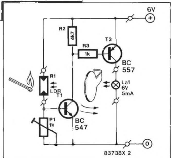
**Figure 2 - Il faut cinq composants pour fabriquer cet interrupteur photosensible qui s'auto-entretient à l'état allumé aussi bien qu'à l'état éteint. Pour le faire changer d'état dans un sens, il faut l'illuminer et dans l'autre sens, il faut l'obscurcir. D'autres applications de ce principe sont imaginables. À vous de les trouver.**
