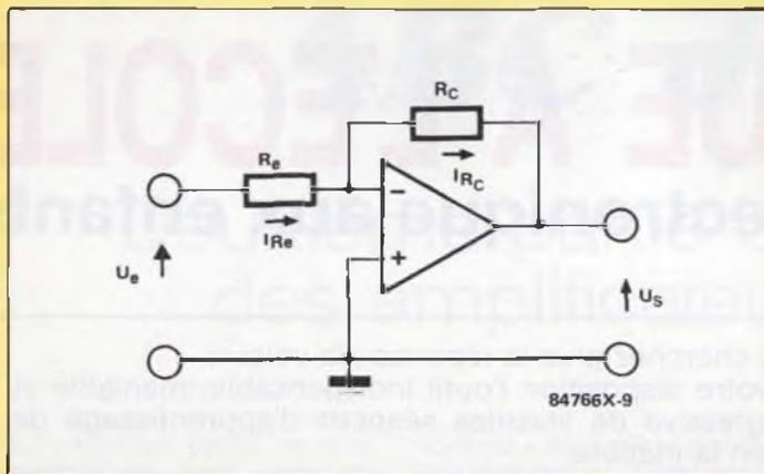
Figure 3 - L'amplificateur inverseur est le montage le plus utilisé. La tension de l'entrée non-inverseuse peut être fixée à un niveau différent de la masse, ce qui nous fait anticiper sur les montages sommateurs.
