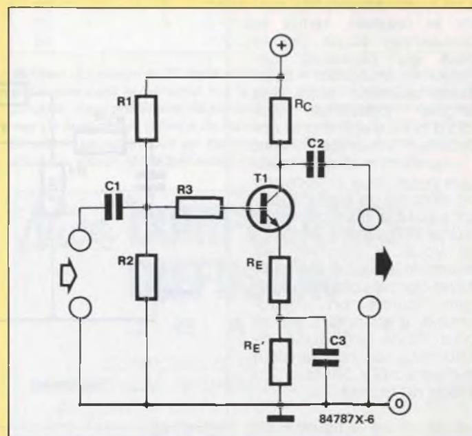
Figure 6 - Un réseau de contre-réaction à deux itinéraires, l'un pour le courant continu (par  $R_E$  et  $R_E'$ ), et l'autre pour le régime alternatif ( $R_E$  et  $C3$ ). Ceci permet d'obtenir à la fois une bonne stabilité thermique et un gain en tension élevé en alternatif.
