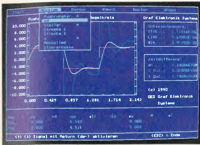
ReSi: Regelkreissimulator für analoge und digitale Regler von Graf Elektronik. Option: Mathematischer Coprozessor.
