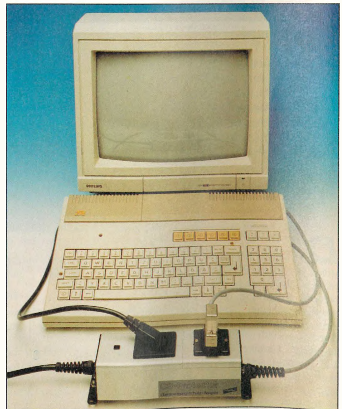
Das Kombinationsschutzgerät 'CS-Protector' begrenzt die Spannung zwischen den Netzen 1 und 2 aus Bild 2. Es verhindert somit das Entstehen von Durchschlagsspannungen zwischen den Anschlüssen E1 und E2.
