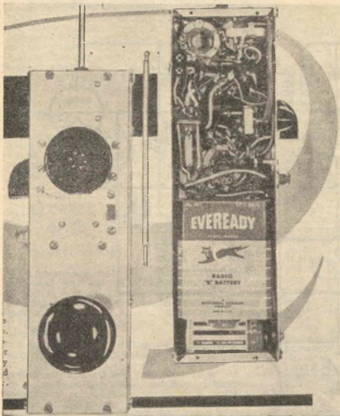
Fig. 1. - Veduta anteriore e posteriore del radiotelefono operante sui due metri. Ricordate che in Italia non vengono ancora concesse autorizzazioni sulle trasmissioni portatili e che in ogni caso le autorizzazioni vengono concesse solo a scopo sperimentale e non per stabilire sistemi di comunicazione.
