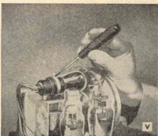
Foto V L'occhio magico, la valvola indicatrice di sintonia montata in molti tipi al di sopra delle altre parti del telaio e dirimpetto ad una piccola apertura nel mobile, può provocare rumori che danno non poco disturbo. Se il morsetto si allenta, tutto l'insieme della valvola si muove e può colpire la superficie della scala od altre parti dell'apparecchio, quando il controllo di volume è completamente aperto o si sta ascoltando la trasmissione locale, il cui segnale è naturalmente molto forte. Quando ciò si verifica, occorre serrare con un cacciavite la vite del morsetto, e, se l'inconveniente non può essere così eliminato, forzare qualche spessore tra morsetto e valvola.
