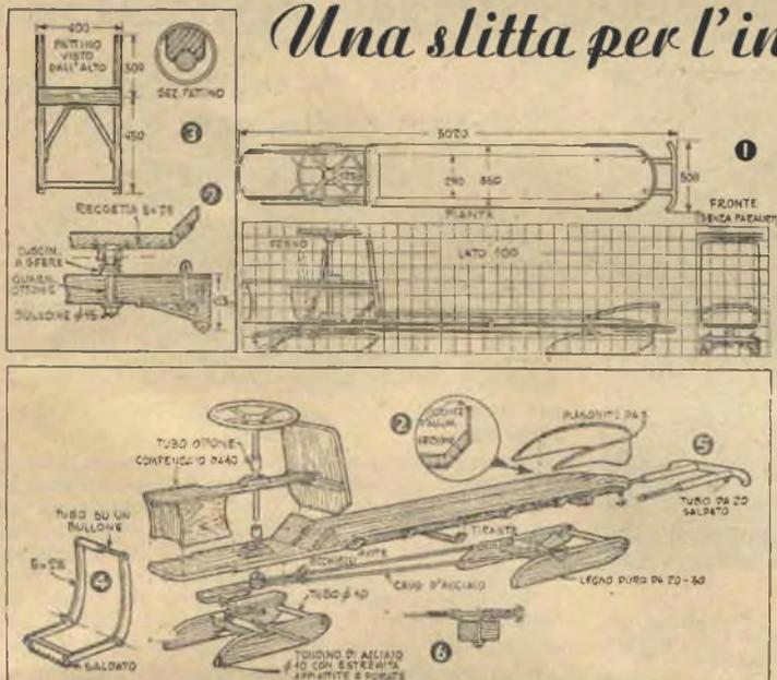
**Q**uesto BoB ha una particolarità: invece di un guidatore, sistemato sul davanti, e di un frenatore a tergo, ha bisogno di un solo guidatore, che, seduto sul sedile sopraelevato posteriore, manovra anche il freno.
