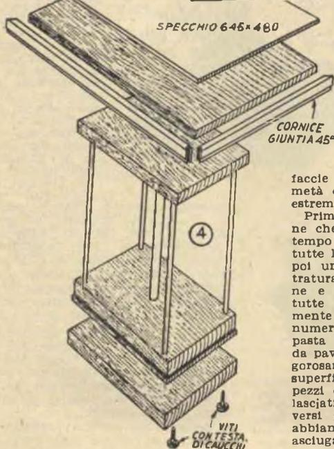
po' delicata: si tratta di fare gli alloggi per le chiavi destinate a rendere più solidi i giunti, alloggi che consistono in un taglio eseguito con il saracco sino alla profondità di mm. 3 perpendicolarmente alle facce inclinate a  $45^\circ$  ed a metà della distanza tra gli estremi delle facce stesse.
