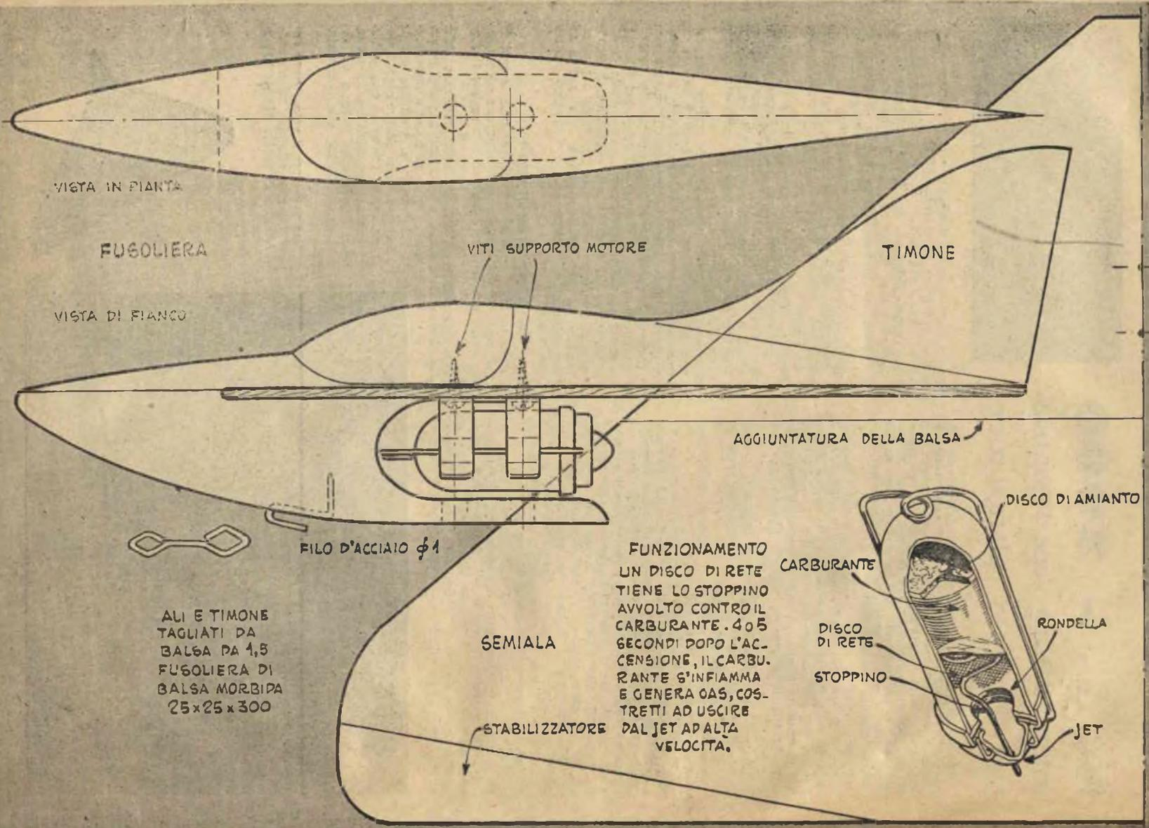
1. Usa per la fusoliera la balsa più leggera che troverai. Ambedue le sezioni sono ritagliate da un solo blocco lungo 30 cm. Segna i pezzi tenendoti all'esterno del tracciato e leviga accuratamente.
