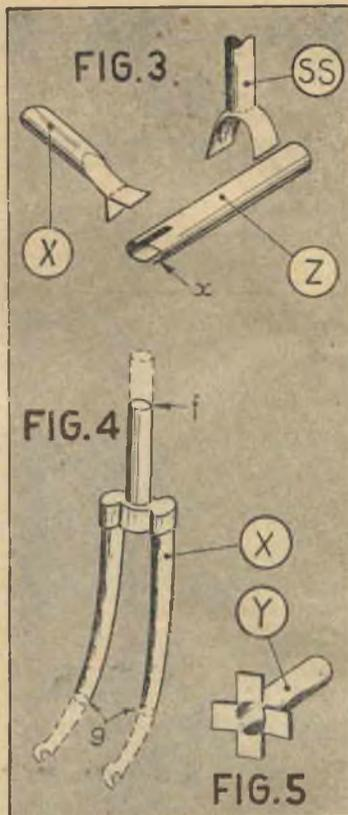
questo tubo di sabbia asciutta, comprimila bene, chiudi l'estremità con un turacciolo, scalda il tubo a cm. 8-10 dal centro della pipa *H* e piega dolcemente in basso fino alla dirittura con la pipa di *X* (fig. 2), poi togli il turacciolo e la sabbia.
