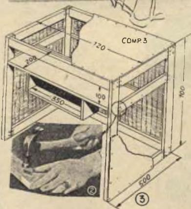
allo scopo una striscia imperniata su di un blocco di legno, come in fig. 5. Segate quindi gli angoli ed arrotondate con la lima, seguendo la linea tracciata. Ricoprite il telaio di compensato, lasciando aperta una sezione su davanti, sistemate in questa i due ripiani, quindi rivestite con il sistema già descritto.
