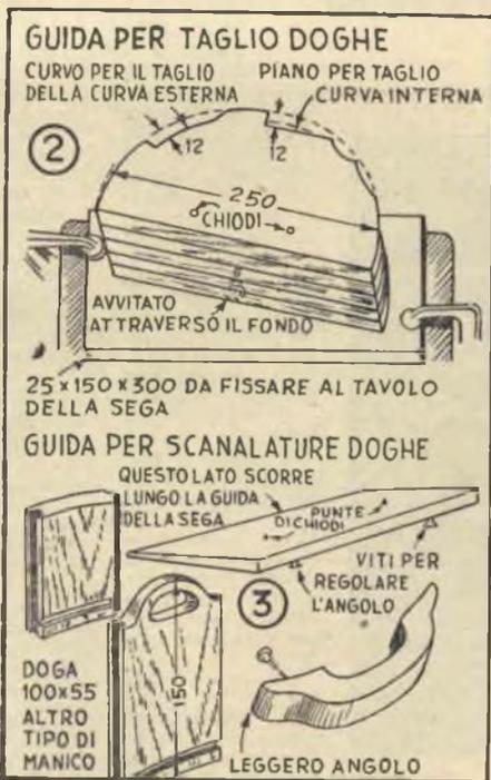
e linguetta, una guida consistente in una tavoletta dalle superfici inclinate è tutto quello che occorre. Il lato più sottile sarà fatto scorrere contro la guida della tompie, due corti viti essendo avvitate sul rovescio al fine di regolare l'inclinazione secondo l'esatto angolo al quale le doghe debbono incontrare il ferro dell'utensile.
