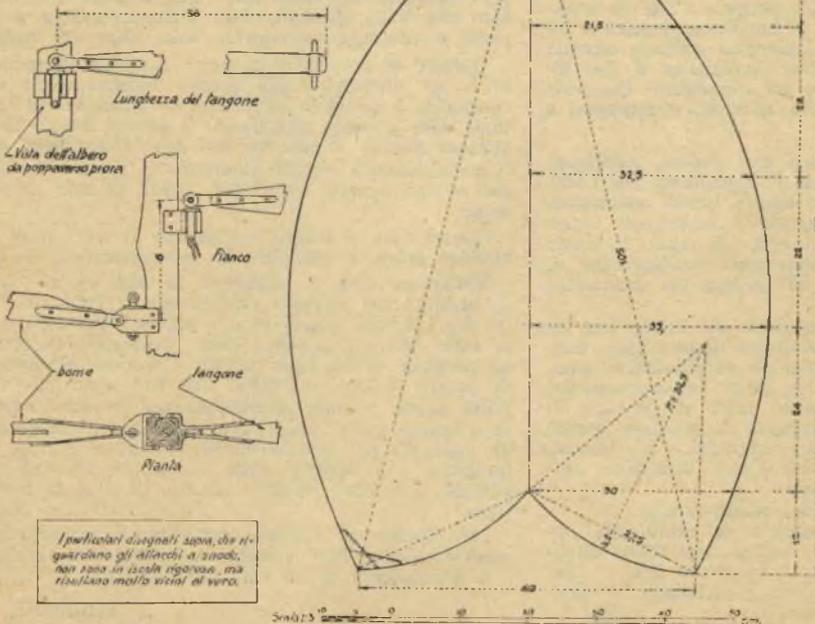
FIG.13-TIMONE AUTOMATICO TIPO BRAINE MODIFICATO - CONGEGGI PER IL FUNZIONAMENTO
