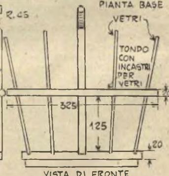
**Q**uesto porta riviste con le sue fiancate ed i suoi divisori di legno è quello che ci vuole per una stanza di soggiorno di gusto moderno. La doppia base, ed il divisorio centrale, cui è fissato il manico, sono fatti di legno di 2 cm. di spessore, la base essendo scanalata per il bordo inferiore dei cristalli. Due tondini, nei quali sono
