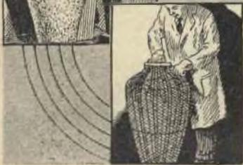
un telaio interno di costole coperte di rete metallica, del tipo usato per le moscaliole (fig. 1), sulla quale sono spalmati tre strati successivi di cemento.
