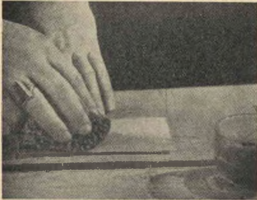
Fig. 6 - Una certa esperienza è necessaria per inumidire il cuoio quanto basta perché riceva l'impressione e la «trattenga», cosa che non avviene quando è bagnato eccessivamente.
