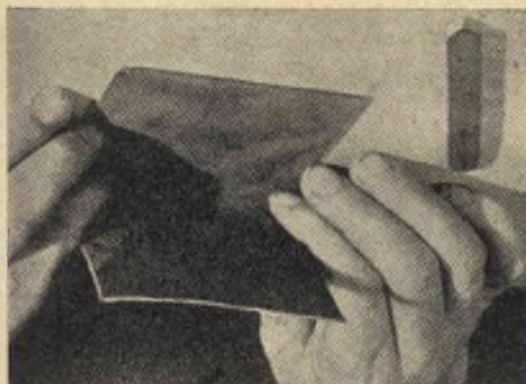
Fig. 27 - Quindi i due pezzi uniti verranno piegati e ripiegati in ogni senso, affinché la fodera si adatti bene e non si muova in seguito.
