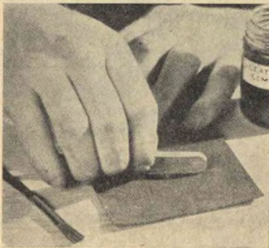
Fig. 26 - Una volta poggiata la fodera sulla superficie del pezzo lavorato già spalmata di cemento, occorre lisciarla in tutte le direzioni con una stecca di legno allo scopo di stenderla bene sul cuoio sottostante e di eliminare rughe e bolle d'aria.
