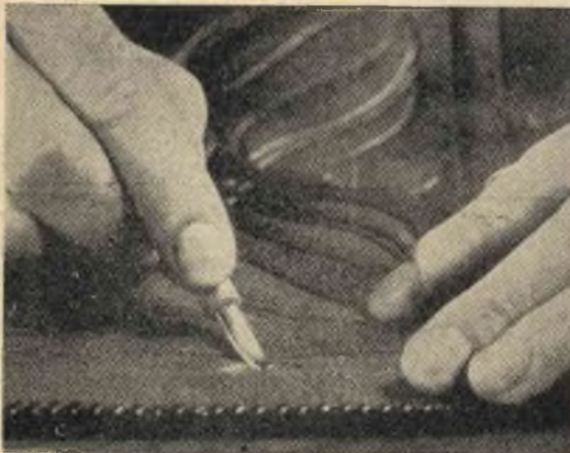
Fig. 52 - Con il brunitolo si eliminano molti difetti.
