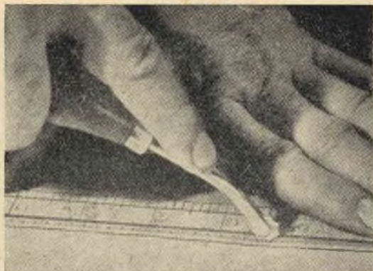
Fig. 30 - Come si usa la ruota per marcare il centro dei fori dell'allacciatura. La ruota viene usata quando i fori sono a piccola distanza l'uno dall'altro.
