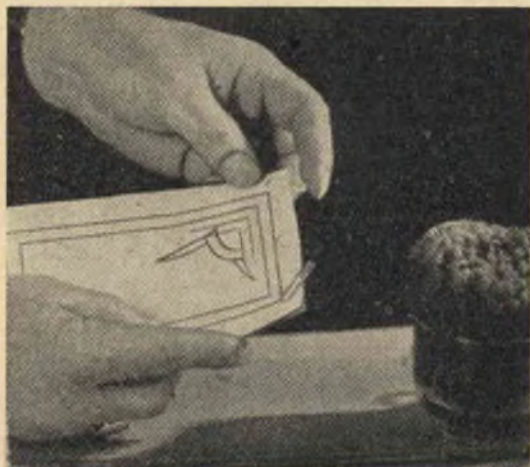
Fig. 21 - Come si fissa il disegno al cuoio.
