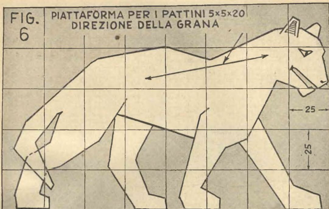
LA TIGRE — Per questo giocattolo, da ritagliare in un sol pezzo, è prevista una base munita di pattini, da fare secondo le indicazioni di fig. 5.
