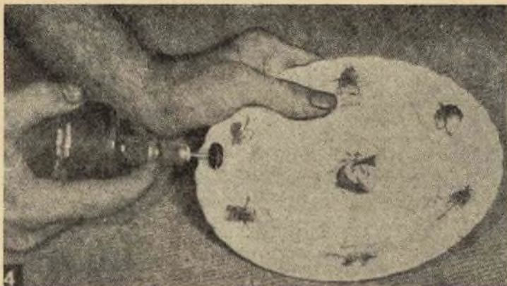
Una passatina leggera con lo smeriglio rende il giunto meno visibile, asportando il cemento spremuto fuori dal giunto
